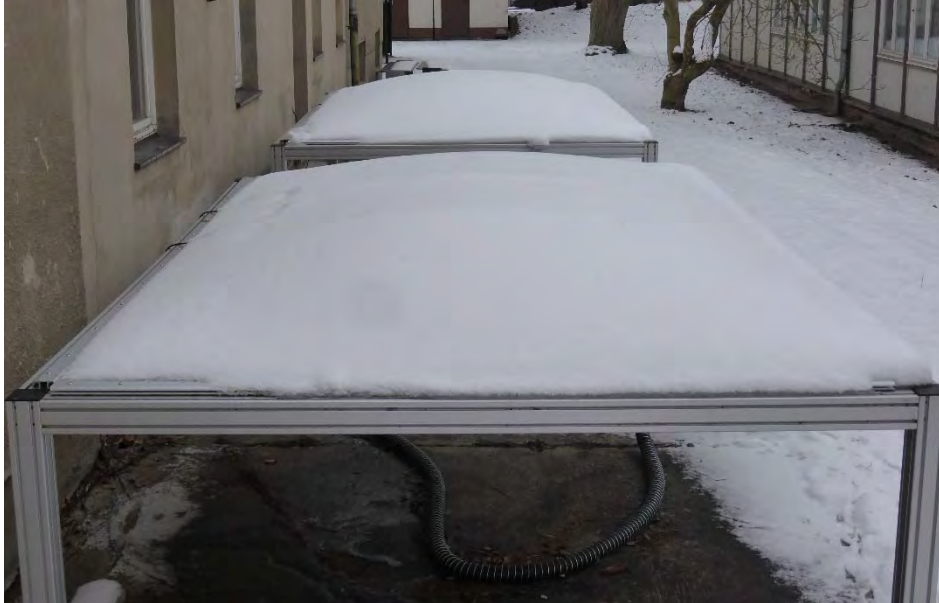
Bild 18 ETFE-Kissen-Prototypen mit vollständiger Schneebedeckung.
