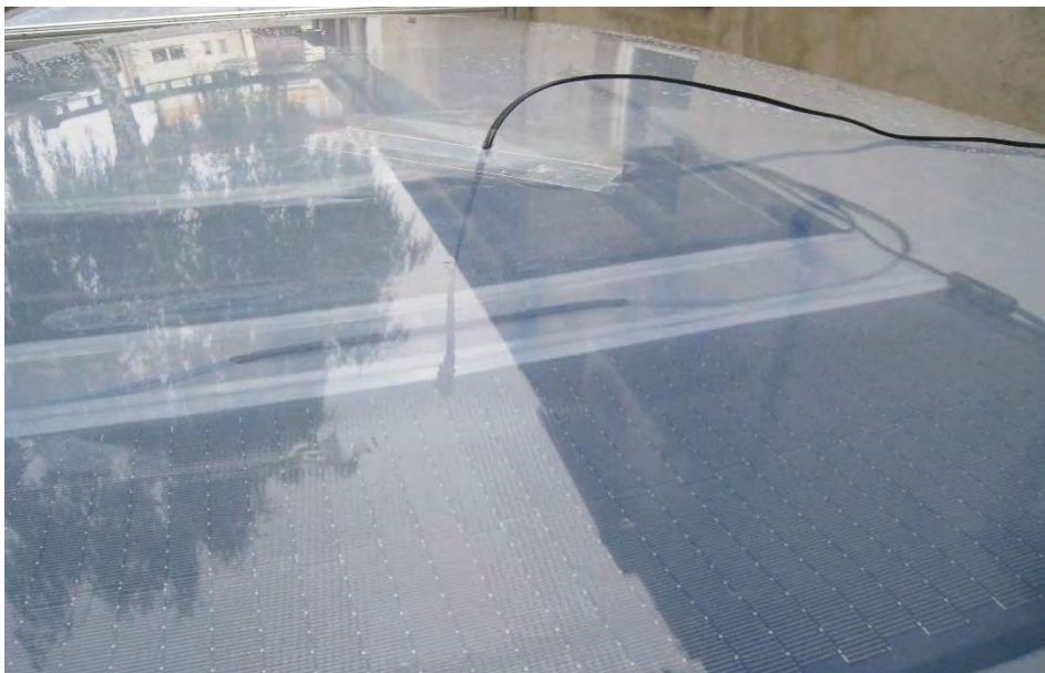
Bild 14 Lage des Temperatur- und Luftfeuchtesensors im ETFE-Kissen-Prototyp mit innenliegenden PV-Modulen in der oberen Kissenkammer.
