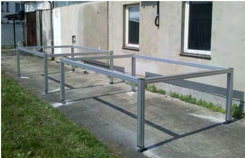
Bild 10 Unterkonstruktionen zur Befestigung der ETFE-Kissen-Prototypen.
