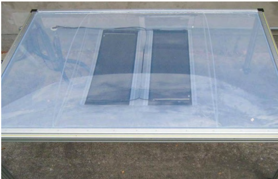
Bild 12 ETFE-Kissen-Prototyp mit innenliegenden PV-Modulen.
