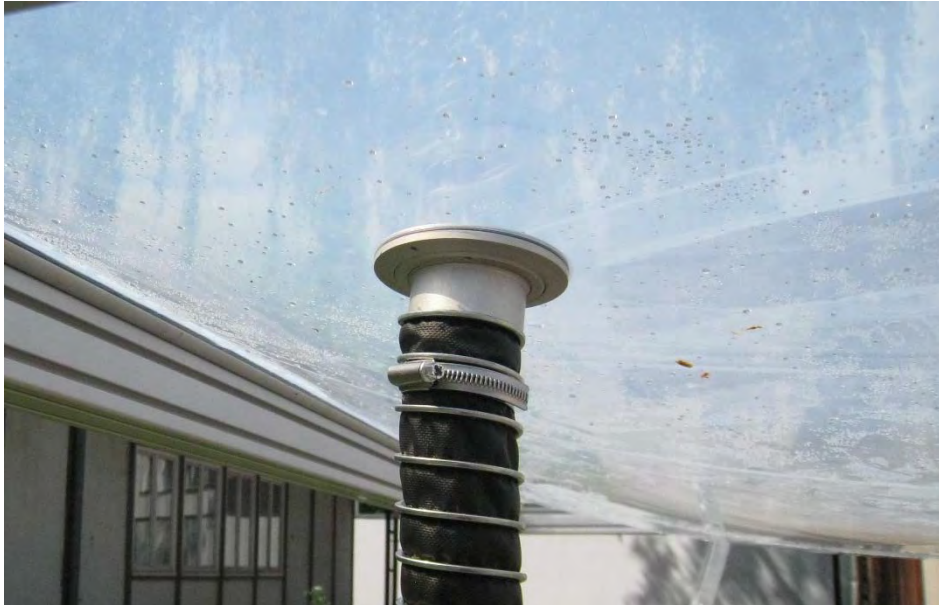
Bild 44 Einlassventil für die Luftzuführung durch die untere ETFE-Lage eines ETFE-Kissen-Prototyps.
