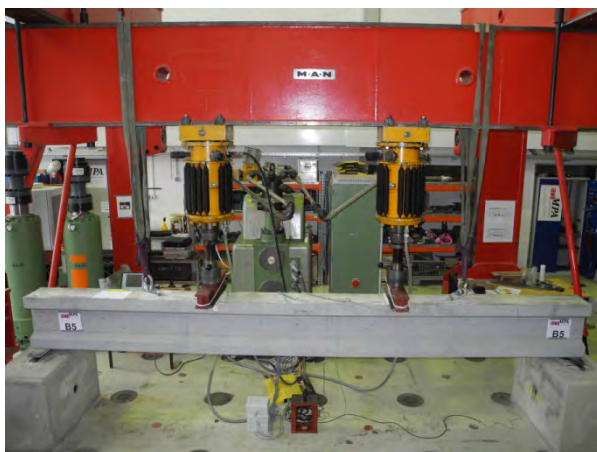
Bild 4-2 Aufbau und Prinzipskizze des Versuchsstands (Versuchsträger B5)
