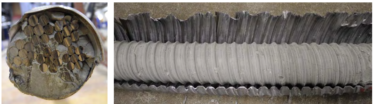
Bild B-8: Lage der Litzen im Hüllrohr (links) und Auftrennen des Hüllrohrs (rechts)
