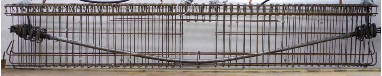
Bild B-1: Bewehrungskorb B1 bis B3 (Hüllrohrradius 4,70 m)
