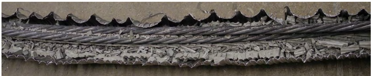
Bild 3-7: Verdrillung der Litzen untereinander im Hüllrohr (hier: Versuchsträger B4)
