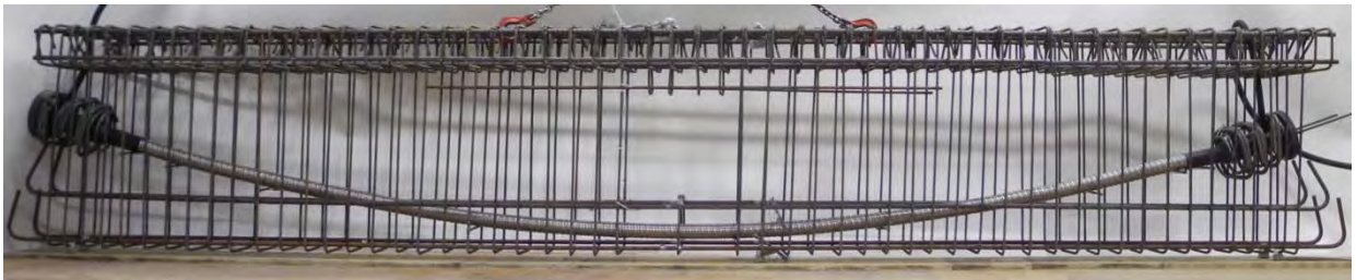
Bild B-2: Bewehrungskorb B4 (Hüllrohrradius 9,40 m)
