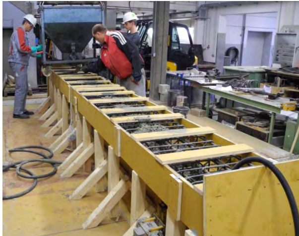
Bild B-4: Betonage (links) und Nachbehandlung (rechts)
