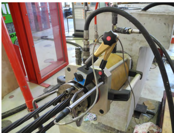
Bild B-6: Aufbringen der Vorspannung
