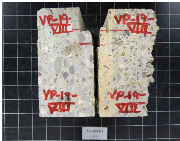
Bild 5.14: Partielle Überdosierung des Beschleunigers in den ersten Zentimetern der Ergänzungsschicht
