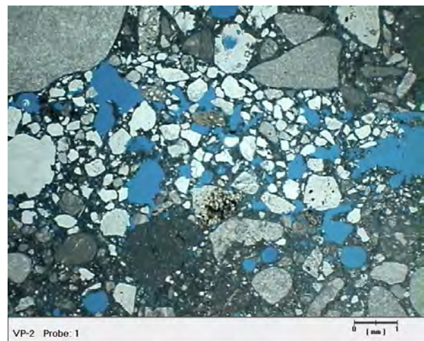
(b) starker durchgängiger Porenhorizont in der Verbundzone von VP-2
