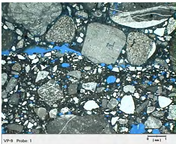
(a) leichter durchgängiger Porenhorizont in der Verbundzone von VP-9
