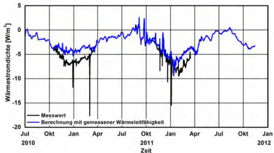
Bild 46: Zeitlicher Verlauf der Wärmestromdichte durch das Material A während des Berechnungszeitraumes im Vergleich zu den Messwerten.
