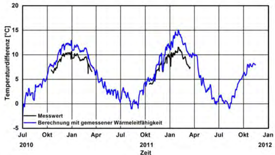
Bild 47: Zeitlicher Verlauf der Temperaturdifferenzen an dem Material A während des Berechnungszeitraumes im Vergleich zu den Messwerten.
