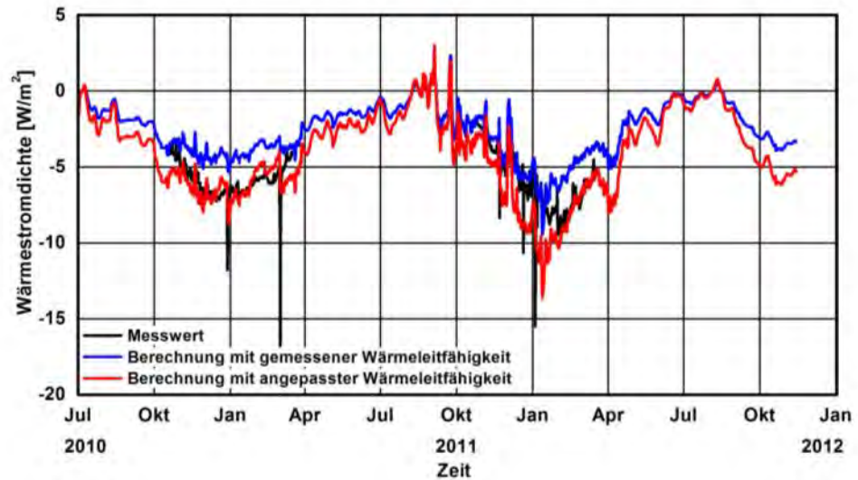
Bild 50: Zeitlicher Verlauf der Wärmestromdichte durch das Material A während des Berechnungszeitraumes im Vergleich zu den Messwerten; Berechnungen mit gemessener und angepasster feuchteabhängiger Wärmeleitfähigkeit.
