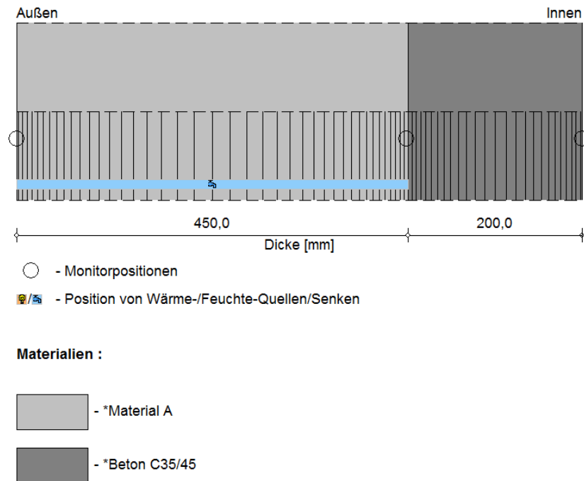
Bild 41: Schematischer Wandaufbau der Kellerwand mit Perimeterdämmung des Materials A in 1 m Tiefe.
