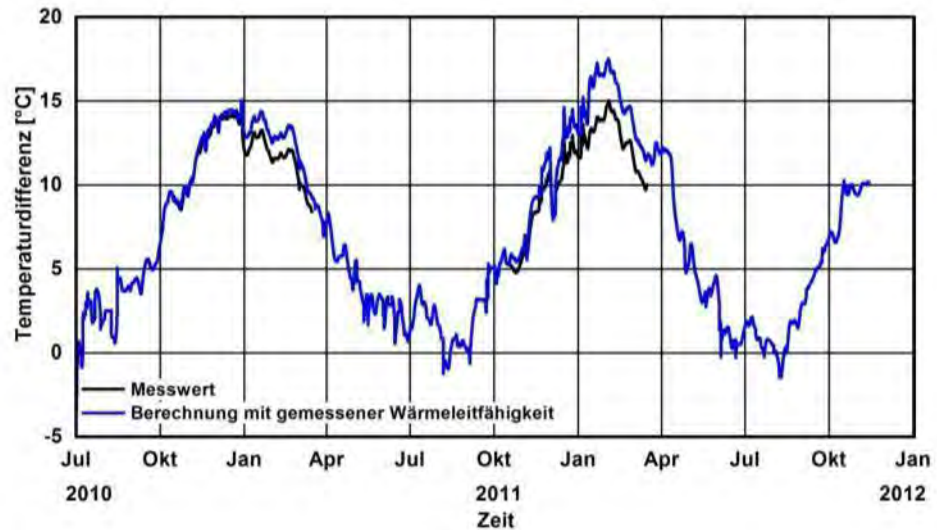
Bild 49: Zeitlicher Verlauf der Temperaturdifferenzen an dem Material B während des Berechnungszeitraumes im Vergleich zu den Messwerten.
