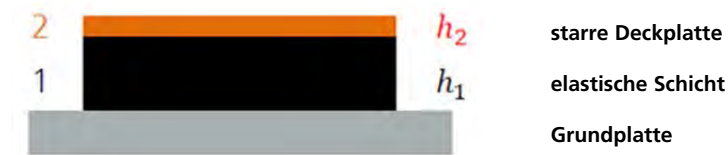
Bild 3: Aufbau eines Resonators im Modell von Stepanov (aus [3]).
