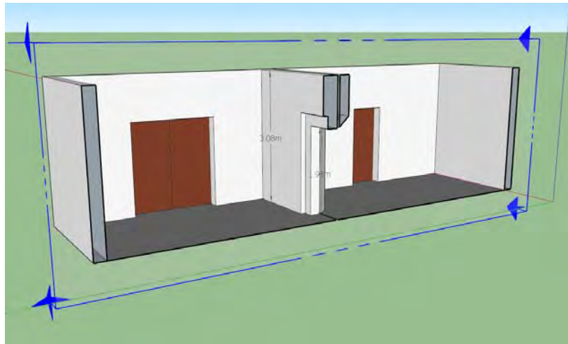
Bild 54: Skizze des Türprüfstands. Links Raum P9B, rechts Raum P10B (im Folgenden kurz als P9 und P10 bezeichnet)
