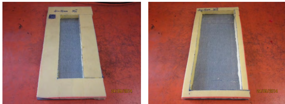
Bild 30: Resonatoren mit 1.5 mm dickem Stahlblech (von "hinten" betrachtet), bei denen der innere Teil der 12.5 mm dicken Sylomerschicht durch Luft ersetzt ist. Links "HR30", d. h. dass 30% der Schicht besteht aus Luft; rechts "HR70".
