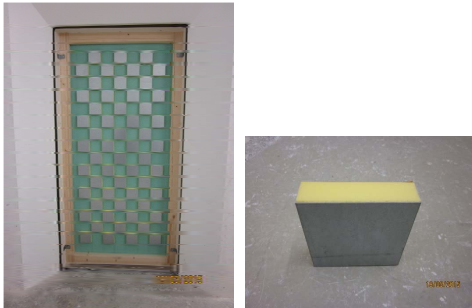
Bild 60: GKFI-Platte mit 56 Resonatoren von P10 aus gesehen (links) und Resonator (25 mm Sylomer gelb, 1.5 mm Stahl, Kantenlänge 10 cm)
