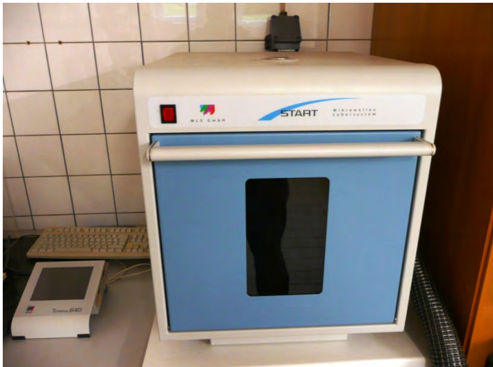
Abb. 7: EDV-gesteuerter MLS Mikrowellenofen \mu PREP-A.
