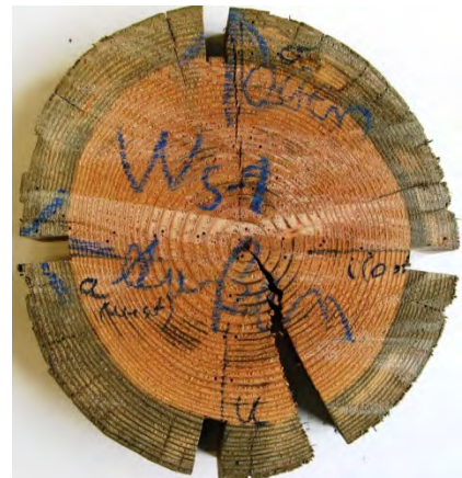
Abb. 3: Riesenhühlturm (Pfeil zeigt auf einen der ausgetauschten Querriegel) sowie die Stammscheibengewinnung aus den Querriegeln (rechtes Bild).
