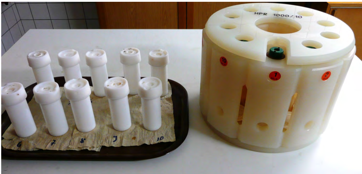
Abb. 6 Aufschlussgefäße und Mikrowellenaufschlussblock.
