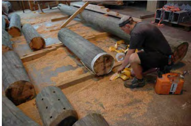
Abb. 3: Riesenhühlturm (Pfeil zeigt auf einen der ausgetauschten Querriegel) sowie die Stammscheibengewinnung aus den Querriegeln (rechtes Bild).
