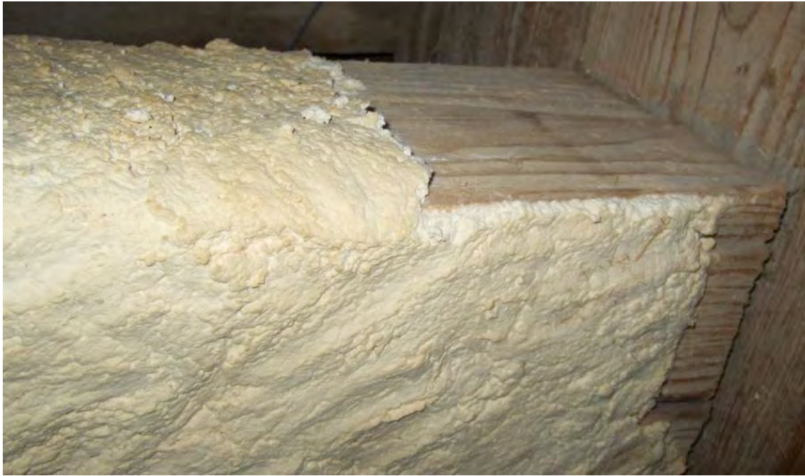
Abb. 6 Komprese, oben rechts Holzoberfläche nach Abnahme, 3 Monate nach der Anbringung
