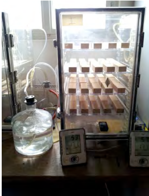
Abb. 7 Der Prüfaufbau zur Erzeugung der hygrischen Wechselbeanspruchung entspricht dem Prüfaufbau zur Untersuchung der Sorptionseigenschaften
