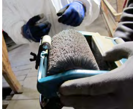
Abb. 3 Bürstenschleifer mit Kunststoffbürste
