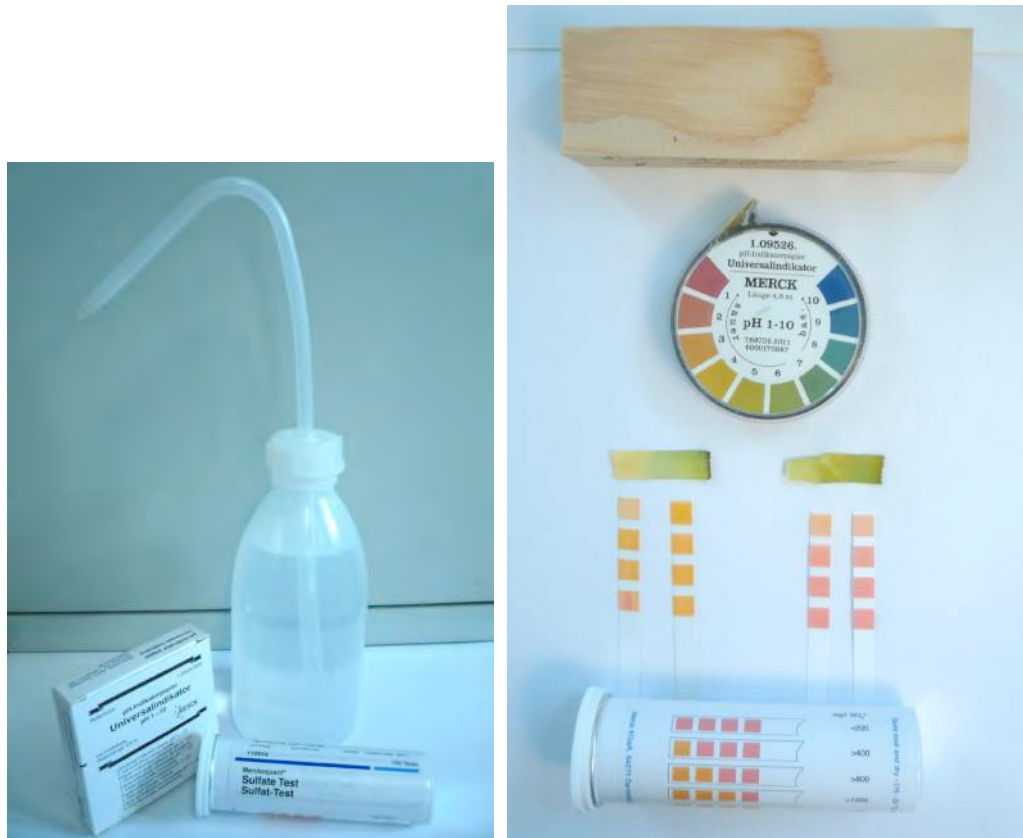
Abb. 13 (links) Testkit für die Sulfatbestimmung
