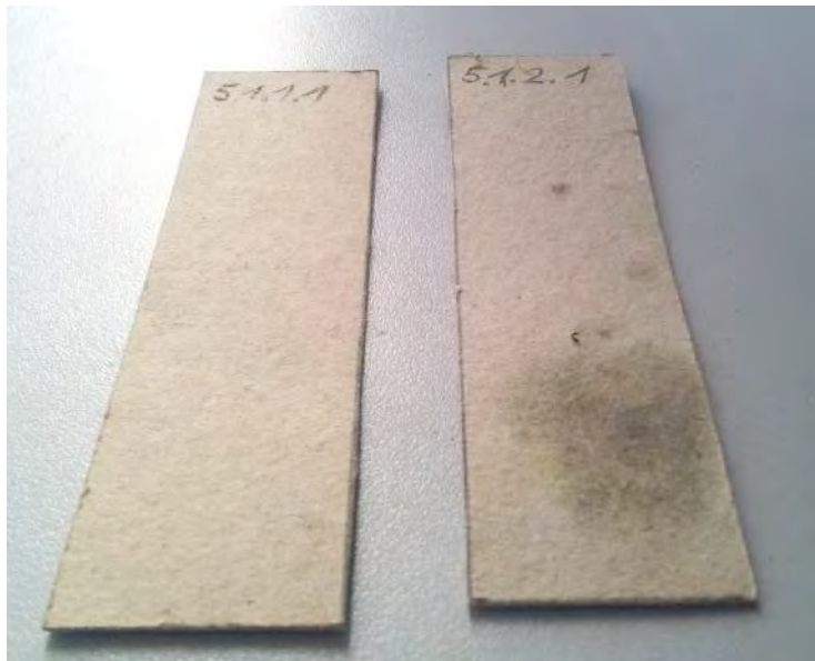
Abb. 9 In Feuerschutzsalz getränkte Pappstreifen nach 30 Wechsellagerungszyklen
