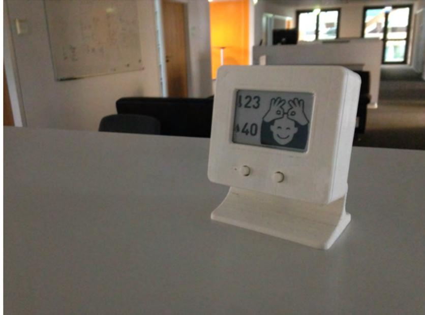
Abbildung 11 Die Anzeigeeinheit für Temperatur und Luftfeuchte. Bei der Konzeption wurde auf ein auch aus der Ferne gut ablesbares Display geachtet.
