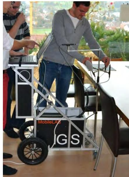
Abbildung 96: MobileLAB – mobile Messstation zur Analyse der thermischen Behaglichkeit
