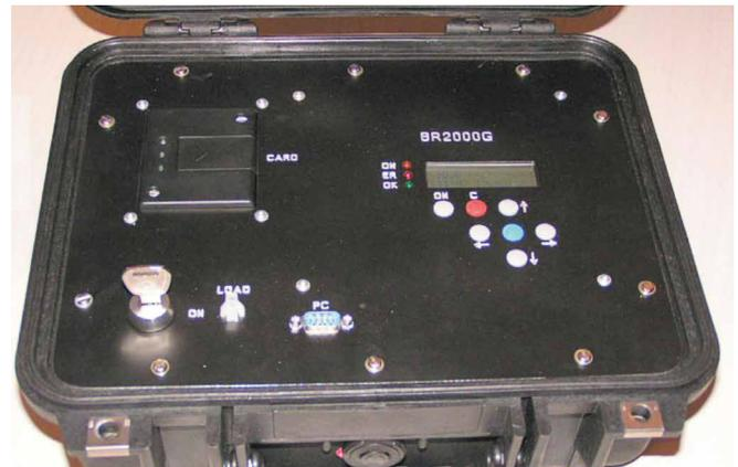
Abb. 15: Betonrechner BR 2000 [IEB]
