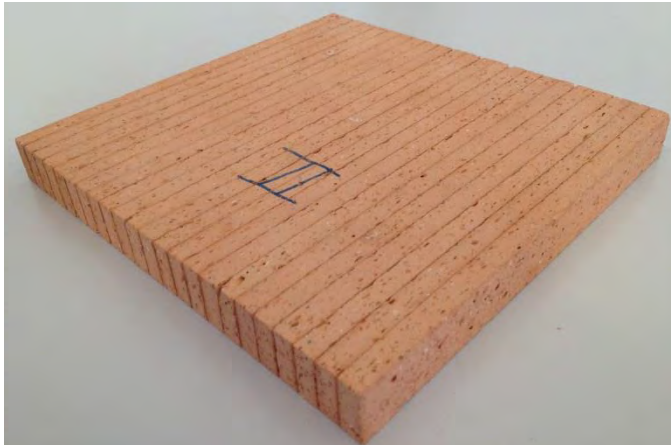
Abbildung 5: Probenplatte aus plangefrästen Streifen der Querstege eines Hochlochziegels zur Messung der Wärmeleitfähigkeit in Querstegrichtung
