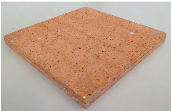
Abbildung 6: Probenplatte aus den Innen-Längsstegen des luftgefüllten Hochlochziegels mit zwei übereinander angeordneten plangefrästen Platten - getrennt durch eine dünne PE-Folie
