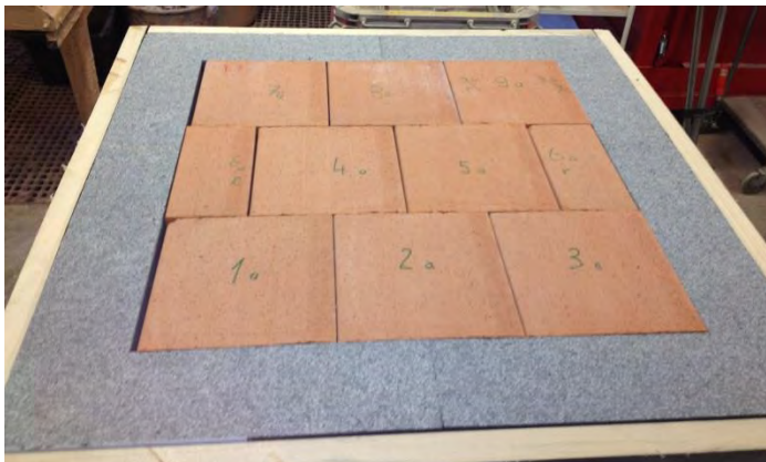
Abbildung 9: Halbsteinprobekörper aus plangefrästen Ziegeln in einem Einbaurahmen aus Dämmstoff mit zusätzlichem Holzrahmen zur Verspannung
