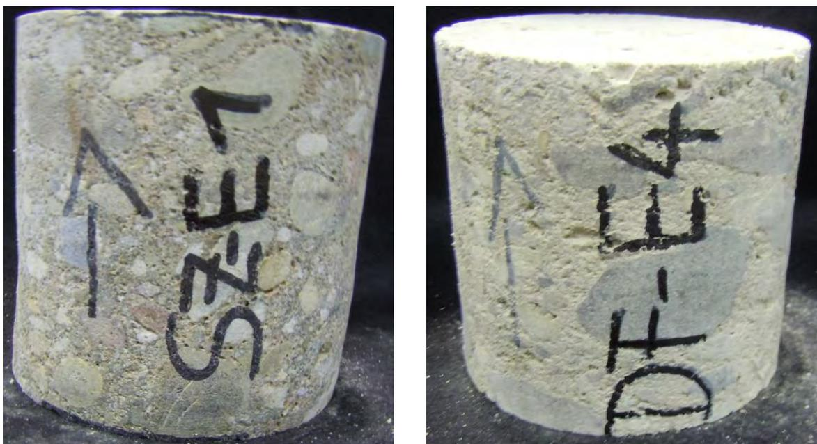
Abb. 4-58 Bohrkern Lautertalbrücke – Kaiserslautern
