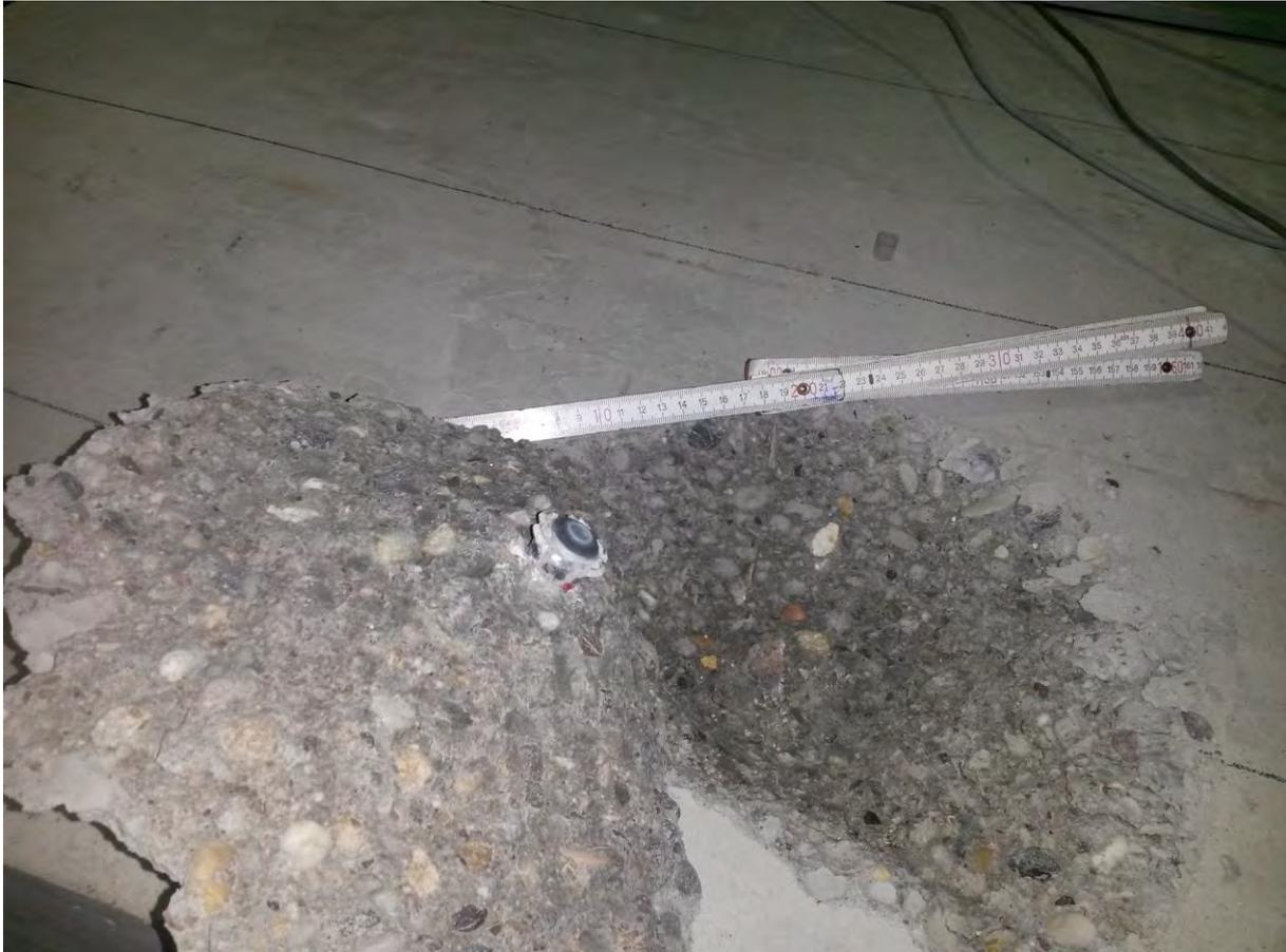
Abb. 6-21 Versagensbild Hinterschnittanker HDA-P, ungerissen
