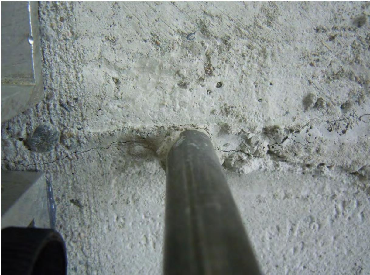
Abb. 6-17 Versuchsplatte Kopfbolzen in gerissenem Beton – Rissverlauf
