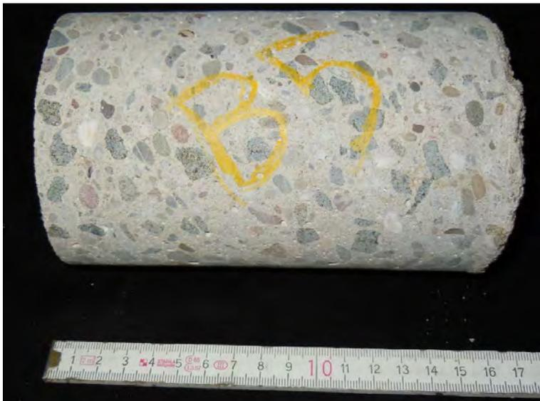
Abb. 4-38 Bohrkern Bodenplatte ACO Gusswerk – Kaiserslautern
