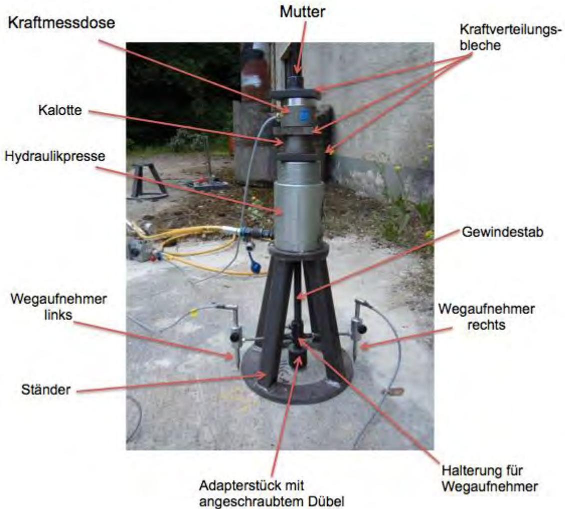
Abb. 6-4 Versuchsaufbau
