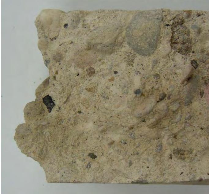
Abb. 4-3 Bruchfläche Bohrkern Sulzbach
