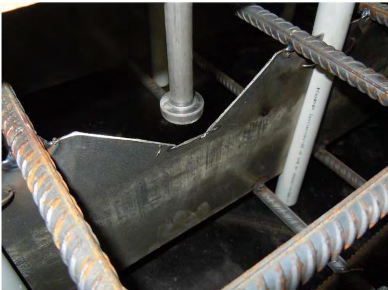
Abb. 6-16 Versuchsplatte Kopfbolzen in gerissenem Beton – Ausführung Rissblech
