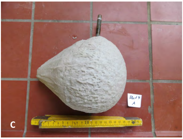
Abbildung: Sicht auf freigelegten (A) und ausgebauten Prüfkörper (B, C). Die Oberfläche ist im Vergleich zu Flut 1 – 3 im unteren Bereich rauer.
