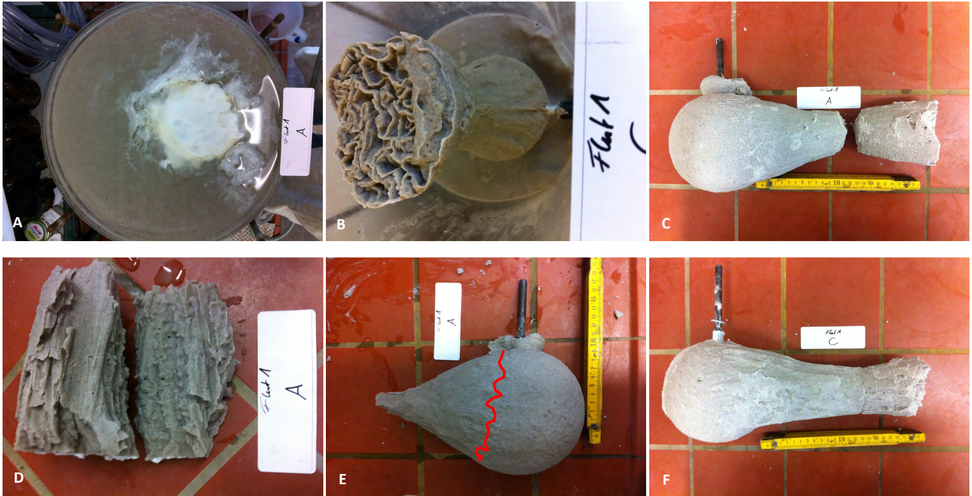
Abbildung: Typische Prüfkörperformen vor Ausbau (A), beim Ausbau (B) und nach dem Ausbau (C-F). Im oberen Verlauf bildet das Bauprodukt eine feine kristalline Form (A, B) die beim Ausbau sehr schnell zerstört werden kann (D). Alle gebildeten Prüfkörper zeigten dieselben Ausbildungen. Die Form in C und F zeigt die aufgesetzte ‚Haube‘ und den Kern des Prüfkörpers (E) nach Ausbau. Die Haube zerfällt bei Austrocknung und ist im nassen Zustand ebenfalls leicht zu entfernen. Der Kern (E) ist fester und stabiler. Der Ansatz der ‚Haube‘ ist deutlich erkennbar (rote Linie in E).
