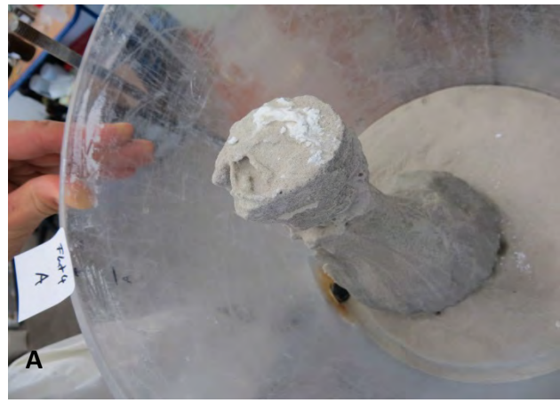
Abbildung: Sicht auf freigelegten (A) und ausgebauten Prüfkörper (B, C). Die Oberfläche ist im Vergleich zu Flut 1 – 3 im unteren Bereich rauer.
