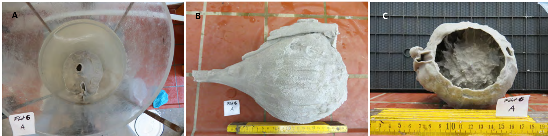
Abbildung: Sicht auf freigelegten (A) und ausgebauten Prüfkörper (B, C). Der Baukörper ist leicht ausgehöhlt (C).
