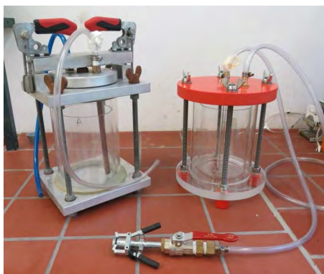
Abbildung 3: Verwendete Windkesselanlage zur Injektion
