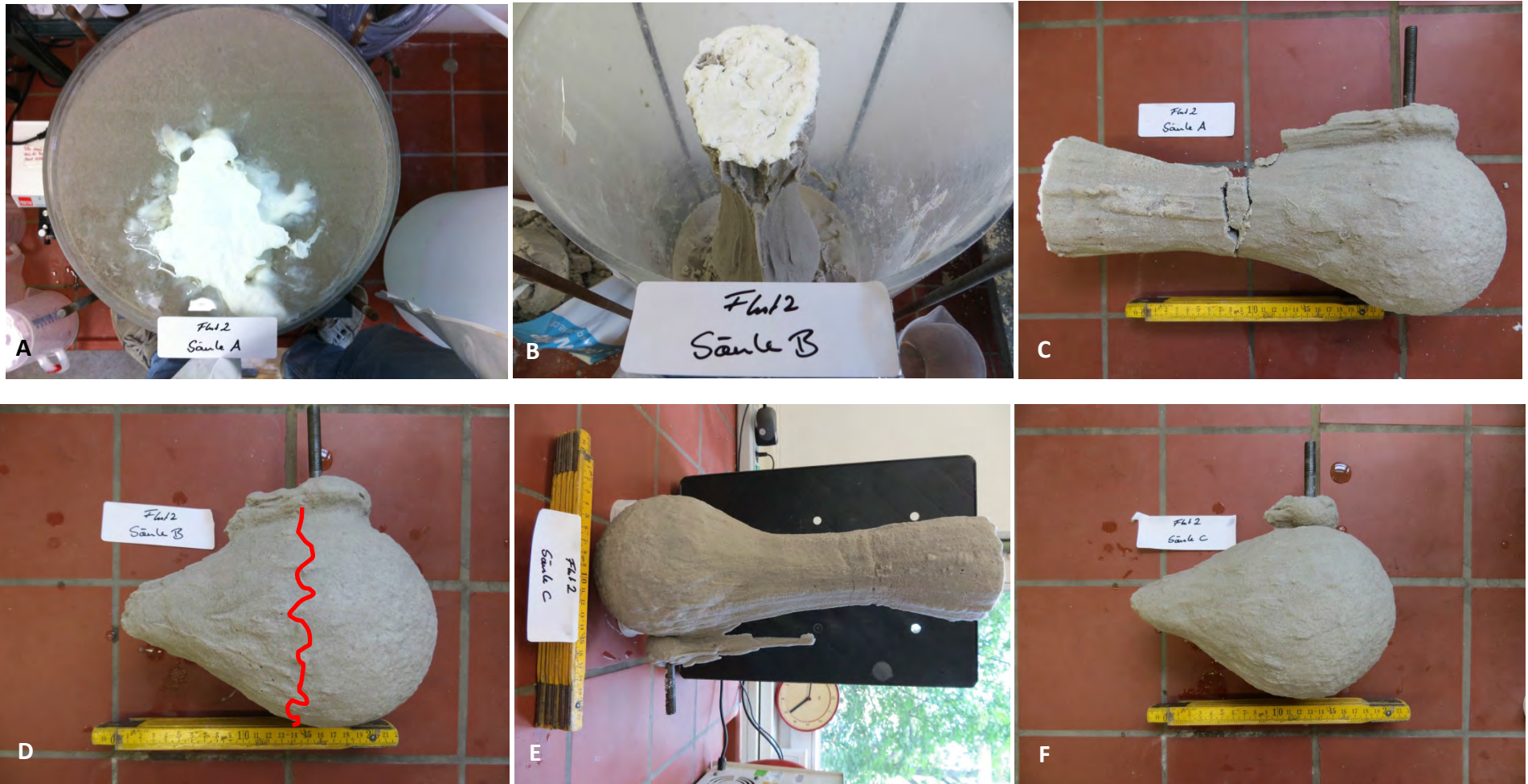
Abbildung: Sicht auf geöffnete Säule von oben (A), beim Ausbau (B) und nach dem Ausbau (C-F). Im oberen Verlauf bildet das Bauprodukt eine feine kristalline Form (A, B) die beim Ausbau sehr schnell zerstört werden kann (D). Alle gebildeten Prüfkörper zeigten dieselben Ausbildungen. Die Form in C (liegend) und E (stehend) zeigt die aufgesetzte ‚Haube‘ und den Kern des Prüfkörpers (D, F) nach Ausbau. Die Haube zerfällt bei Austrocknung und ist im nassen Zustand ebenfalls leicht zu entfernen. Der Kern (D, F) ist fester und stabiler. Der Ansatz der ‚Haube‘ ist deutlich erkennbar (rote Linie in D).
