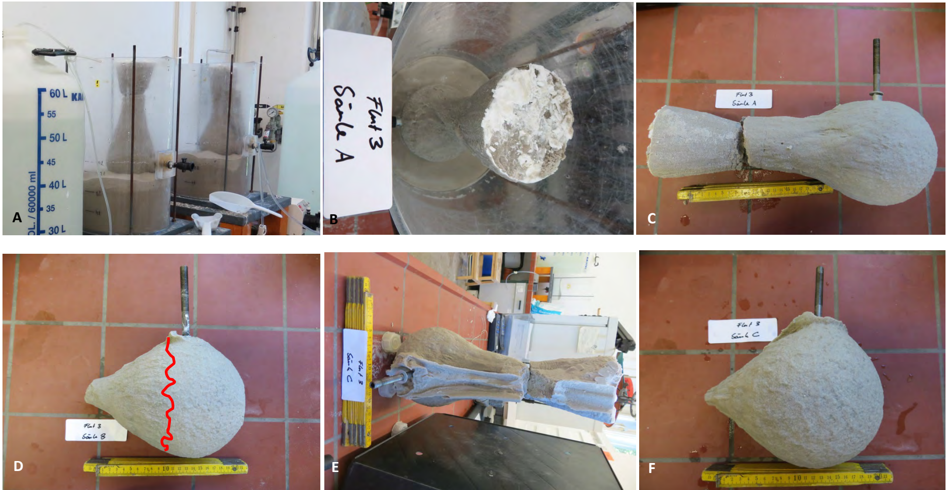
Abbildung: Sicht auf freigelegte Prüfkörper (A, B) und nach dem Ausbau (C-F). Alle gebildeten Prüfkörper zeigten dieselben Ausbildungen. Die Form in C (liegend) und E (stehend) zeigt die aufgesetzte ‚Haube‘ und den Kern des Prüfkörpers (D, F) nach Ausbau. Die Haube zerfällt bei Austrocknung und ist im nassen Zustand ebenfalls leicht zu entfernen. Der Kern (D, F) ist fester und stabiler. Der Ansatz der ‚Haube‘ ist deutlich erkennbar (rote Linie in D).
