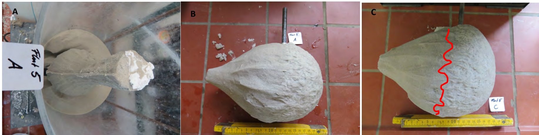
Abbildung: Sicht auf freigelegte Prüfkörper (A) und nach dem Ausbau (B-C). Alle gebildeten Prüfkörper zeigten dieselben Ausbildungen. B und C Kern des Prüfkörpers nach Ausbau. Die Haube zerfällt bei Austrocknung und ist im nassen Zustand ebenfalls leicht zu entfernen. Der Kern (D, F) ist fester und stabiler. Der Ansatz der ‚Haube‘ ist deutlich erkennbar (rote Linie in C).
