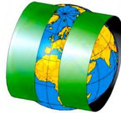
Abb. 4: Transversale Mercator Projektion, schematisch.
