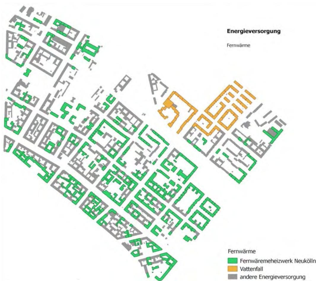
Abbildung 6.4: Gebäude mit Fernwärmeversorgung im Untersuchungsgebiet (DMSW 2015; Büro PFE)
