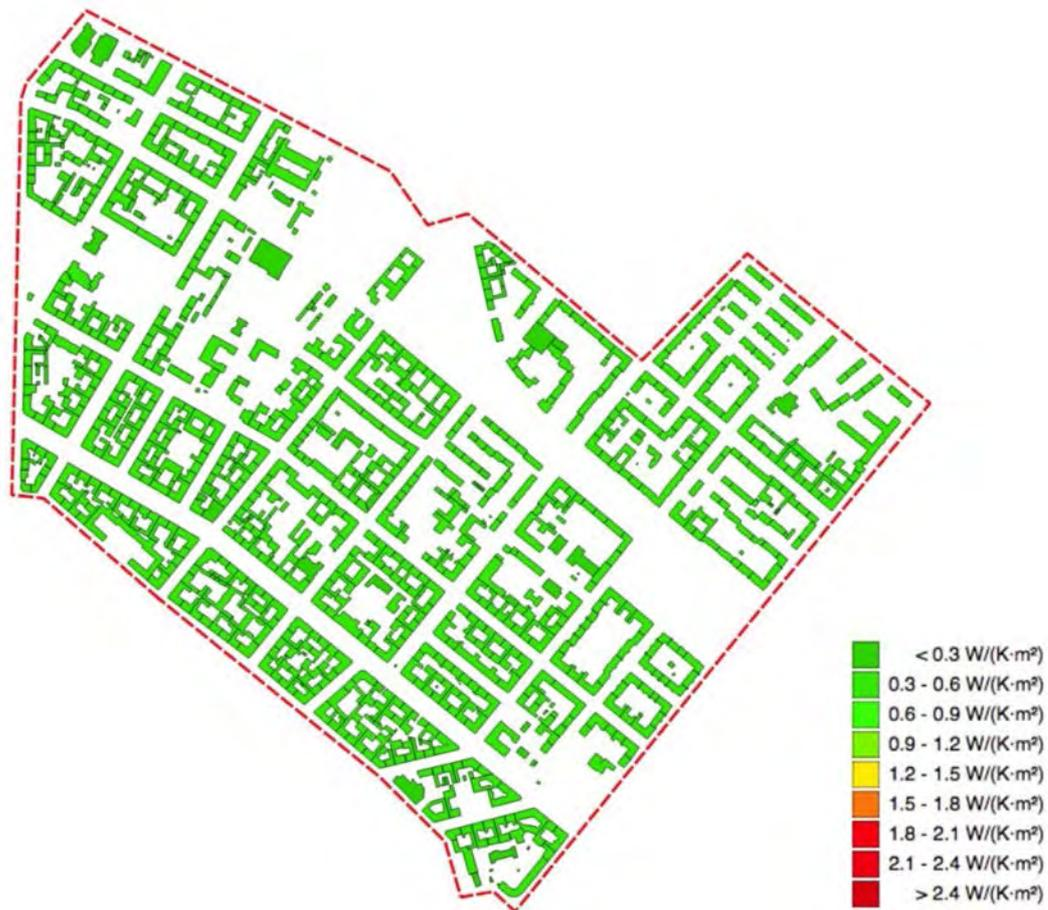
Abbildung 8.7: Mit *Open eQuarter MOLE* berechneter wohnflächenbezogener Transmissionswärmeverlust  $HT'$  für alle Gebäude des Quartiers nach der energetischen Sanierung (VPT 2015)
