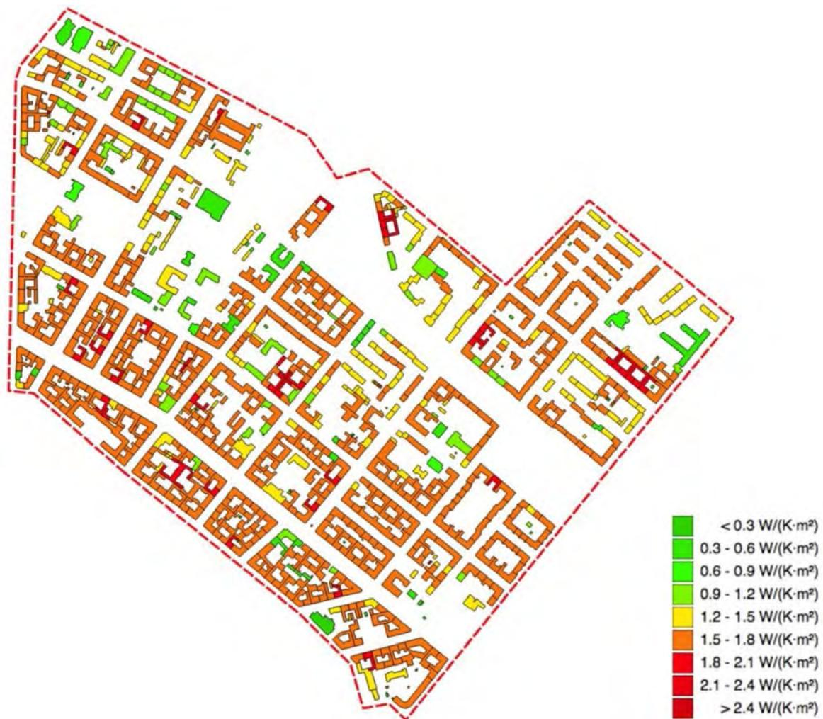
Abbildung 8.6: Mit Open eQuarter MOLE berechneter wohnflächenbezogener Transmissionswärmeverlust  $HT'$  für alle Gebäude des Quartiers vor der energetischen Sanierung (VPT 2015)
