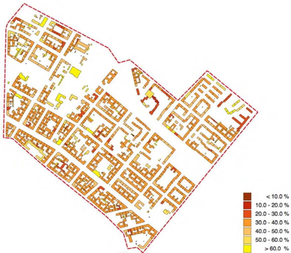
Abbildung 8.10: Mit *Open eQuarter MOLE* berechnete erreichbare solare Deckungsrate je Gebäude bei flächendeckender Nutzung von Solarthermie (VPT 2015)
