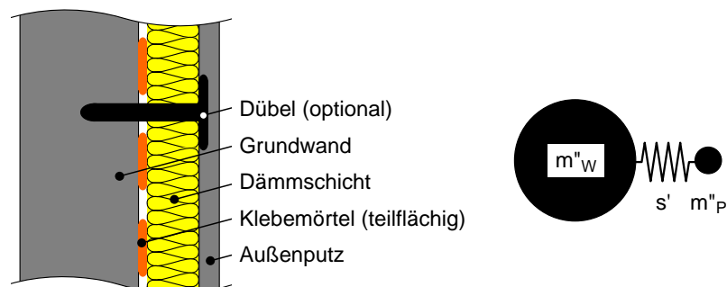
Abb. 1: Aufbau und akustisches Modell (Masse-Feder-Masse-System) eines einlagigen WDVS. Hierbei bezeichnen m''_w die flächenbezogene Masse der
