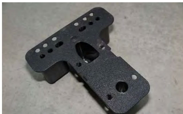
Abb. 81 Profilierte Unterseite des Stützenfußes
