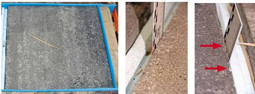
Abb. 13 a+b+c: feine Kantenausbrüche an extrem scharfkantigen Betonplatten
