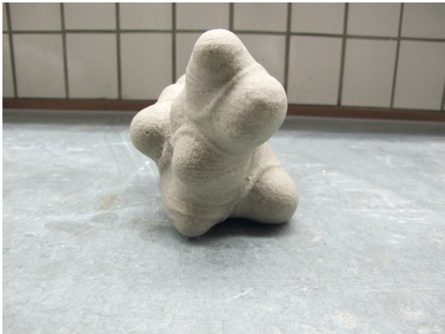
Bild 33: Probekörper, der bei der Injektion von Harz A mit der kurzen Mischkammer entstand. Blickrichtung: zum Injektionsrohr.
