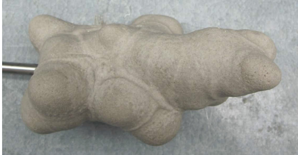
Bild 24: Probekörper, der bei der Injektion von Harz A mit der kurzen Mischkammer entstand.
