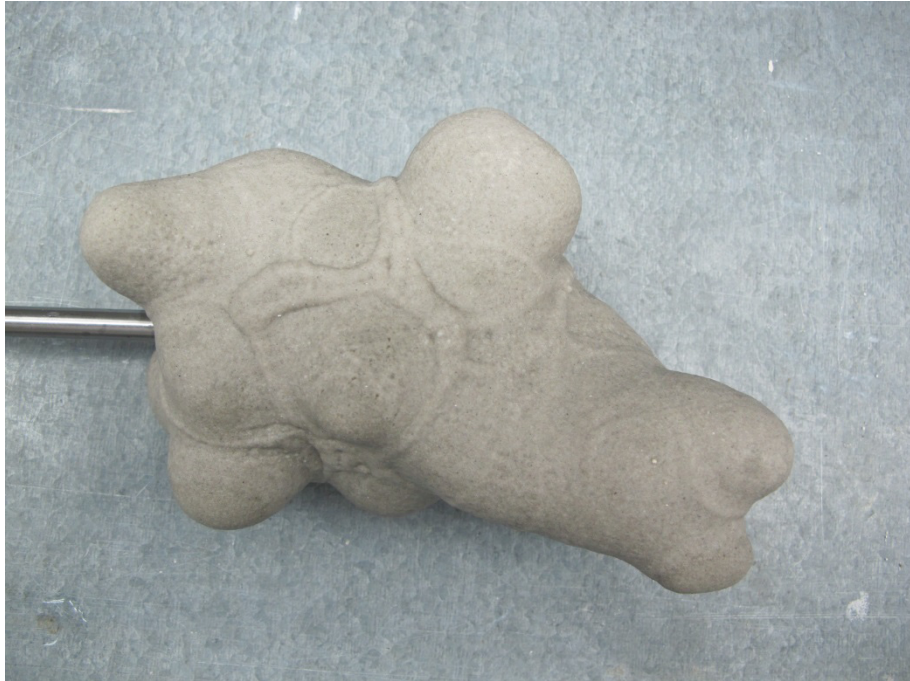
Bild 32: Probekörper, der bei der Injektion von Harz A mit der kurzen Mischkammer entstand. Blickrichtung: von oben.
