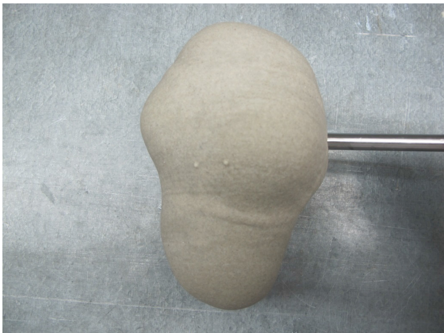
Bild 37: Probekörper, der bei der Injektion von Harz A mit der langen Mischkammer entstand. Blickrichtung: von der Seite.
