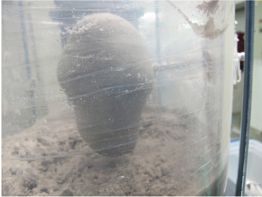
Bild 36: Probekörper, der bei der Injektion von Harz A mit der langen Mischkammer entstand, in der inversen Säule nach der Elution. Blickrichtung: von der Seite.
