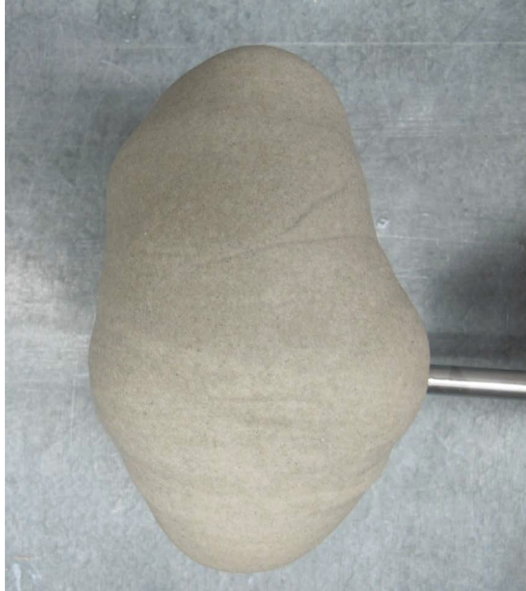
Bild 27: Probekörper, der bei der Injektion von Harz A mit der langen Mischkammer entstand.
