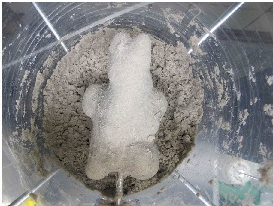
Bild 31: Probekörper, der bei der Injektion von Harz A mit der kurzen Mischkammer entstand, in der inversen Säule nach der Elution. Blickrichtung: von oben.
