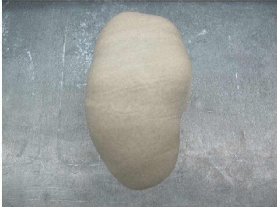
Bild 38: Probekörper, der bei der Injektion von Harz A mit der langen Mischkammer entstand. Blickrichtung: zum Injektionsrohr.
