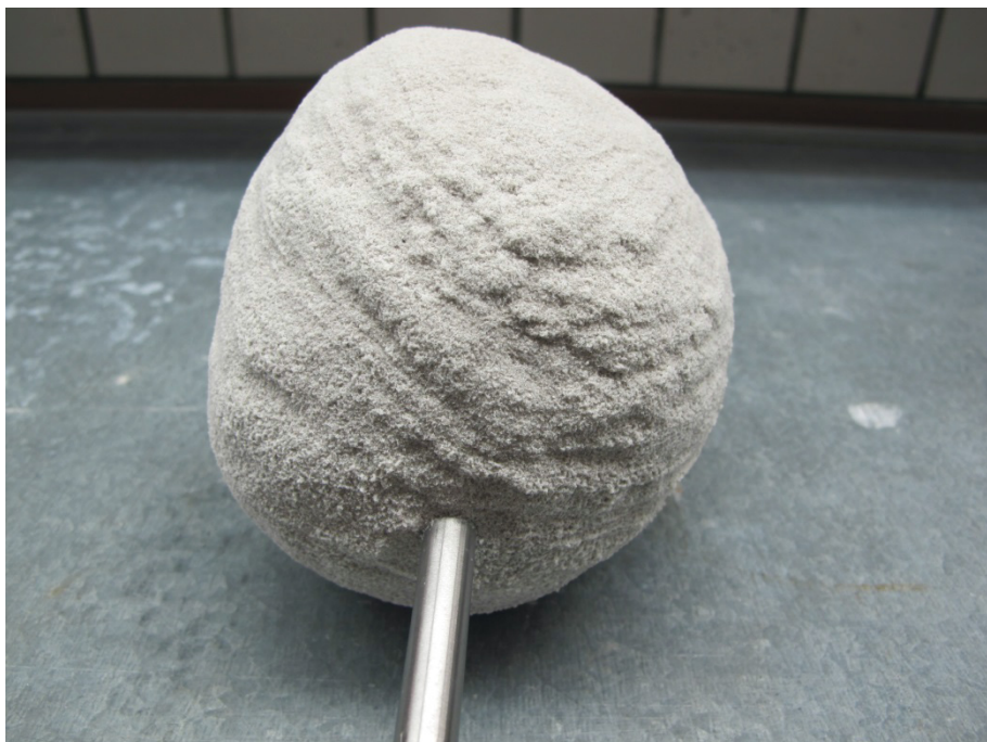
Bild 41: Probekörper, der bei der Injektion von Harz B entstand. Blickrichtung: von schräg unten.
