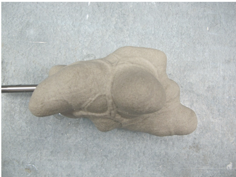
Bild 35: Probekörper, der bei der Injektion von Harz A mit der kurzen Mischkammer entstand. Blickrichtung: von der Seite.
