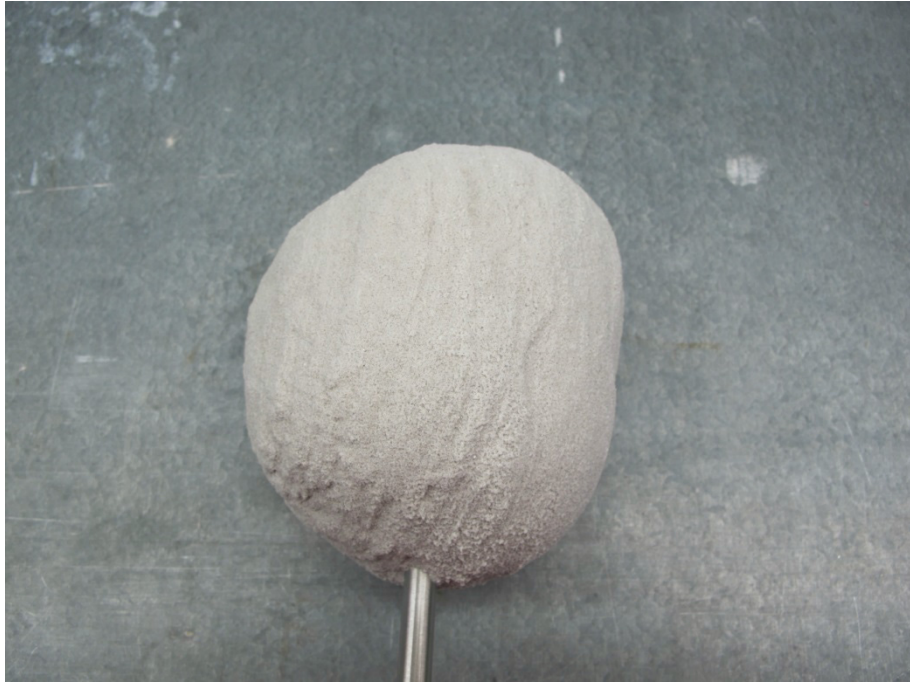
Bild 40: Probekörper, der bei der Injektion von Harz B entstand. Auf der rechten Seite ist die Oberseite, auf der linken die Unterseite zu sehen.
