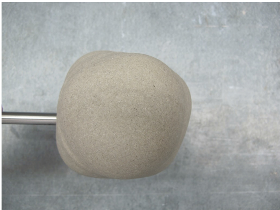
Bild 39: Probekörper, der bei der Injektion von Harz A mit der langen Mischkammer entstand. Blickrichtung: von oben.
