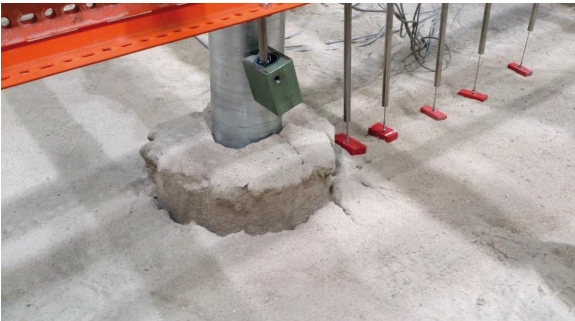
**Abb. 36:** Großaufnahme nach Versagen des Zugversuches
