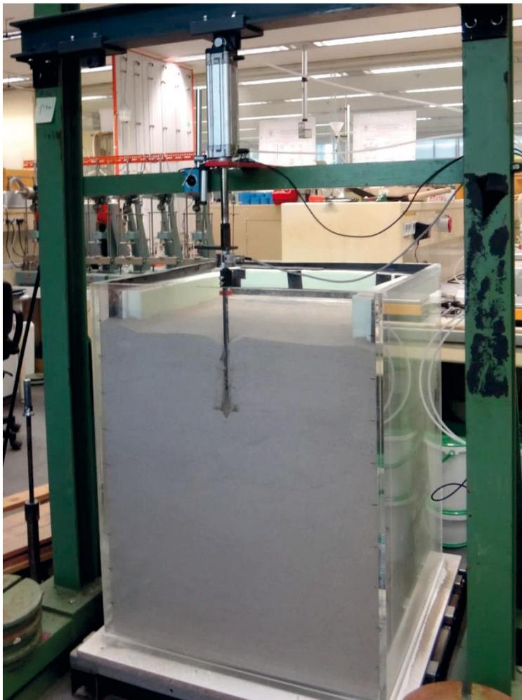
**Abb. 8:** Versuchstand mit eingebautem Modell für PIV-Versuch
