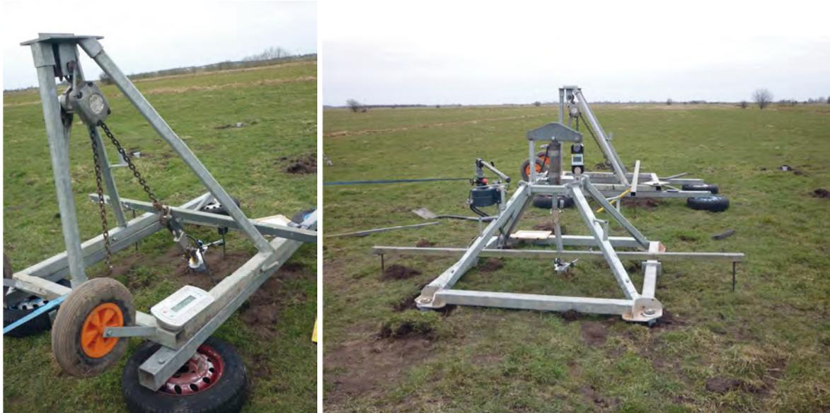
**Abb. 4:** Belastungs- und Messeinrichtungen; links: geneigte Zugversuche, rechts: Druckversuche
