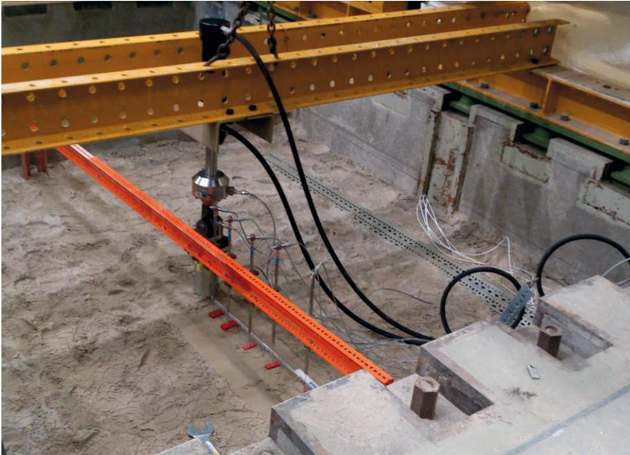
**Abb. 32:** Versuchsgrube, Testfundamente und Belastungseinrichtung im eingebauten Zustand
