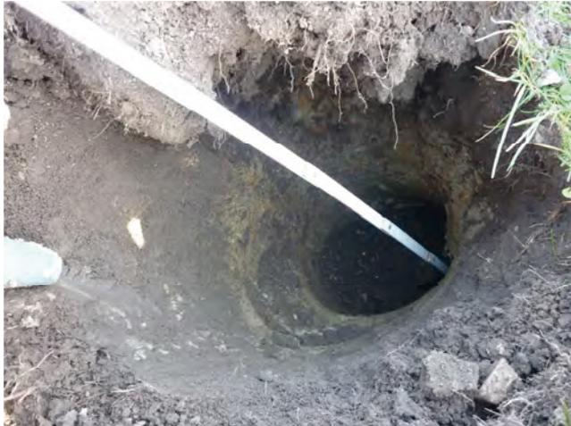
**Abb. 25:** Entstehender Hohlraum nach dem Auszugsversuch
