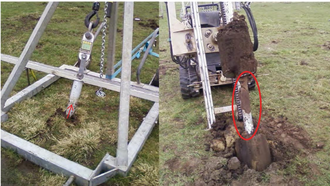
**Abb. 24:** Ausziehen von Schraubfundamenten
