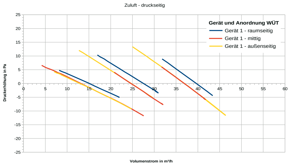
Diagramm 6: Druck-Volumenstrom-Kennlinien der Zuluft von Gerät 1 und unterschiedlichen Anordnungen des Wärmeübertragers, aufgenommen von Prüfstelle 2
