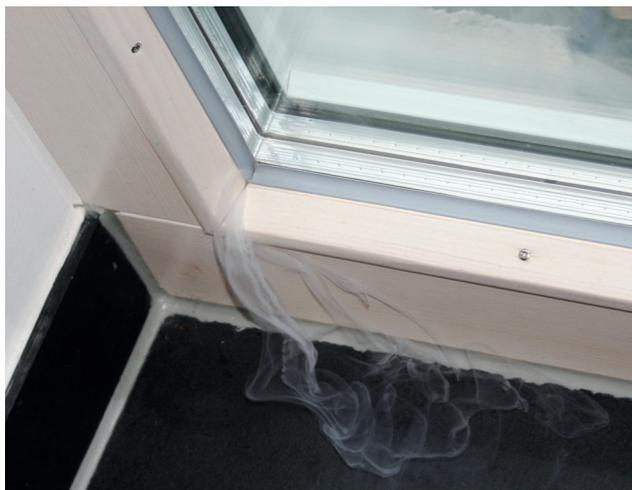
Bild 8.6: Leckage zum Glasfalz über die Glashalteleisten
