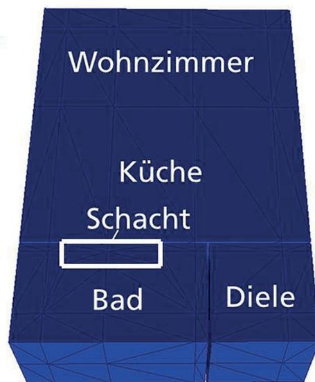
Bild 5.28: Zonierung des Modells (Blick von oben auf die Grundfläche)
