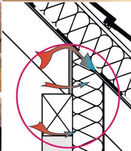
Durchgeführte Nachbesserungen, bei denen u. a. auch die Holzschalung traufseitig geöffnet und eine Verbindung der Folie des Daches mit der Außenwand hergestellt wird (Bild links), bringen keinen umfassenden Erfolg. Es gibt weiterhin Leckagen im Bereich der Anschlüsse und an den mit Rissen versehenen historischen Sparren. Im auf die Nachbesserungen folgenden Winter kommt es erneut zur Reif- bzw. Eisbildung (Bild rechts).
