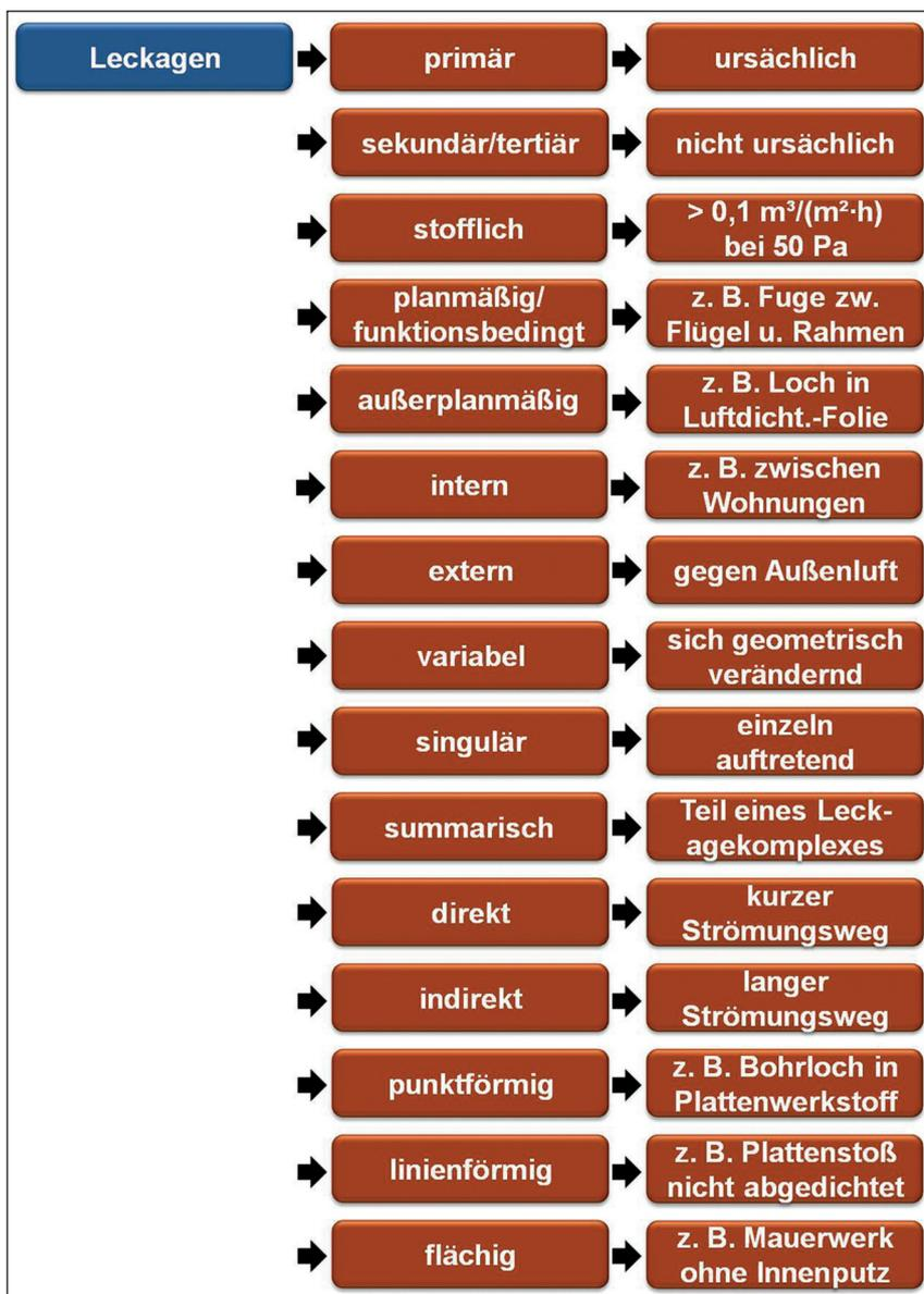
Bild 2.6: Einzelsprache von Leckagen (Mikrobetrachtung)
