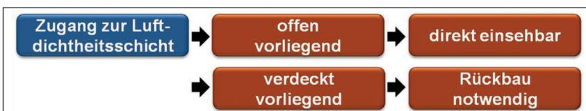
Bild 2.4: Zugang zur planmäßig vorgesehenen Luftdichtheitschicht
