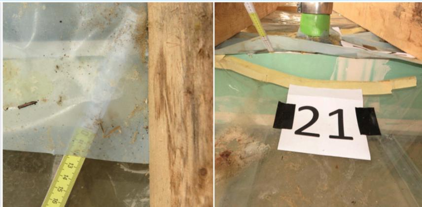
Beispiele für primäre Leckagen oberhalb des Bades im Bereich einer Folienfalte (Bild links) und im Bereich der Abdichtung an eine Rohrleitung (Bild rechts)
