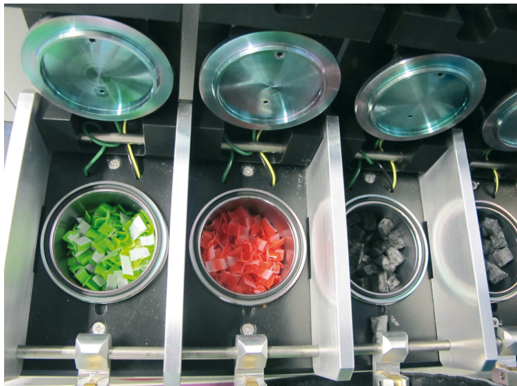
Bild 8: Bestimmung der massenabhängigen Emissionsraten von Rohr- und Dämmmaterialien mittels Thermoextraktion.
