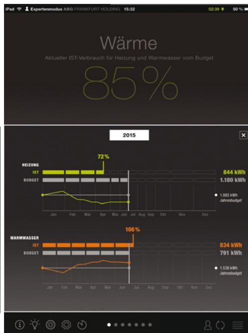
Abb. 35: Anders als beim Strom, steht die Detailebene, allen Nutzern zur Verfügung. Die Abbildung zeigt die Daten der 27. KW. Es handelt sich um eine Woche im Sommer, in der das Budget für die Heizenergie 0 kWh beträgt.
