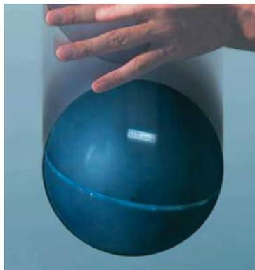
**Abb. 5:** Japanischer Gummiball (schwere / weiche Trittschallquelle) nach DIN EN ISO 10140-5, Anhang F.2. Zur Erzeugung der gemessenen Geräusche lässt man den Ball normalerweise mit der Hand aus einer Höhe von 1 m frei auf die Decke herabfallen. Die Fallbewegung erfolgt alleine aufgrund des Eigengewichts des Balls, so dass er mit einer Geschwindigkeit von ca. 4,4 m/s senkrecht auf die Decke auftrifft.
