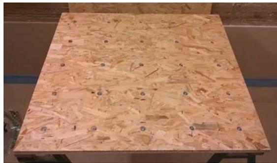
**Abb. 15:** Verschraubung von zwei OSB-Platten mittels Zylinderschrauben und Einschlagmuttern zur Herstellung der für eingezwängte Dämpfungsbeläge erforderlichen mechanischen Randbedingungen (vollflächige kraftschlüssige Verbindung zwischen dem Belag und der ober- und unterseitigen Platte).
