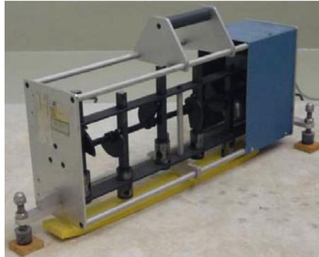
**Abb. 4:** Modifiziertes Norm-Hammerwerk nach DIN EN ISO 10140-5, Anhang F.1, Verfahren B. Bei der elastischen Unterlage (als gelber Streifen unter der Schlagfläche des Hammerwerks erkennbar) handelt es sich um eine 12,5 mm dicke Schicht aus Sylomer SR 11 (gemischtzelliger Polyurethan-Schaum der Getzner Werkstoffe GmbH). Am eine gleichbleibende Fallhöhe der Hämmer zu gewährleisten, wurden die Füße des Hammerwerks mit 12,5 mm dicken Abstandshaltern unterlegt.
