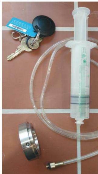
b) Spritze mit manueller Kontrolle der Einleitungsgeschwindigkeit
