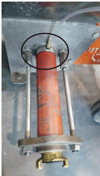
a) An die Mörtelpumpe angeschlossener Adapter
