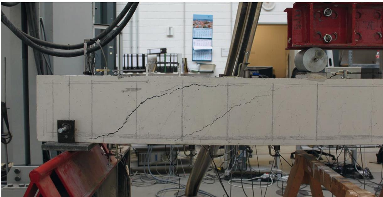
Abbildung 42: Rissbild beim Versagen des linken Schubfelds von Balken BR03
