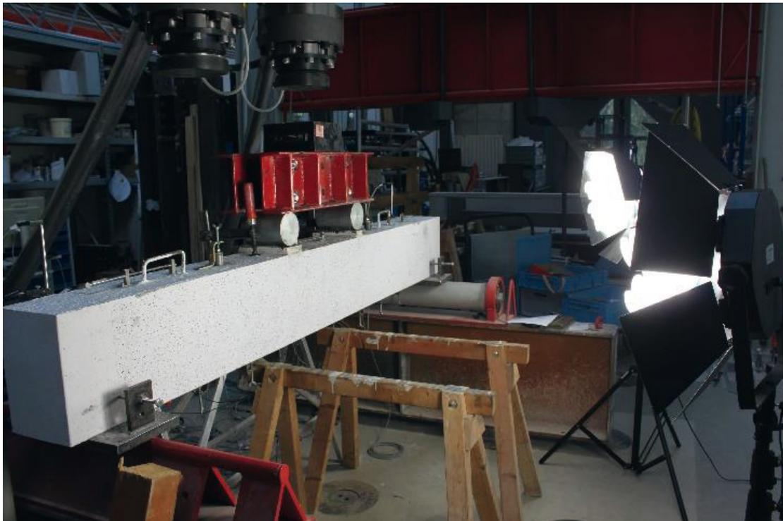
Abbildung 26: Anwendung der Fotogrammetrie zur Überwachung der Rissentwicklung
