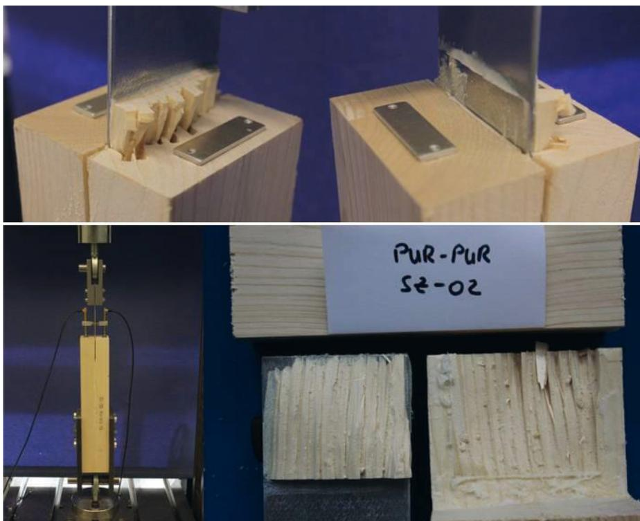
Bild 2-19: VR 1A, Probekörper PUR-PUR-SZ-02, Versagen PUR-Fuge unten
