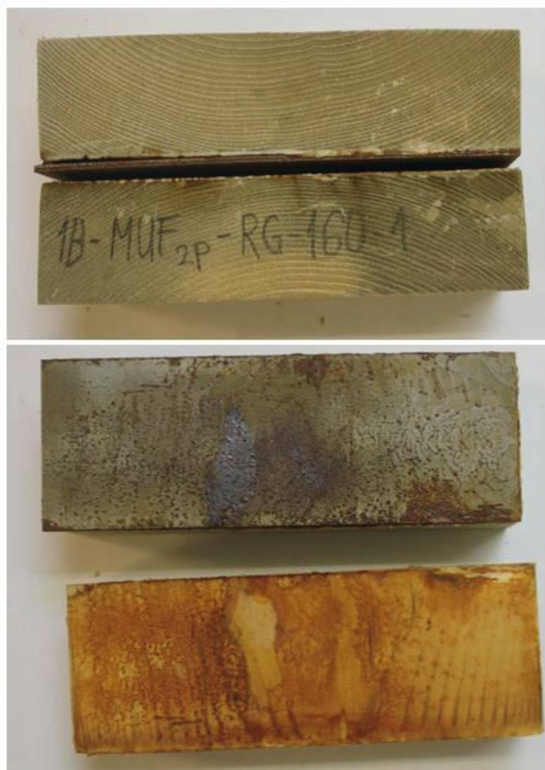
Bild 2-51: MUF-MUF-P-RG (B=160 mm) nach Wasserlagerung II (kaputt nach zweiten Zyklus)
