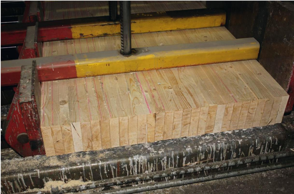
**Abbildung 32: Verpressen der Probekörper des AP 4 mit EP-verklebten Stahlblechen, lokaler Austritt von EP-Klebstoff aus den Fugen**
