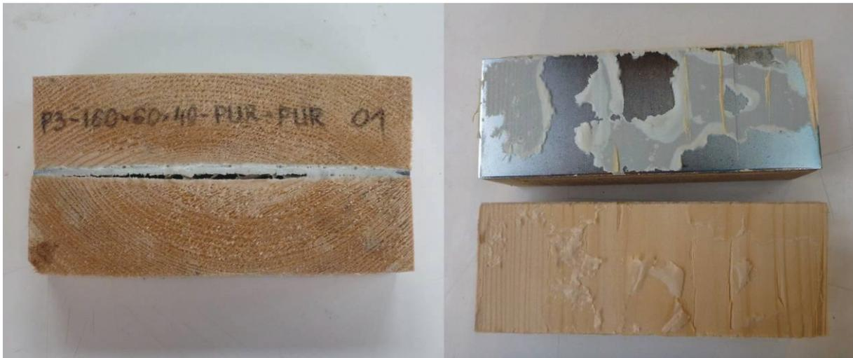
**Abbildung 15: Versuchsreihe 1B: Versagen eines 160 mm breiten Probekörpers in der Trocknungsphase nach der ersten Wasserlagerung**
