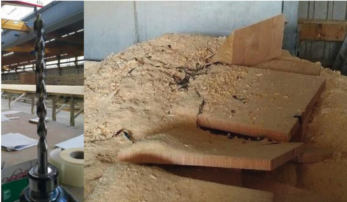
**Abbildung 33: Bearbeitung der Brett-schichtholz-elemente mit eingeklebten Stahlblechen in der automatischen Abbundanlage: verwendeter Bohrer (links) und Stahl-/Holzspangemisch (rechts)**
