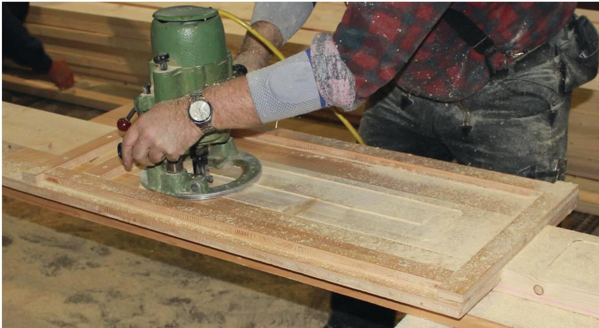
Abbildung 29: Herstellung der Aussparungen für die Bleche mit der Oberfräse
