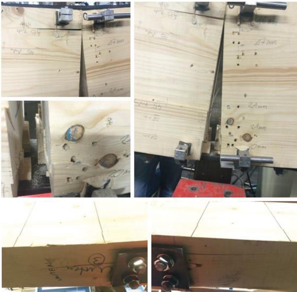
Bild 5-32: VR4B: Probekörper EP-B-1
