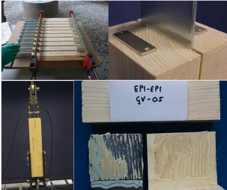
Bild 2-18: VR 1A, Probekörper EPI-EPI-GV-05, Versagen EPI-Fuge unten
