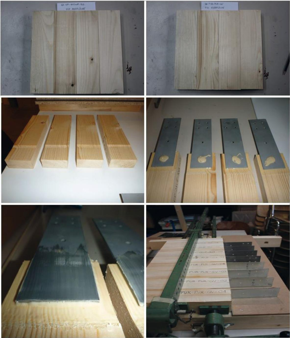
Bild 3-4: Probekörper Vorbereitung
