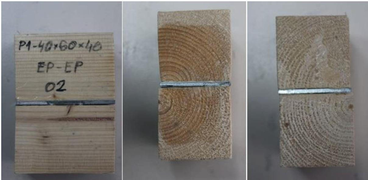
Bild 2-42: Probekörper (B=40 mm) nach dritter Wasserlagerung
