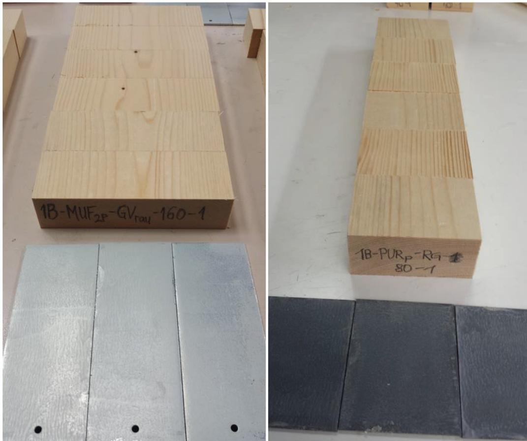
Bild 2-46: Vorbereitung der Proben für Wasserlagerung II
