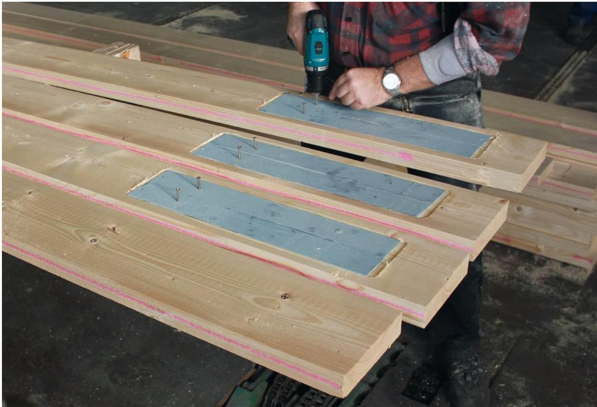
**Abbildung 30: Fixierung der eingeklebten Stahlbleche mit Schrauben (hier: Zugstäbe VR 4A mit PUR-Verklebung)**
