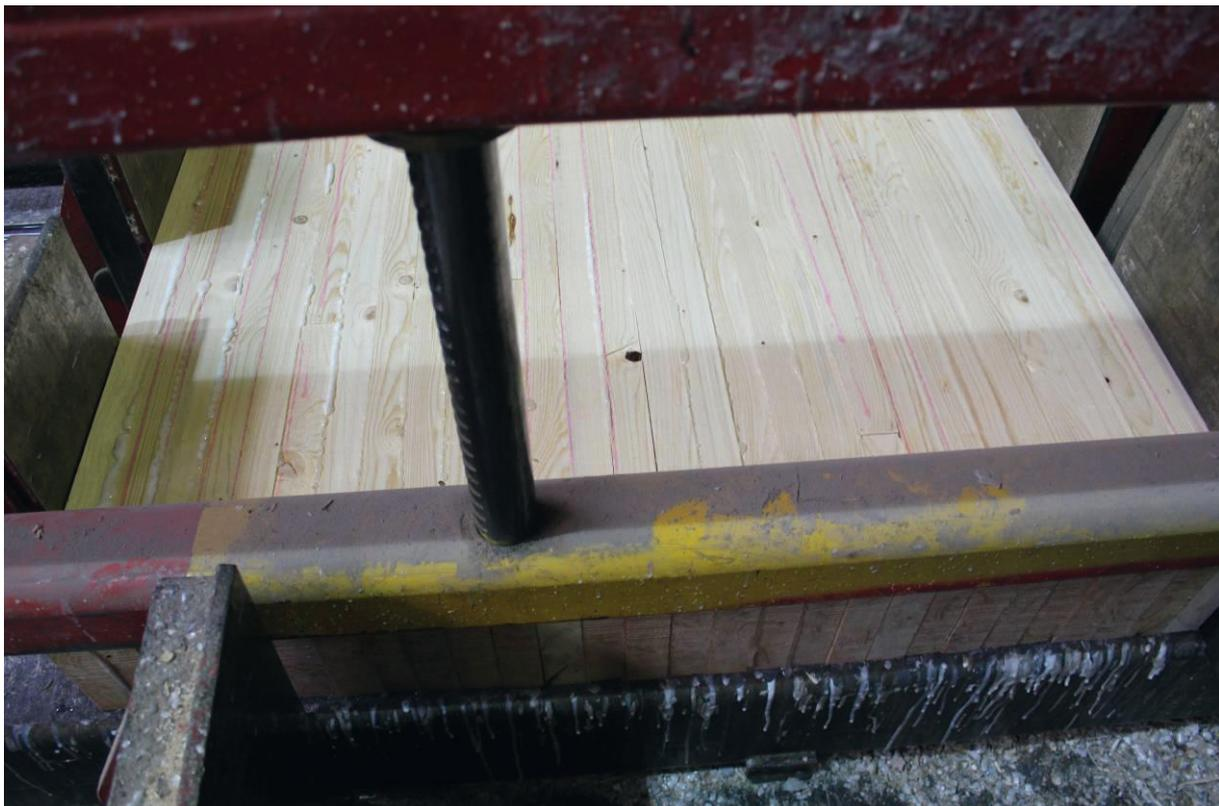
Abbildung 31: Verpressen der Probekörper des AP 4 mit PUR-verklebten Stahlblechen, lokaler Austritt von PUR-Klebstoff aus den Fugen
