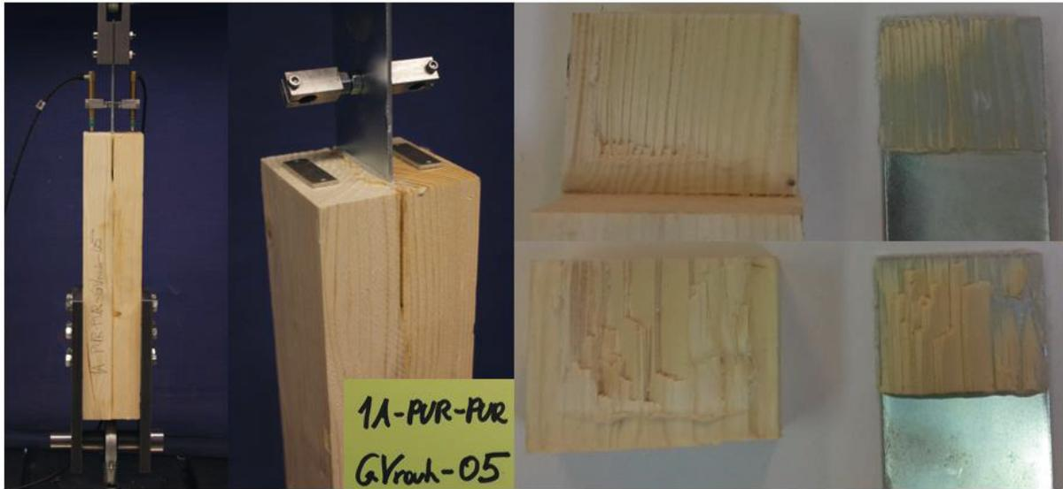
Bild 2-20: VR 1A, Probekörper PUR-PUR-GVrauh-05
