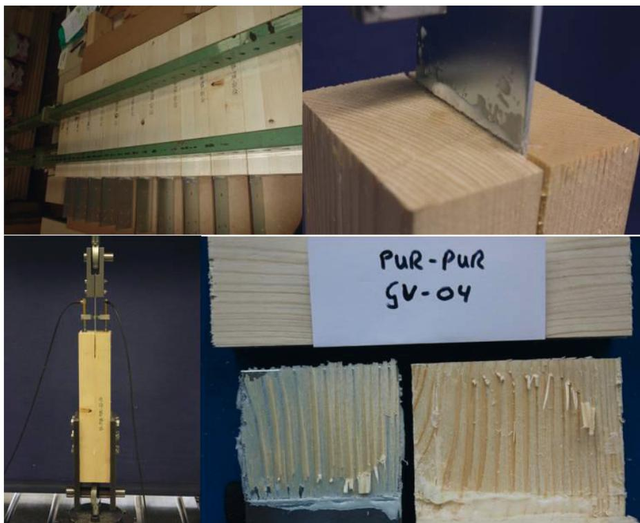
Bild 2-17: VR 1A, Probekörper PUR-PUR-GV-04, Versagen PUR-Fuge unten
