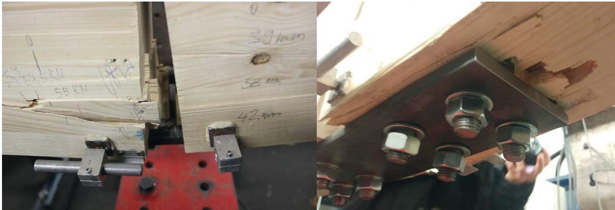
Abbildung 54: Versuchsreihe 4B: Biegesteife Trägerstöße mit Bolzenverbindung, Bruchzustand Probe PUR-B-1
