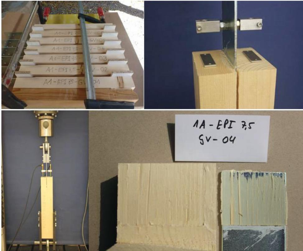
Bild 2-8: VR 1A, Probekörper EPI7,5-GV-04, Versagen EPI-Fuge
