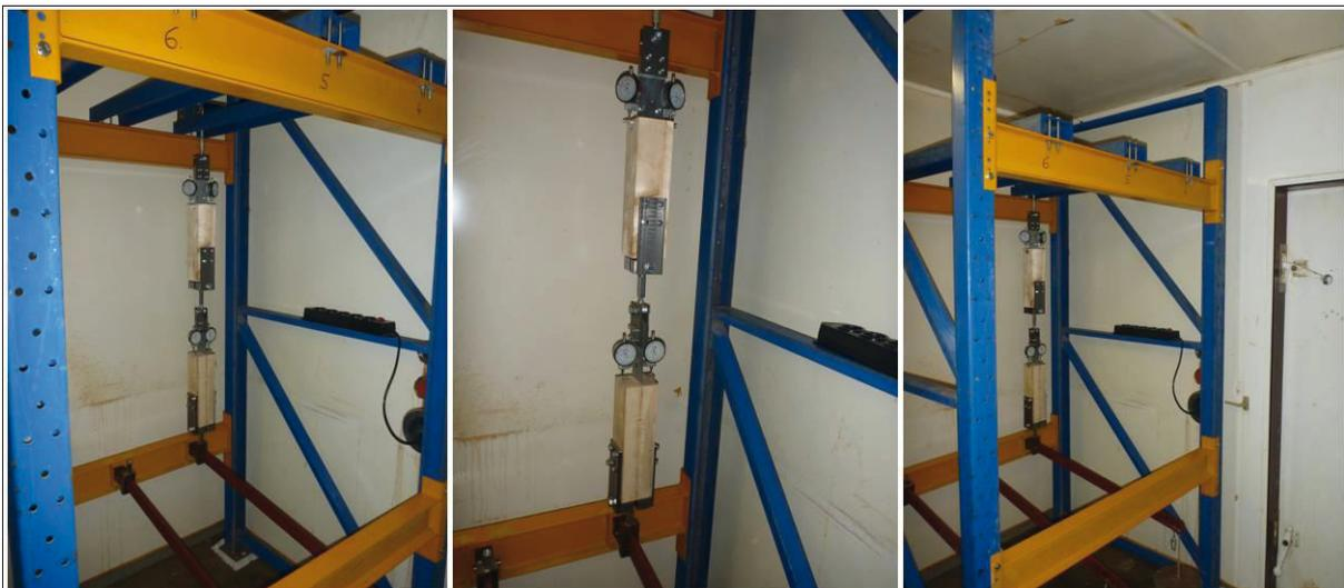
Bild 3-3: Probekörper in Klimakammer – Vorversuch
