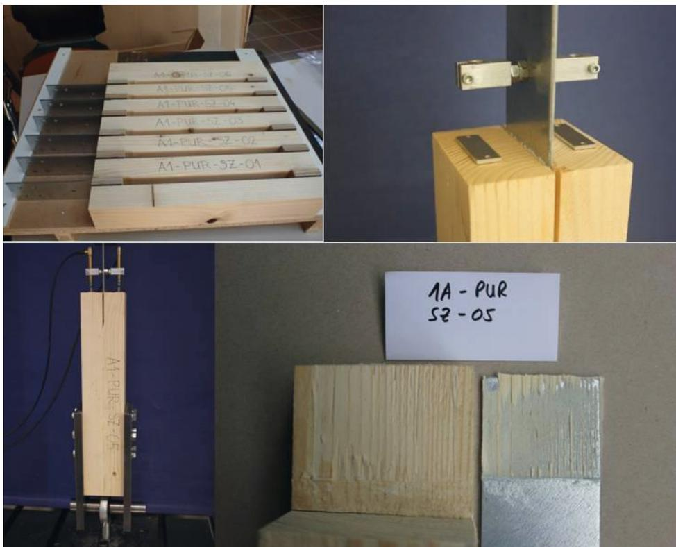
Bild 2-9: VR 1A, Probekörper PUR-SZ-05, Versagen PUR-Fuge
