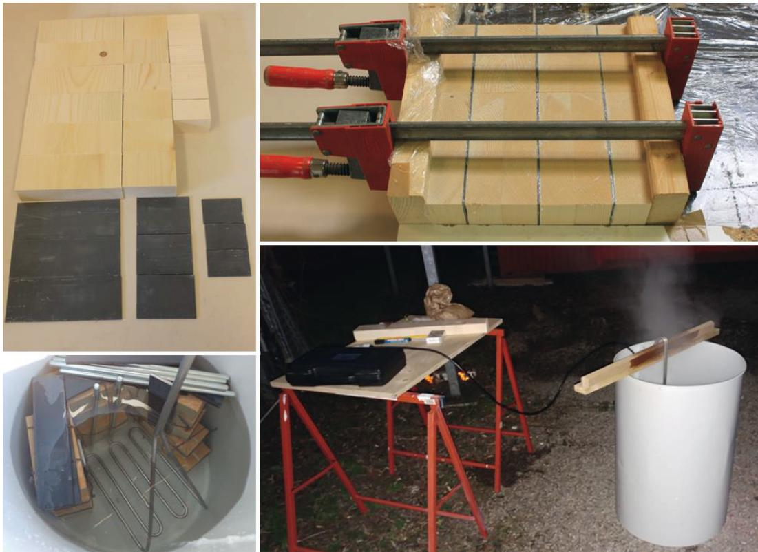
Bild 2-56: Vorbereitung und Prüfung der Proben für Heißwasserlagerung
