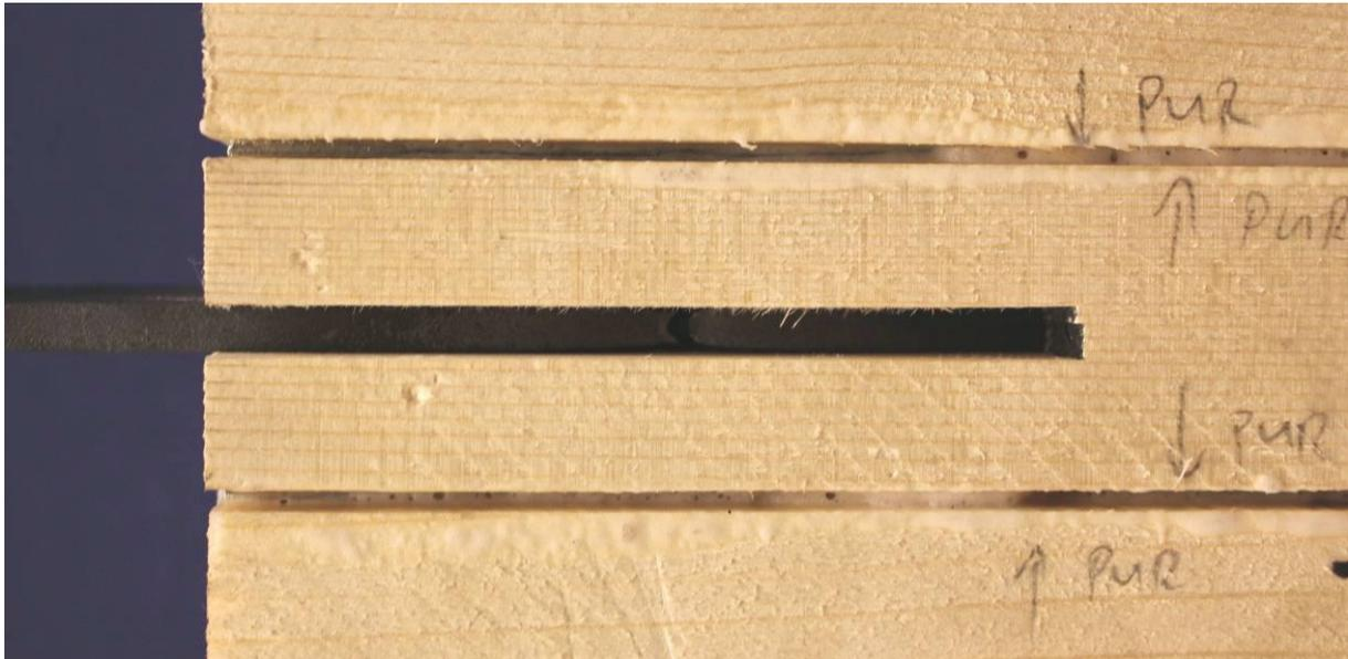
**Abbildung 42: Versuchsreihe 4V: Versagen des Probekörpers PUR-PUR-GV-B-02 durch Zugbruch des eingeschlitzten Anschlussblechs**
