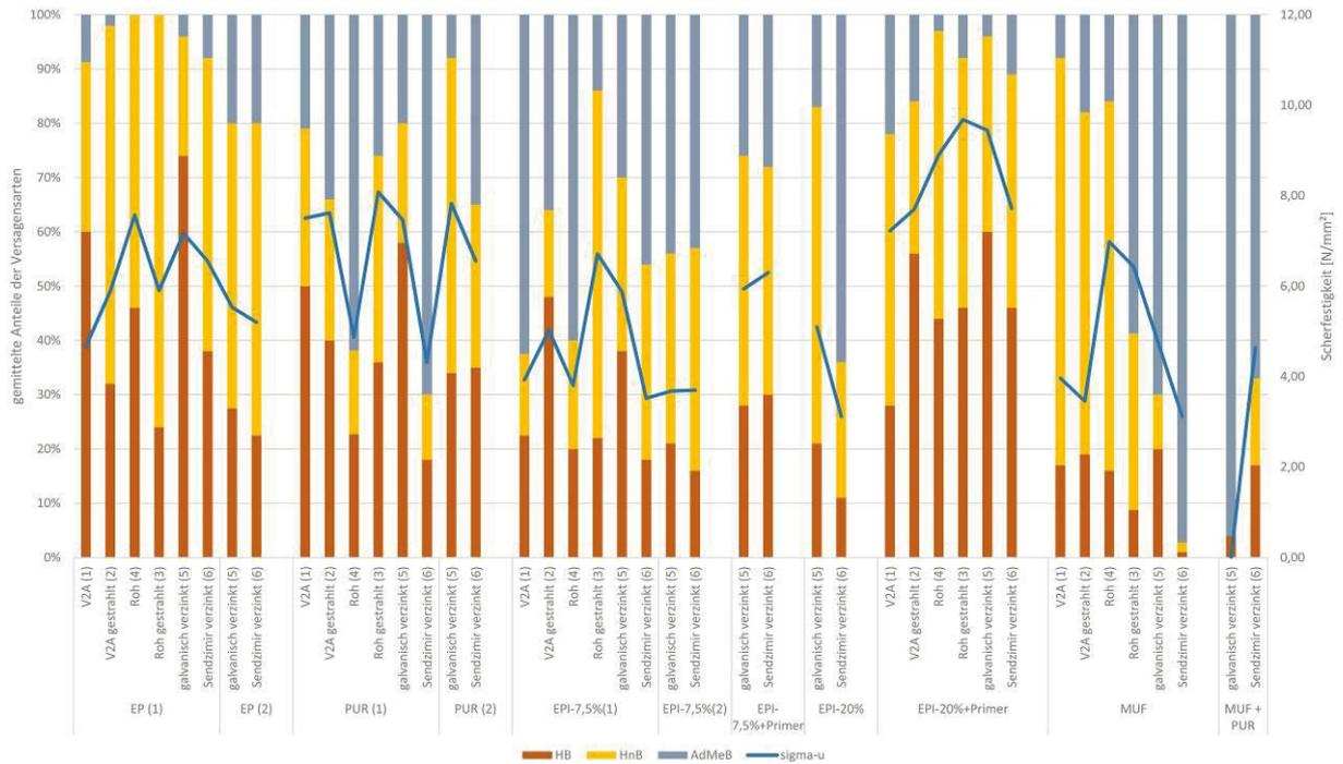
**Abbildung 3: Verteilung der Versagensarten für die einzelnen Blech-Klebstoff-Kombinationen und zugehörige Scherfestigkeiten, jeweils als Mittelwerte**
