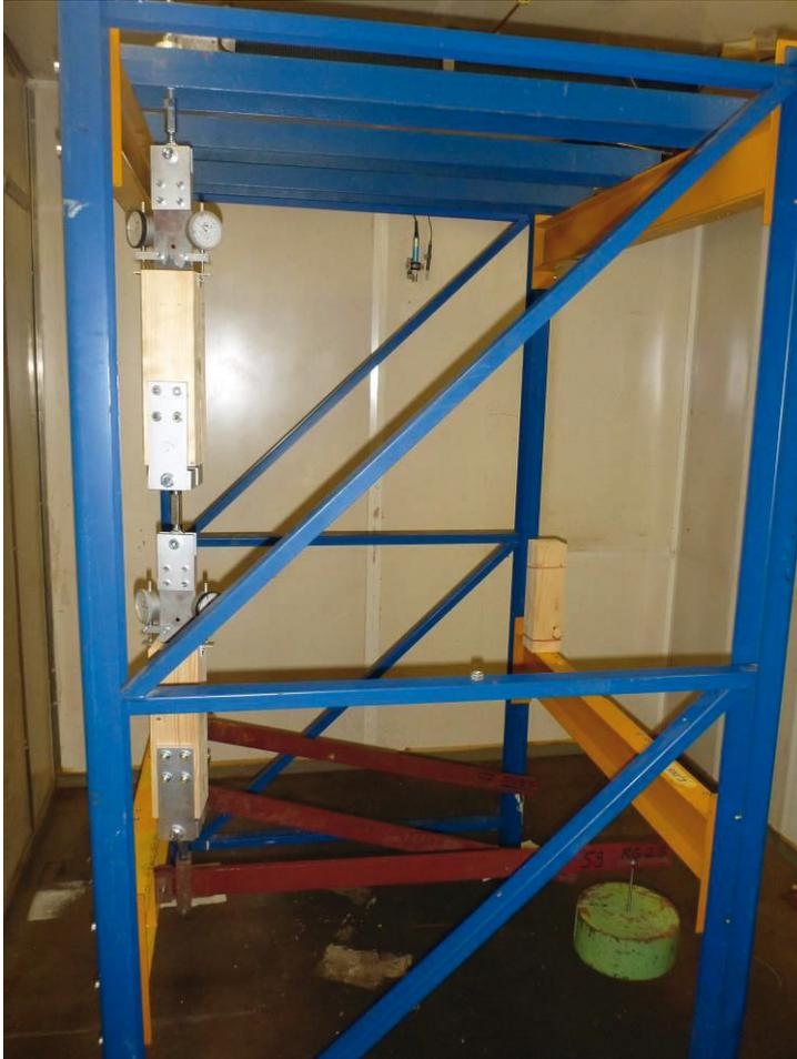
Abbildung 25: Arbeitspaket 2: Versuchsaufbau der Langzeitversuche im Wechselklima
