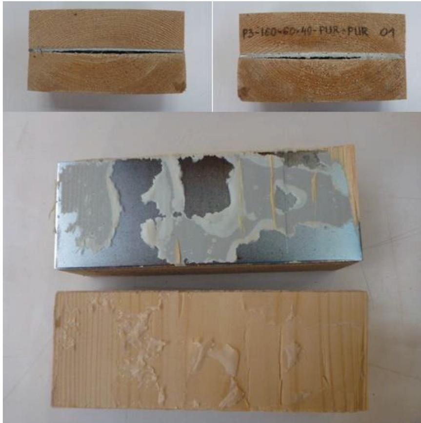
Bild 2-44: Probekörper (B=160 mm) nach erster Trocknung
