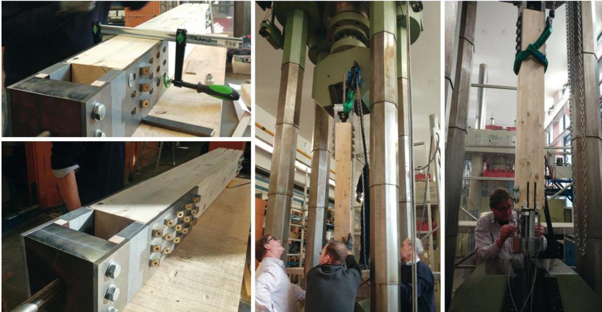
Bild 5-17: VR 4A: Zugprobekörper - Vorbereitung beim IBAC
