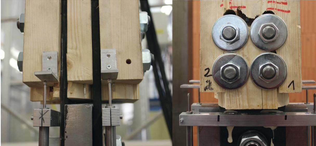
Abbildung 46: Versuchsreihe 4A: Bruchbild Probe PUR-B-1
