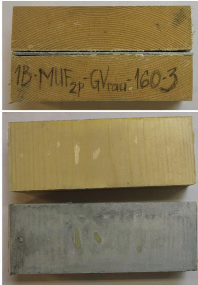
Bild 2-52: MUF-MUF-P-GVrau (B=160 mm) nach Wasserlagerung II (kaputt nach zweiten Zyklus)
