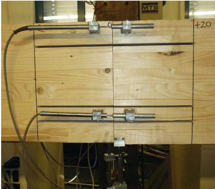
Abbildung 50: Versuchsreihe 4B: Anordnung Wegaufnehmer am Stoß
