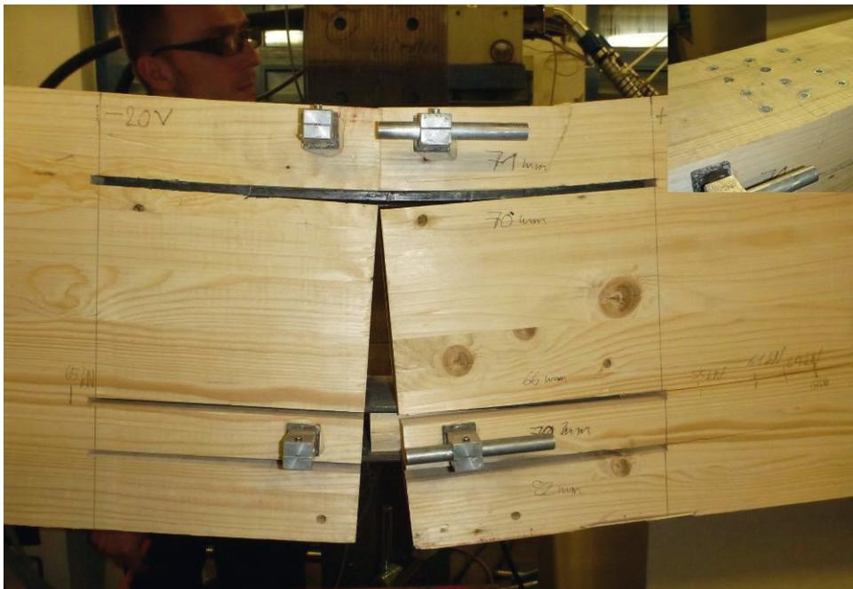
Abbildung 52: Versuchsreihe 4B: Biegesteife Trägerstöße mit Stabdübelverbindung, Bruchzustand Probekörper PUR-D-2
