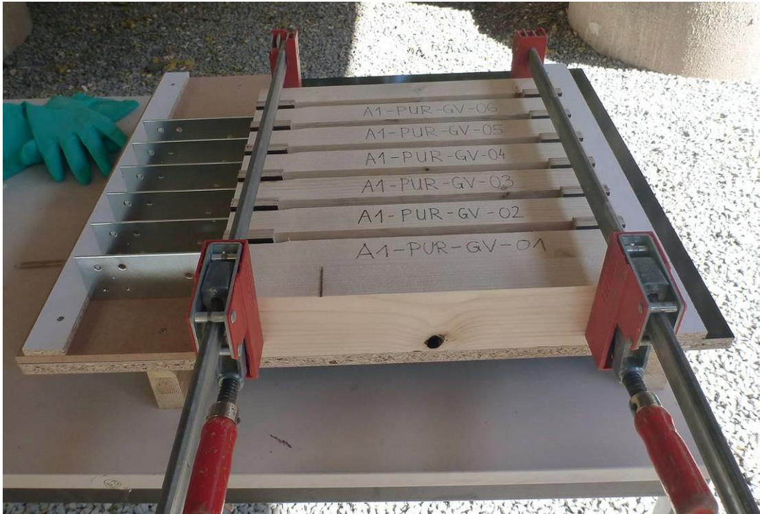
Abbildung 5: Versuchsreihe 1A – Pressen der Blech-Holz-Verklebung (hier PUR und galvanisch verzinktes Blech)
