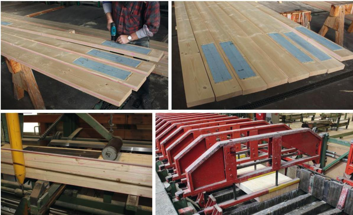
Bild 4-2: Herstellung der Probekörper bei Hüttemann
