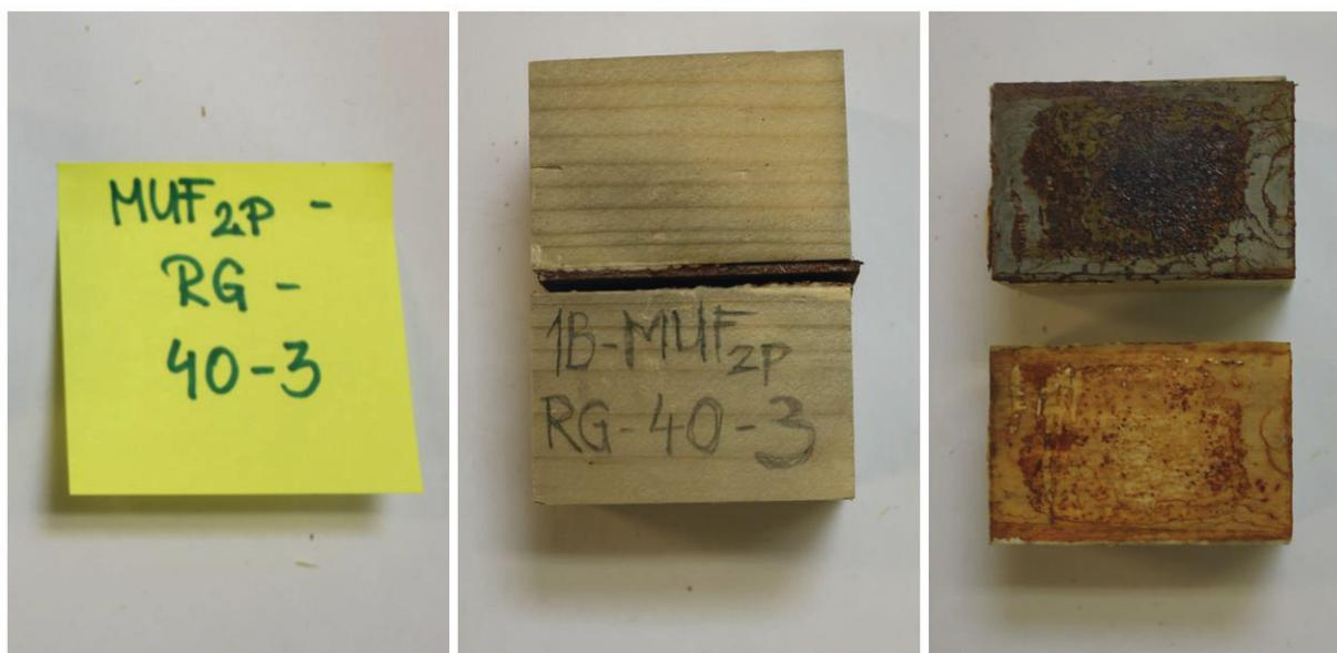
Bild 2-47: MUF-MUF-P-RG (B=40 mm) nach Wasserlagerung II (kaputt nach zweite Zyklus)
