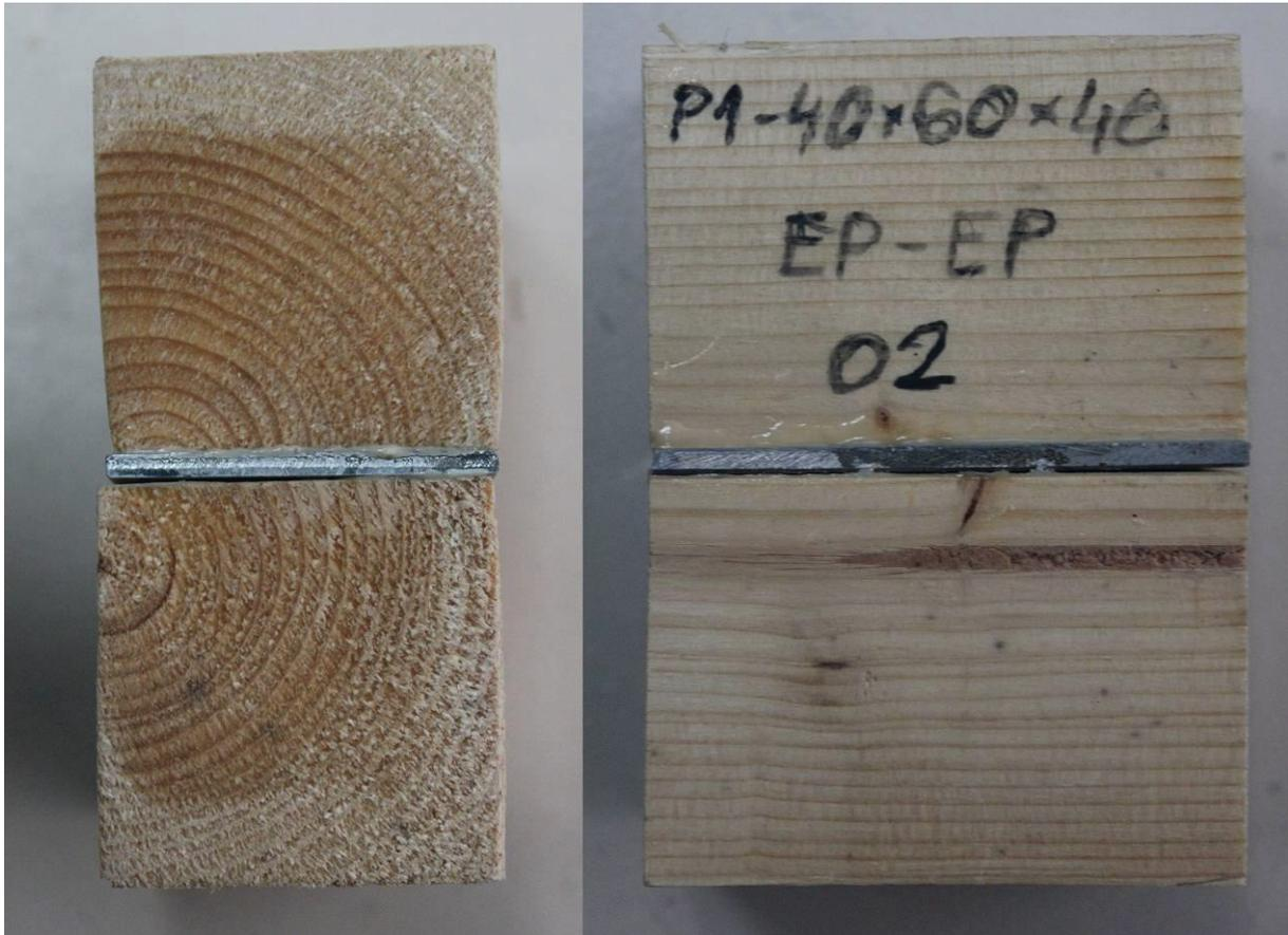
Abbildung 16: Versuchsreihe 1B: Versagen eines 40 mm breiten Probekörpers in der Trocknungsphase nach der dritten Wasserlagerung
