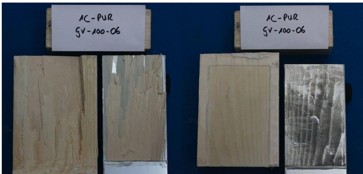
**Abbildung 21: Versuchsreihe 1C: Bruchbild des Probekörpers PUR-GV-100-06 mit 100 mm Klebfugenlänge; links PUR-Fuge, rechts MUF-Fuge**
