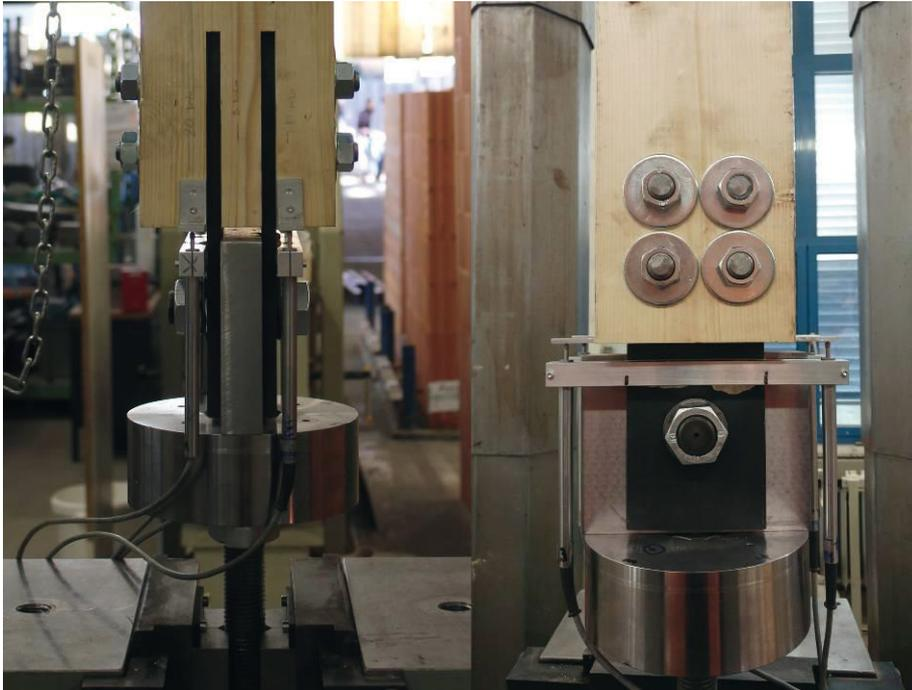
Abbildung 43: Versuchsreihe 4A: untere Verankerung der Probekörper
