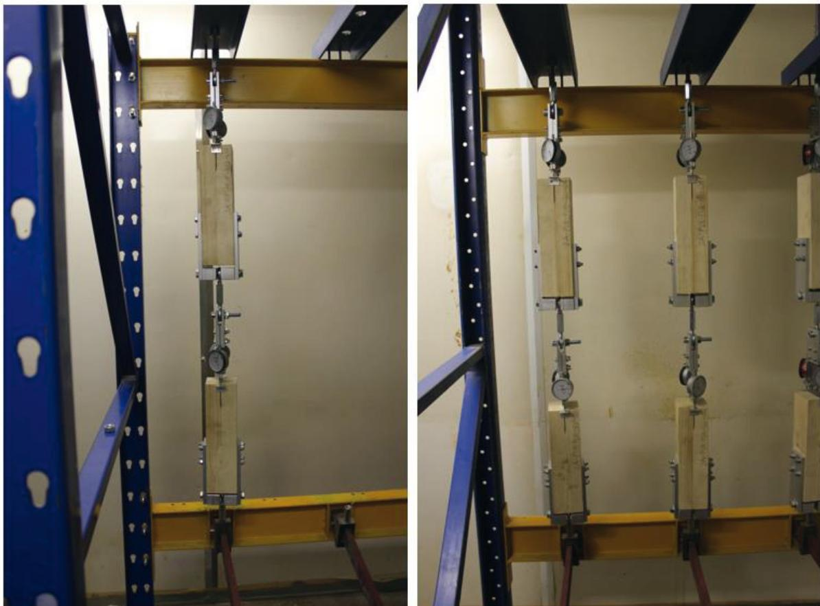
Bild 3-6: Probekörper in Klimaraum – Langzeitversuch
