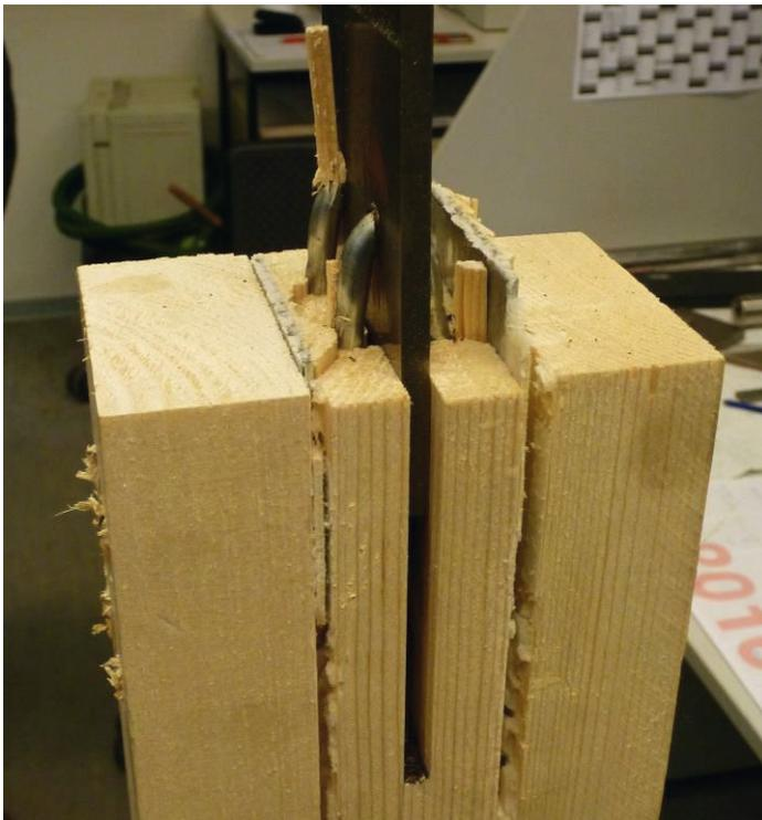
**Abbildung 40: Versuchsreihe 4V: Versagen des Probekörpers PUR-MUF-GV-03 durch Bruch der Klebfuge**
