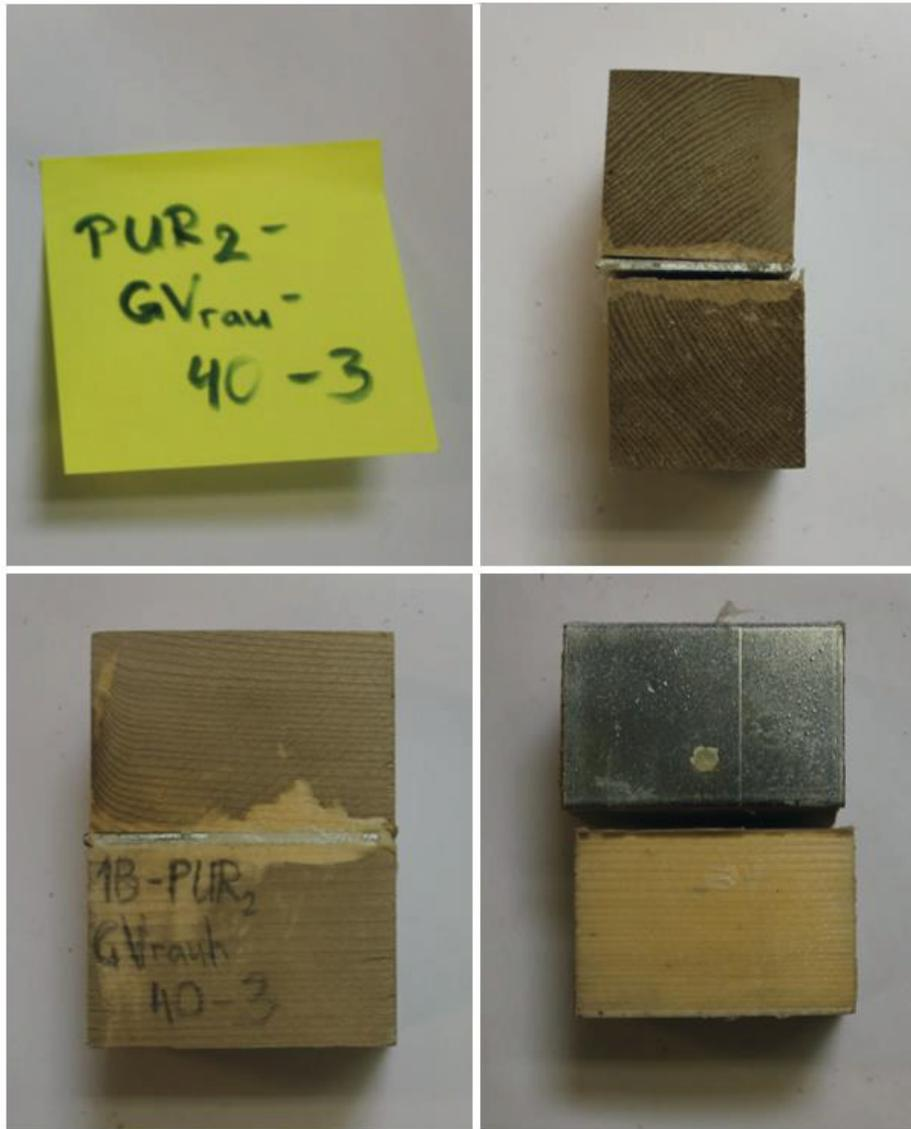
Bild 2-48: PUR-PUR-GVrau (B=40 mm) nach Wasserlagerung II (kaputt nach neunten Zyklus)
