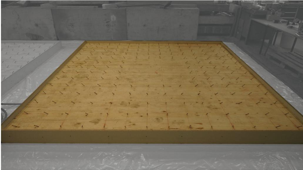
**Abbildung 4.7:** Anordnung der Schubverbindungsmitel im Prüfkörper
