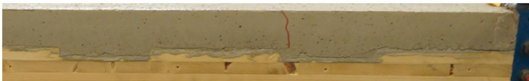
(b) Kerfe der Hauptträgerichtung (x): Kerfe unbeschadet. Der im Bild zu sehende Riss (rot) kommt von der Betonoberseite
