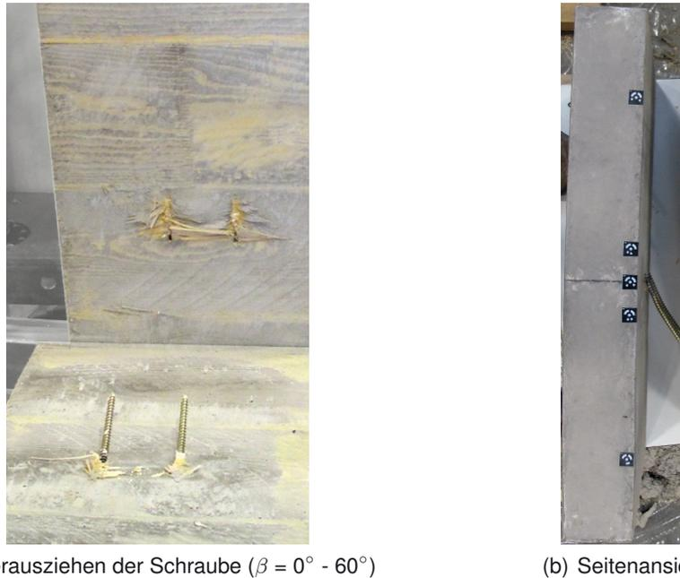
**Abbildung 2.32:** Versagensbild Push-Out-Versuch - Schraube
