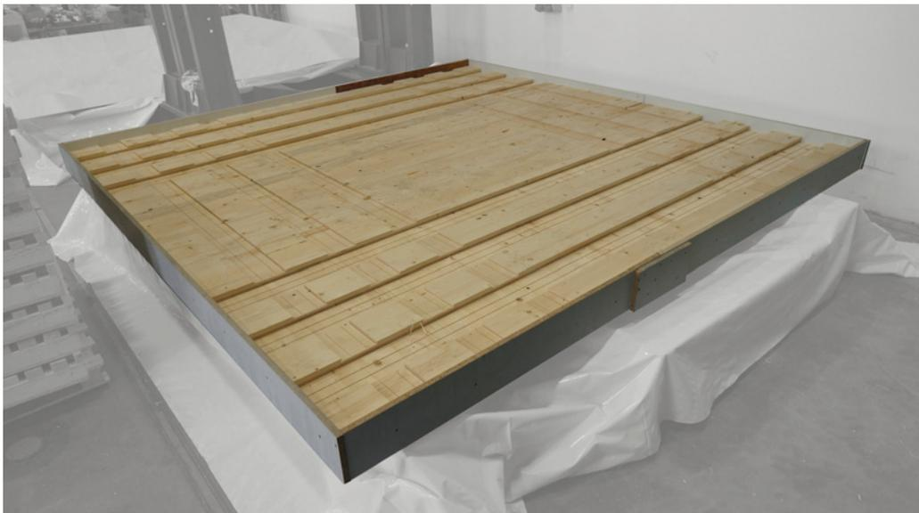
**Abbildung 4.5:** Brettspertholz mit Kervenschnitt
