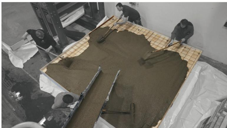
**Abbildung 4.8:** Betonieren eines Probekörpers
