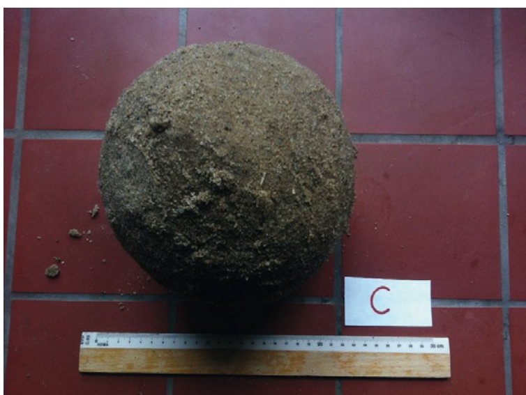
Abbildung A-2: Ausgebaute Prüfkörper des Versuchs ST, Prüfkörper A: Baugrundsand, Prüfkörper B: Frechener Feinsand, Prüfkörper C Baugrundsand
