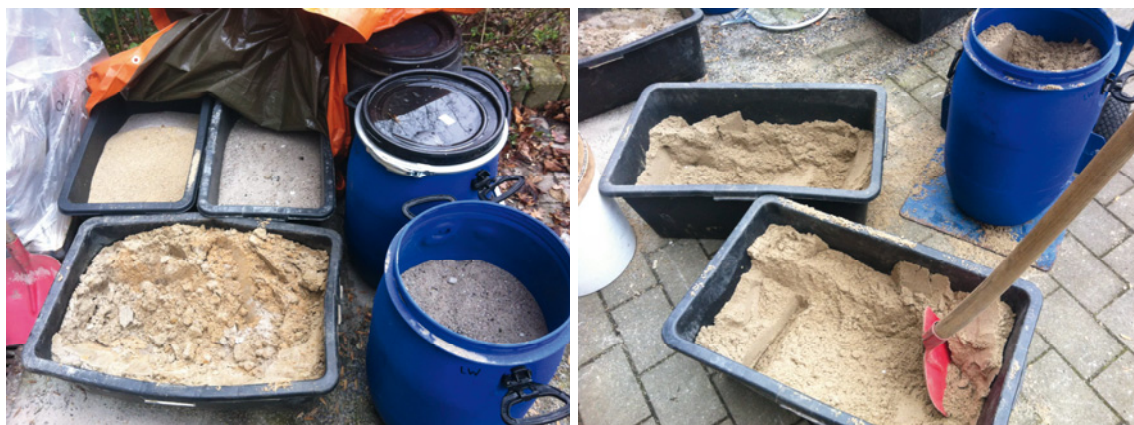
Abbildung 3: Verwendete Baugrundsande mit unterschiedlicher Qualität (linkes Bild) und daraus hergestellter homogenisierter Versuchssand (rechtes Bild).
