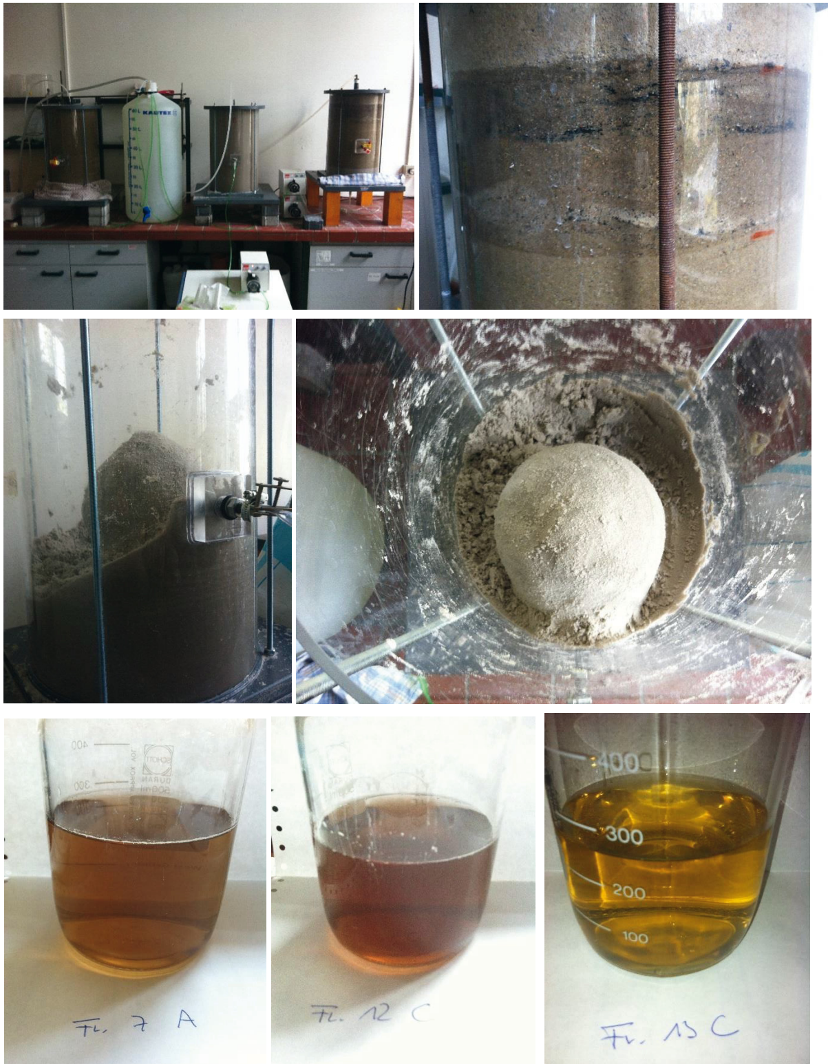
Abbildung A-1: Impressionen Säulenversuch - Säulenversuchsanlage, gefüllte Säule mit 10cm mächtiger Kohlereibschicht, freigelegter Prüfkörper von der Seite und von oben, gefärbte Eluate der Versuche ST 1 und ST 2
