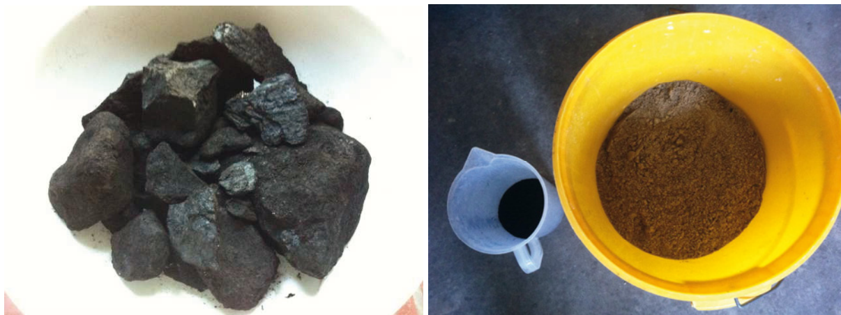
Abbildung 4: Kohlereibsel und Mischgefäß zur Herstellung der Kohlereibselsschicht
