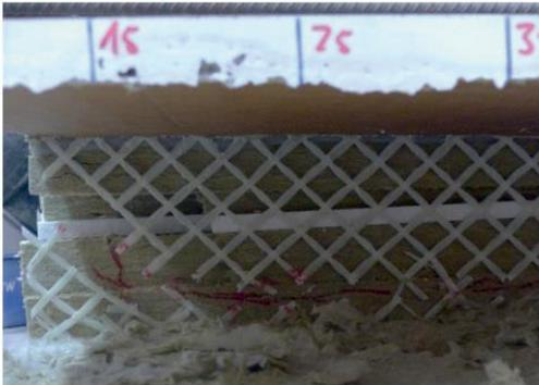
Abb. 4: Stabilitätsversagen des Schubgitters
