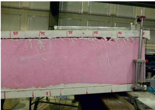
Abb. 2: Plattenverschiebung am rechten Auflager (nach Abb.1)
