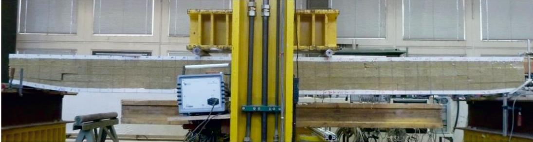
Abb. 1: Versuchskörper im Bruchzustand
