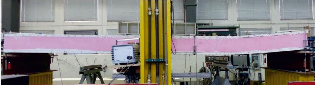
Abb. 1: Versuchskörper im Bruchzustand
