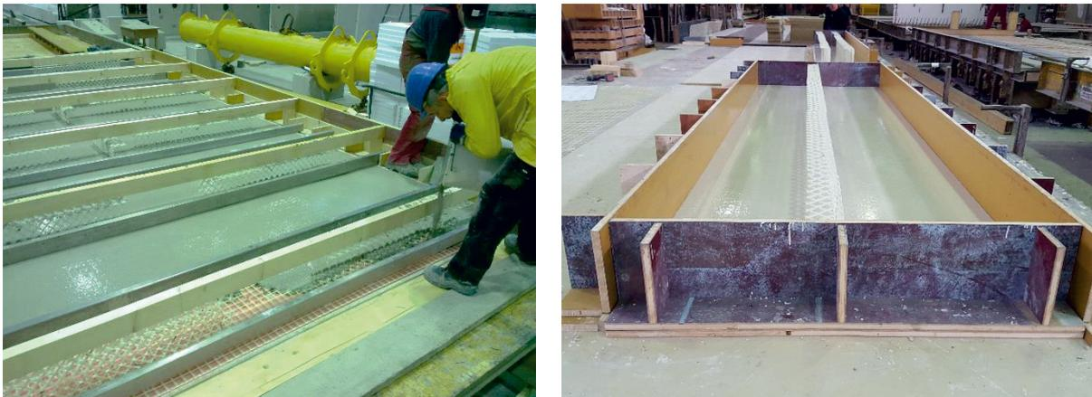
Abbildung 11: Einbringen des Betons (links: großformatiges Element); erhöhte Schalung mit frisch betonierter Schale (rechts: Prüfkörper)
