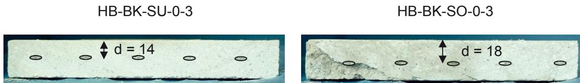
Abbildung 22: Statische Nutzhöhe ausgewählter Querschnitte in Kettrichtung
