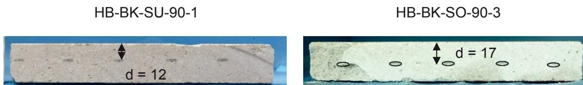
Abbildung 19: Statische Nutzhöhe ausgewählter Querschnitte in Schussrichtung
