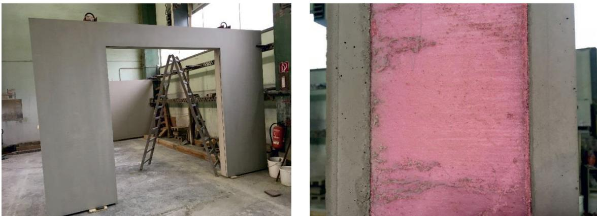
Abbildung 101: Demonstrator vor der Oberflächenbehandlung (links) und Querschnitt des Elements (rechts)
