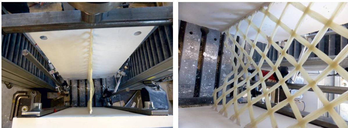
Abbildung 44: Stabilitätsversagen im Versuchskörper SV-D-3-2 unter einer Druck-Abscherbeanspruchung (ohne XPS-Dämmung)
