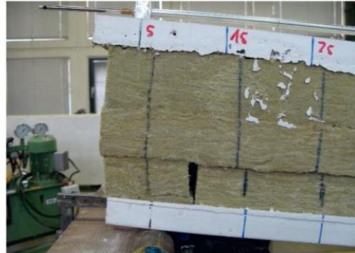
Abb. 3: Plattenverschiebung am linken
