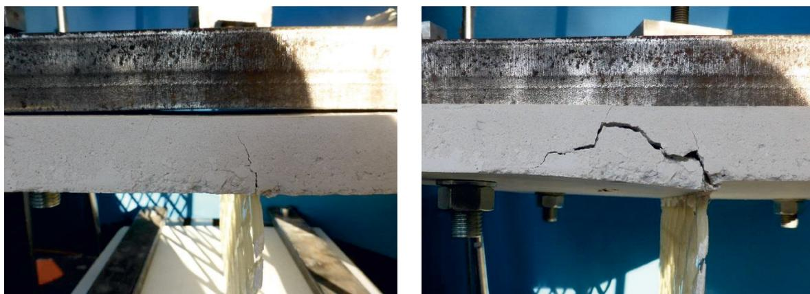
Abbildung 25: Erstriss und Versagensbild des Versuchskörpers HB-ZV-2-3
