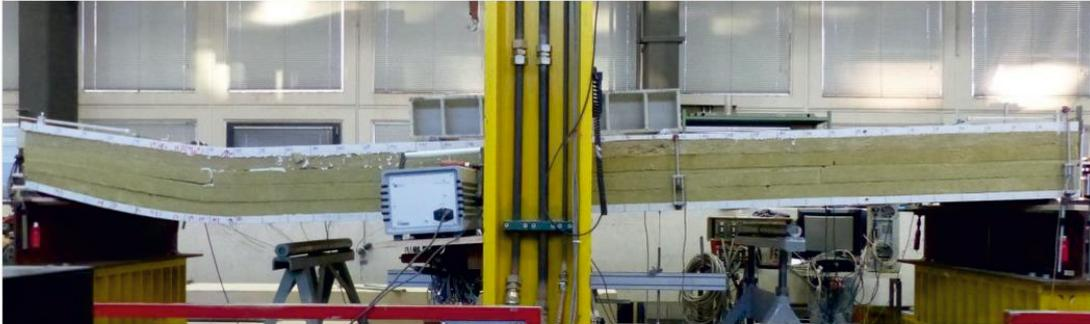
Abb. 1: Versuchskörper im Bruchzustand
