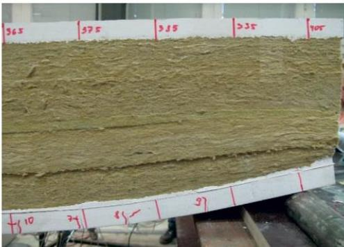
Abb. 4: Kompression am rechten Auflager (nach Abb.1) = WAV\_v1
