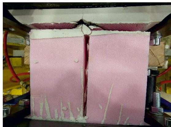
Abbildung 40: Versagenszustand exemplarischer Bauteilversuche unter einer kombinierten Zug-Abscherbeanspruchung
