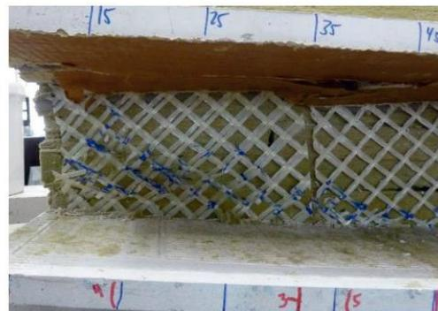
Abb. 5: Stabilitätsversagen des Schubgitters am linken Auflager (nach Abb.1)
