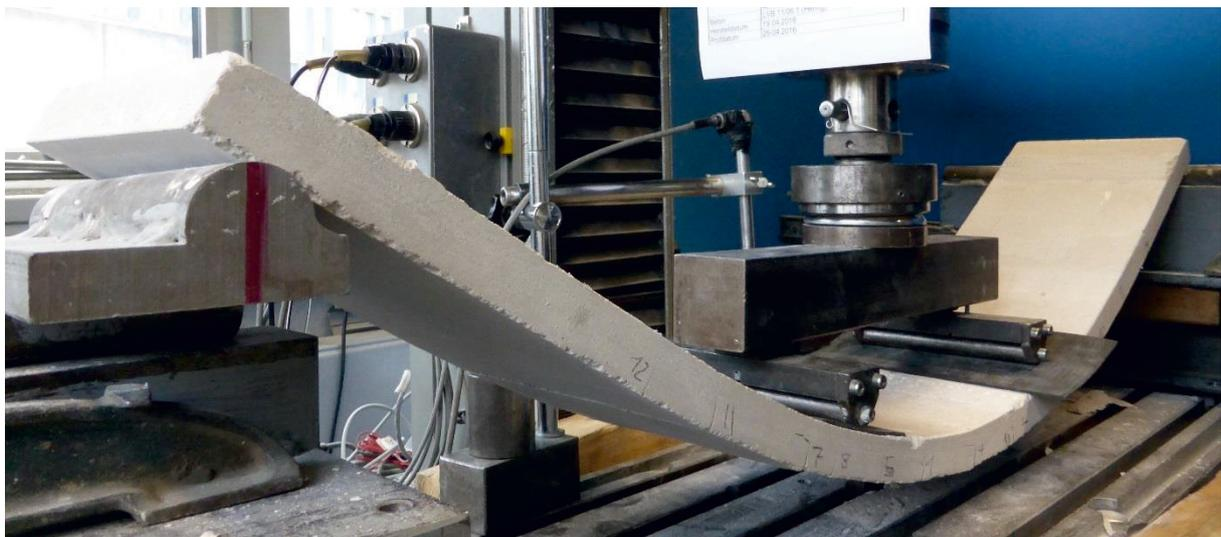
Abbildung 23: Biegeplatte HB-BK-SU-0-2 kurz vor dem Bruch (Kettrichtung)
