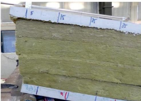
Abb. 4: Plattenverschiebung am linken Auflager (nach Abb.1)
