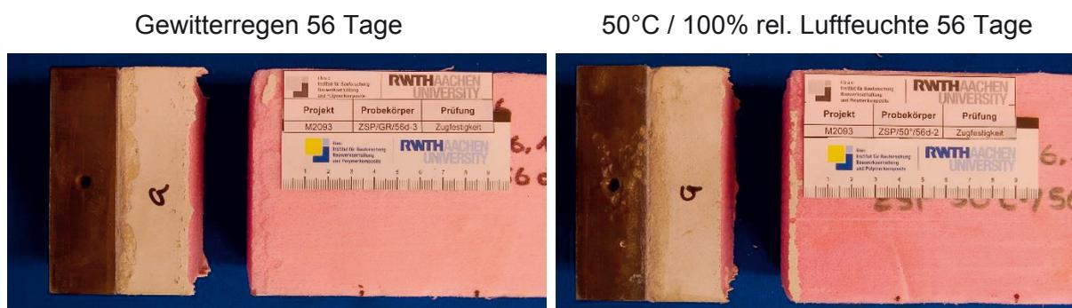
Abbildung 66: Versagensbilder der Dauerhaftigkeitsuntersuchungen an kleinformatischen Sandwichelementen
