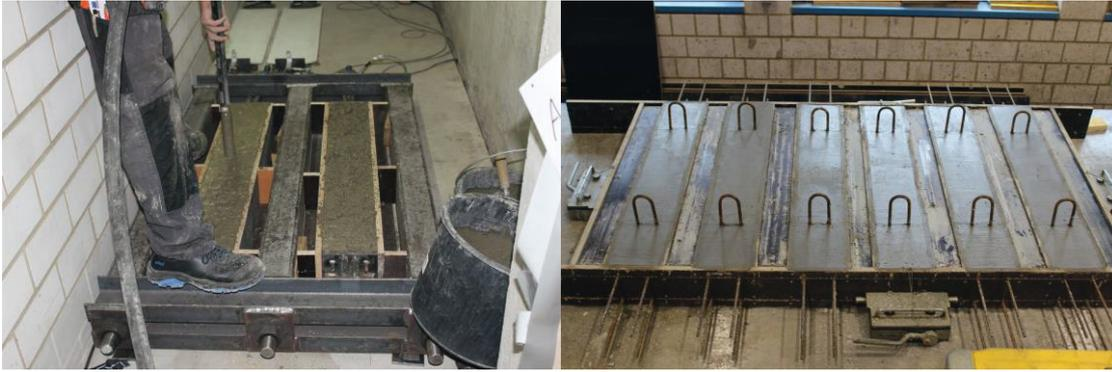
Abbildung 5.42: Herstellung der Versuchskörper
