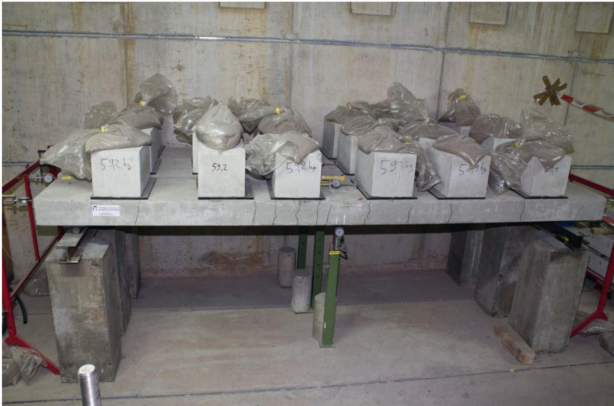
Abbildung 5.38: Dauerstandbiegeversuche
