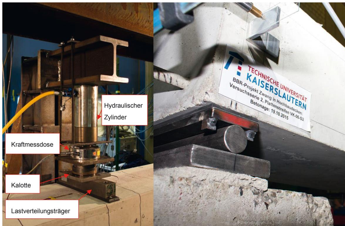
Abbildung 5.6: Lasteinleitung (links), Auflagerung des Versuchskörpers (rechts)
