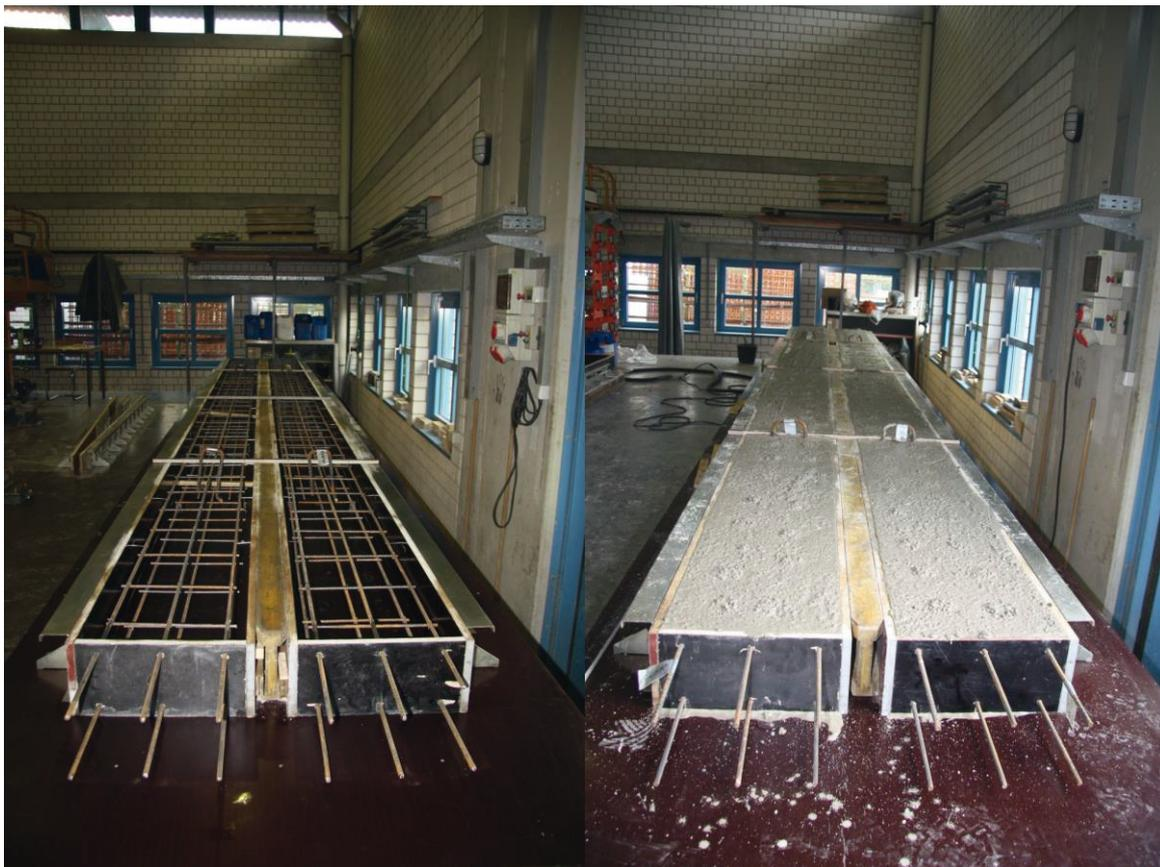
Abbildung 5.3: Herstellung der Versuchskörper im Rahmen der Versuchsreihe „Kurzzeitversuche“
