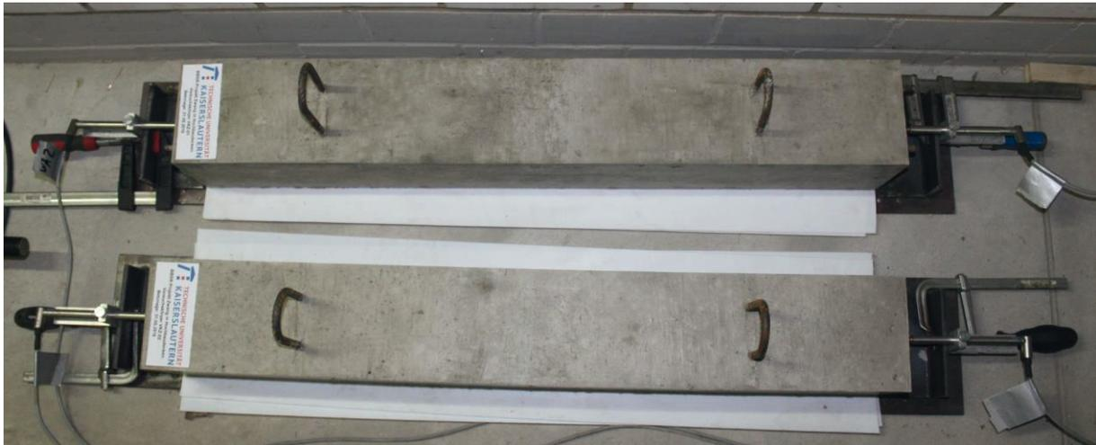
Abbildung 5.47: Versuchseinrichtung für die Aufzeichnung der auftretenden Schwinddehnung
