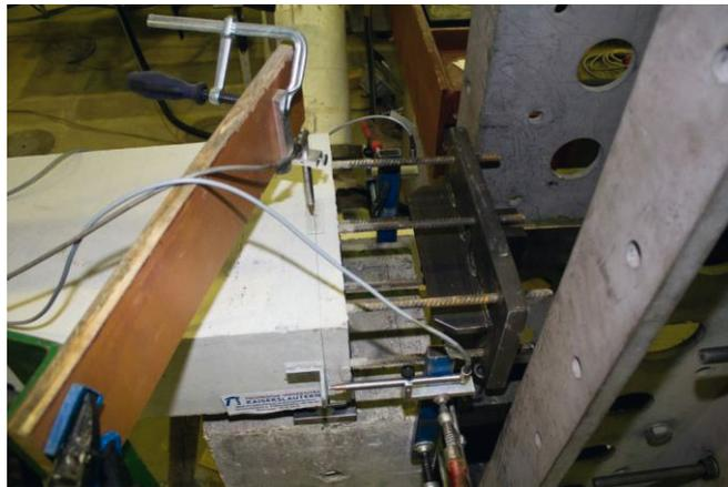
Abbildung 6.25: Längszugkrafteinleitungskonstruktion
