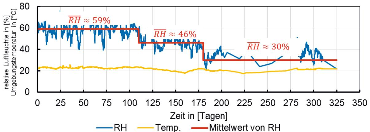
Abbildung 6.34: Mittelwerte der aufgezeichneten relativen Luftfeuchte für einzelne zeitliche Abschnitte der Dauerstandversuche
