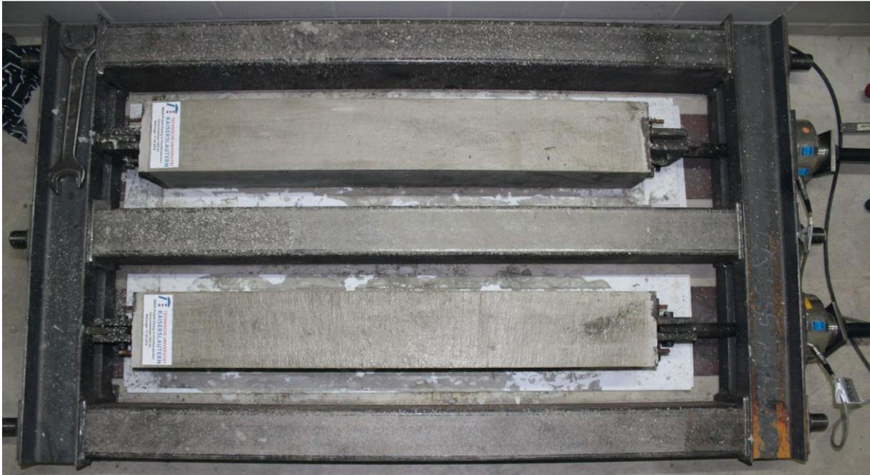
Abbildung 5.45: Versuchsrahmen zur Messung der Zwangkräfte
