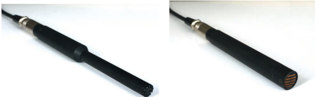
Bild 37: Ein Meßmikrofon (links) und ein Studiokondensatormikrofon mit Kugelcharakteristik (rechts).
