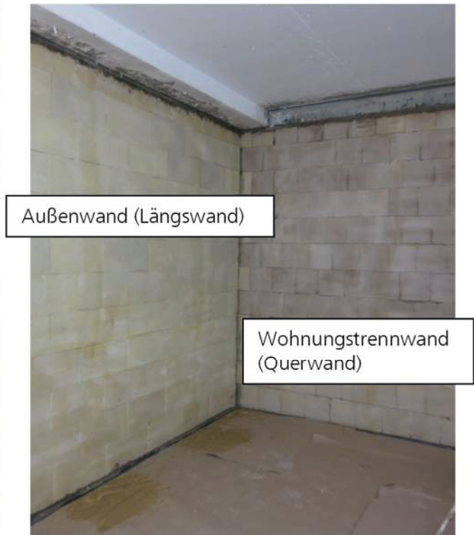
Bild 6: Fotos von der Montage der Längs- und Querwand im Prüfstand.
