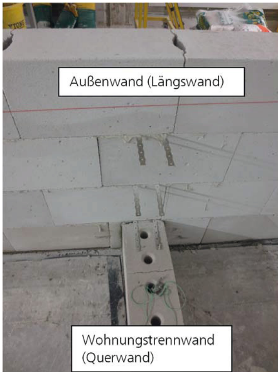
Bild 6: Fotos von der Montage der Längs- und Querwand im Prüfstand.
