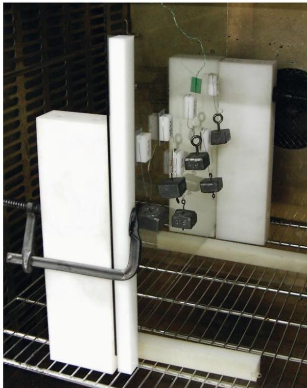
**Abbildung 78: Die Polyethylen-Körper wurden auf das Trägersubstrat geklebt und im Ofen gelagert**
