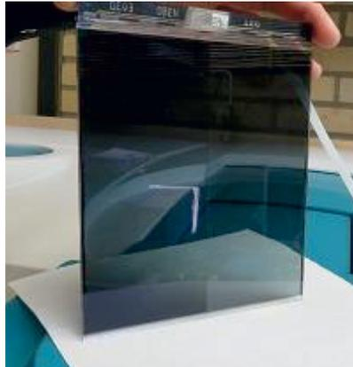
Abbildung 11: Seitlicher Blick auf die TN-Shutter-Zelle
