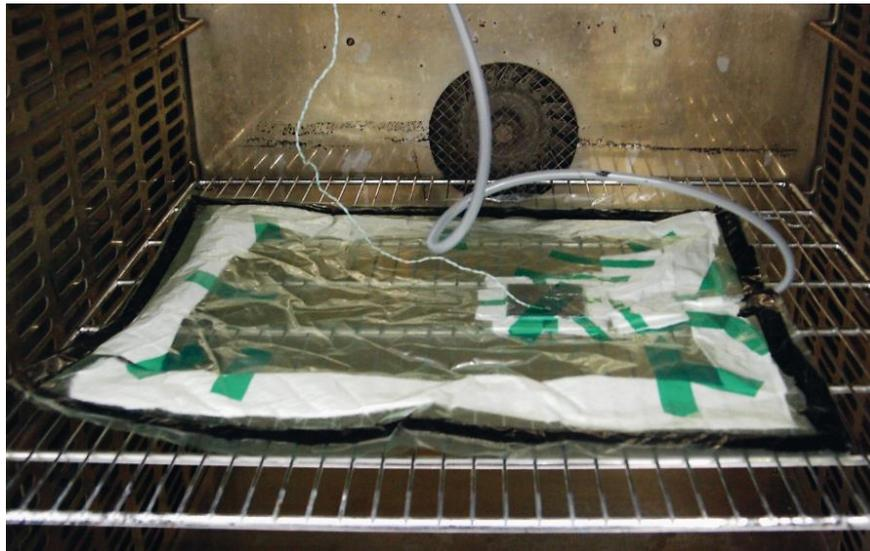
**Abbildung 93: Vakuumverpackung im Ofen - mit Schlauch zur Vakuumpumpe und Kabel des Thermoelements zur Temperaturmessung**
