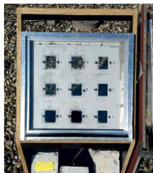
**Abbildung 96: Isolierglasaufbau mit Probenhalteblech**
