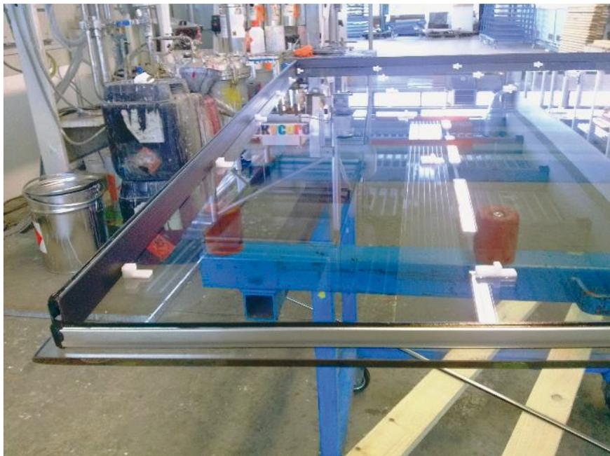
**Abbildung 37:** Randprofil und angeklebte Modulhalter. Richtschnüre sind entfernt. (Foto: W. Haase / ILEK)
