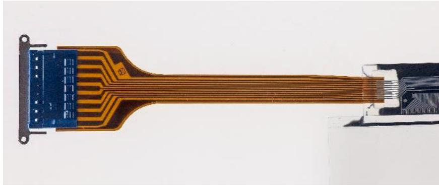
Abbildung 27: Flexkabel mit Stecker der GV66 Module (Foto: G. Metzger / ILEK)
