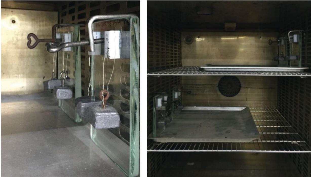
**Abbildung 77: Proben im Heizschrank. Die Polyethylen-Körper sind auf das Trägersubstrat geklebt und mit einer angehängten Masse belastet worden.**
