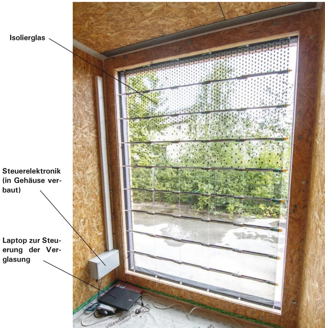
Abbildung 43: Innenansicht der Isolierverglasung mit eingebauten schaltbaren Modulen. Auf die Module wurde eine Grafik mit einem Abdunklungsgradienten übertragen (Foto: J. Rettig / ILEK).
