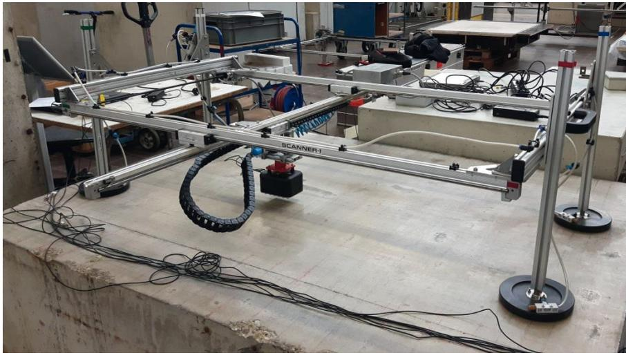
**Abbildung 36: Messung mit Baustellenscanner und erweiterter Messelektronik am FBS 1**
