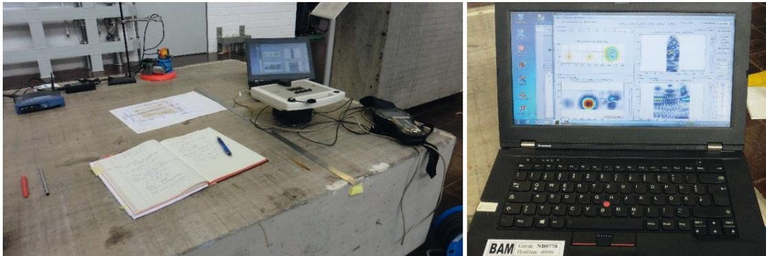
**Abbildung 46: Anordnung der USP Apparatur zur Ortung der Styrodurkugel am FBS1.**
