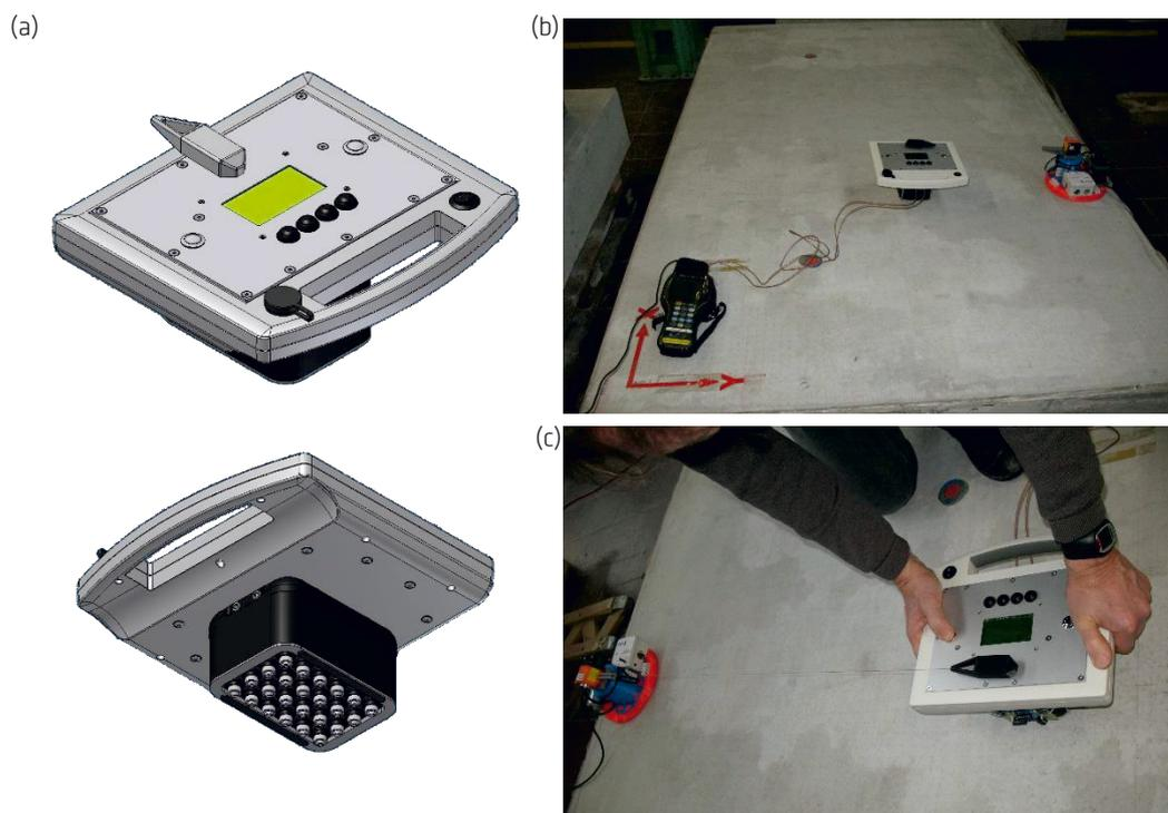
**Abbildung 16: Baustellentauglicher Prüfkopfaufsatz (Neobotix). (a) Konstruktionsansichten, (b) Anwendungstest (UPS-Version 3.3), (c) Detailaufnahme zu Seilaufnahme / -verschluss und Auslösemechanismus**
