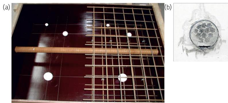
**Abbildung 35: Referenzprobekörpers FB51. (a) vor der Betonage (Betonierseite) (b) Seitenansicht des verpressten Hüllrohres mit Verpressfehlern unten (Ansicht wie bei aktueller Messung von der Schalungsseite) [3]**
