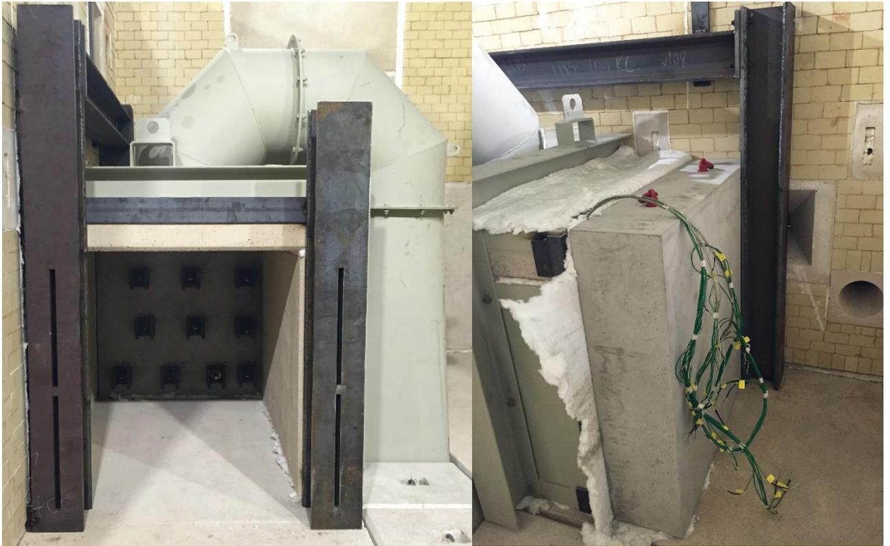
Abbildung 7-25: Versuchsaufbau mit reduziertem Brandraum
