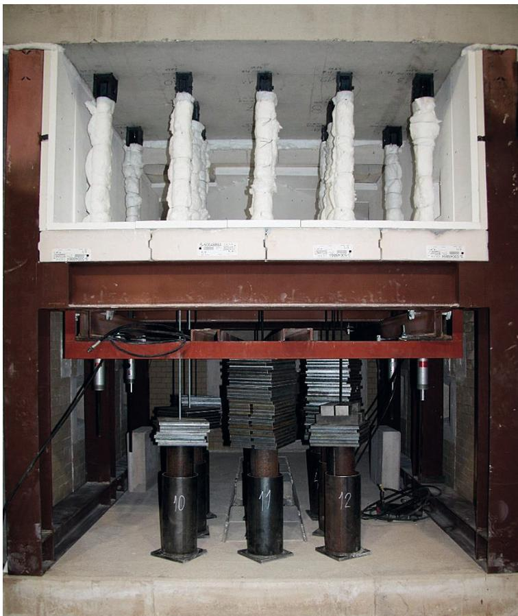
Abbildung 7-26: Versuchsaufbau mit vier Brennern
