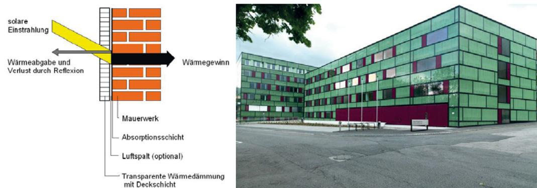
Abbildung 2-40: links: Funktionsskizze Transparente Wärmedämmung [65]; rechts: Gebäude mit transparenter Wärmedämmung [66]
