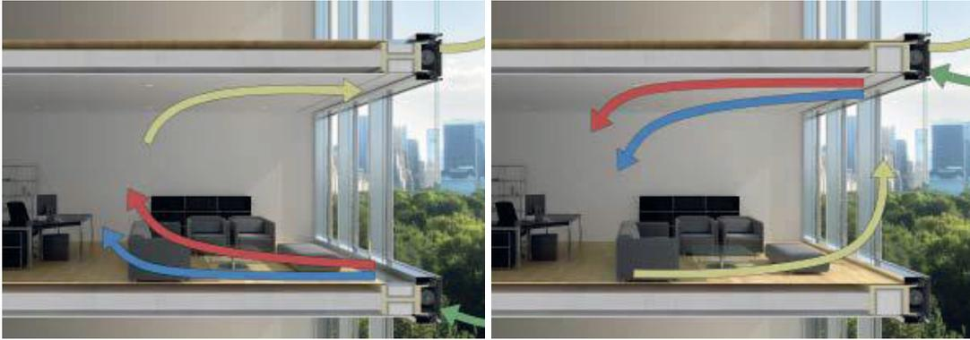
Abbildung 2-36: Zu- und Abluftführung der dezentralen Lüftungsgeräte der E<sup>2</sup>-Fassade, Bilder aus [51]
