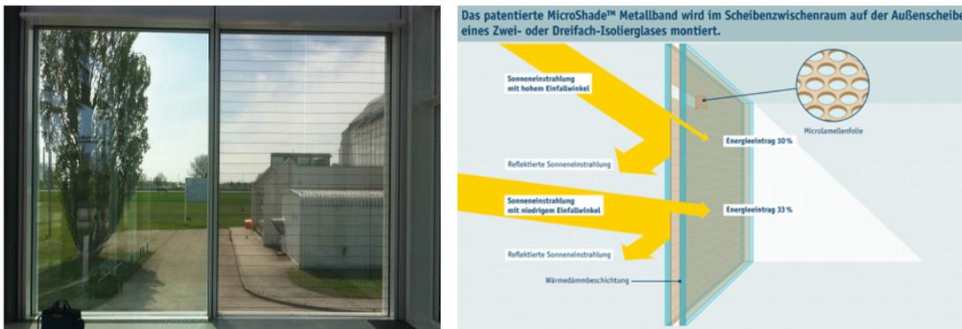
Abbildung 2-13: links: Fenster ohne und mit Microlamellen [28], rechts: Funktionsskizze Microlamelle [29]
