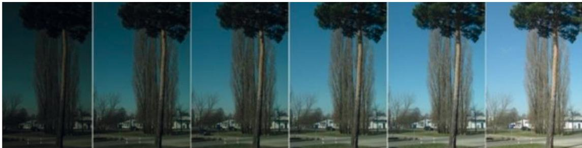
Abbildung 2-4: Schaltvorgang thermochrome Verglasung von Gesimat [10]
