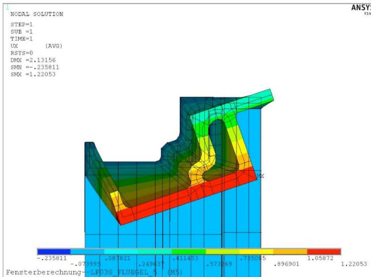
Abb.36 Verschiebung Verformungsfaktor 10 [mm]
