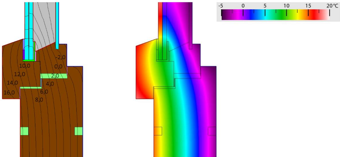
Abb. 4.10 Saniertes Altbaufenster mit Vakuumglas  $U_g = 0,58 \text{ W/m}^2\text{K}$ , Isothermen/IR bei  $\theta_e = -5 \text{ °C}$ .
