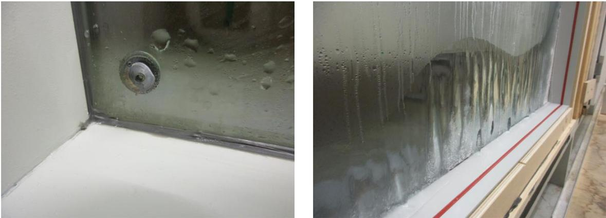
**Abb. 2.15** Beschädigung des Vakuumstutzens (links) und Eisbildung bei Verlust des Vakuums am GFK-Fenster (rechts) bei innen  $23\text{ °C}$  (40% relative Feuchte), außen  $-10\text{ °C}$ .
