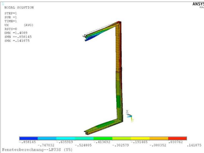
Abb.61 Verschiebung in x-Richtung [mm]
