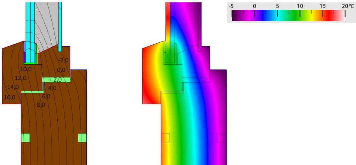
**Abb. 4.11** Saniertes Altbaufenster mit Vakuumglas  $U_g = 0,35 \text{ W/m}^2\text{K}$  Isothermen bei  $\theta_e = -5 \text{ }^\circ\text{C}$ .
