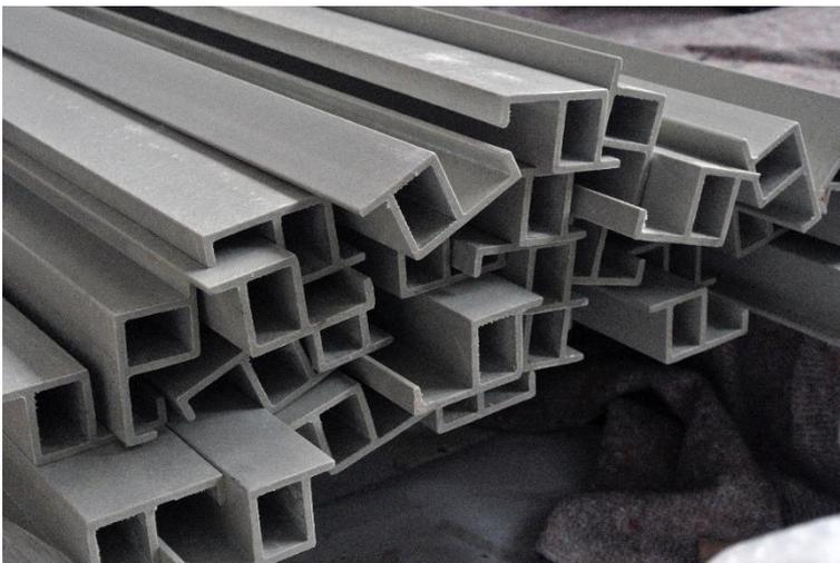
**Abb. 3.21** Pultrudierte GFK-Profile mit der verbesserten Geometrie 3.2.12.1T.
