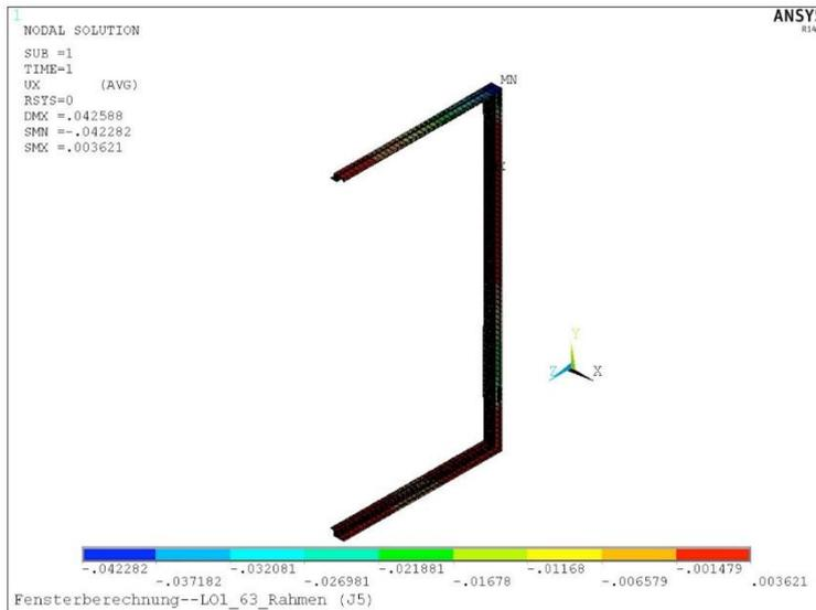
Abb.37 Verschiebung Verformungsfaktor 100 [mm]
