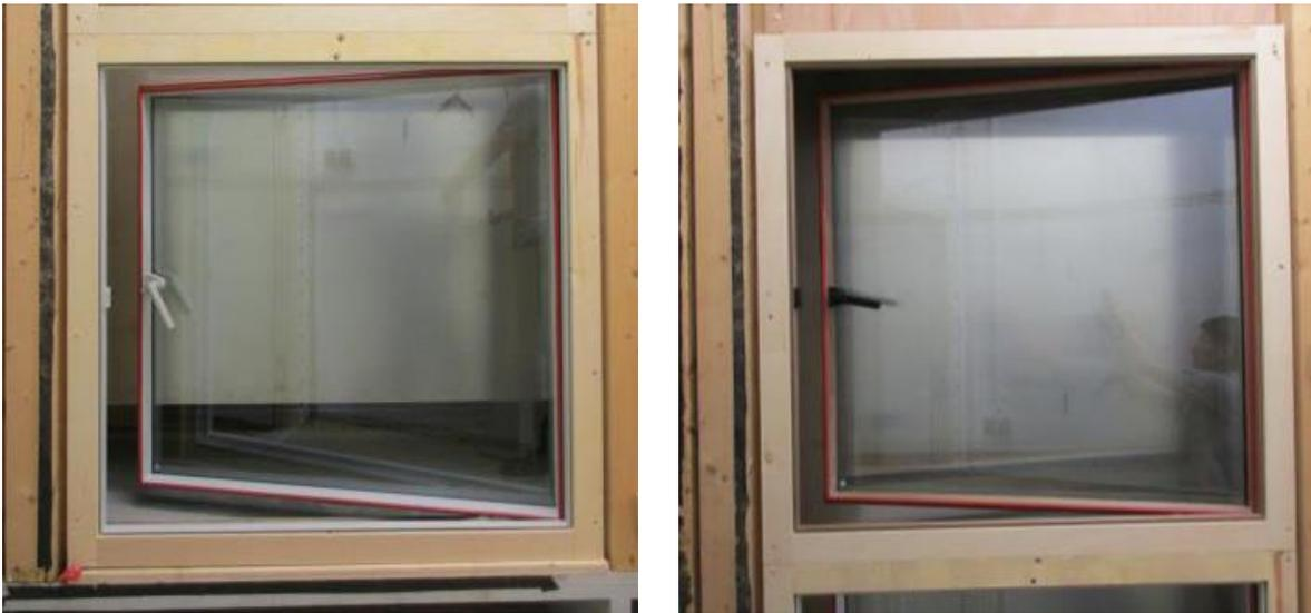
Abb. 2.9 Im Differenzklimastand der Firma Josko installierte Prototypen in GFK (links) und Holz (rechts).
