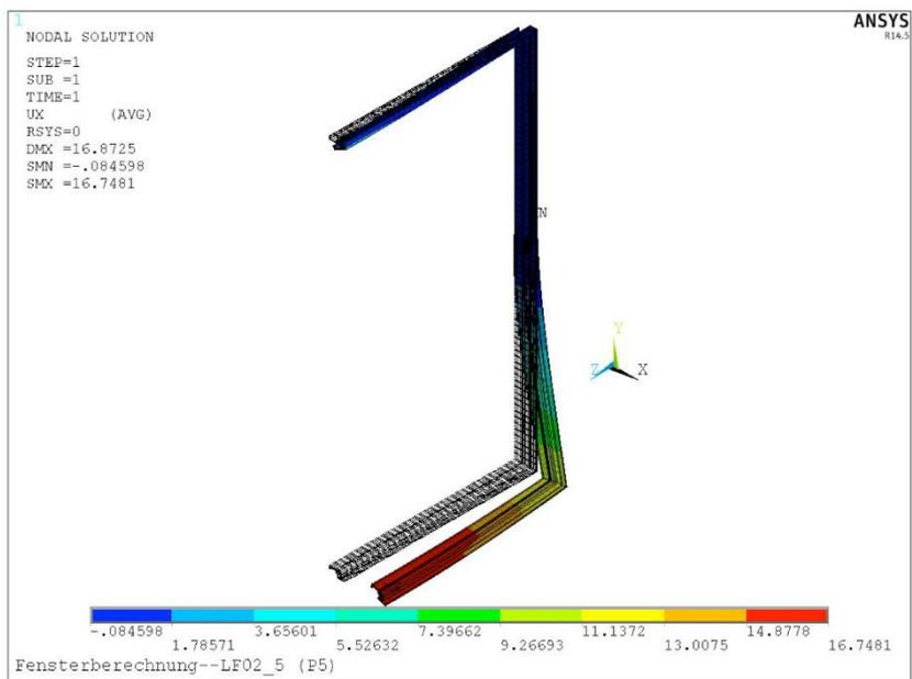
Abb.28 Verschiebung in x-Richtung [mm]
