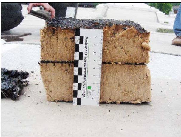
Bild 11 Öffnungsstelle in der Fläche mit stark durchfeuchteten PUR-Dämmstoffen
