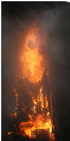
a: Putz öffnet sich großflächig in der 15. Prüfminute
