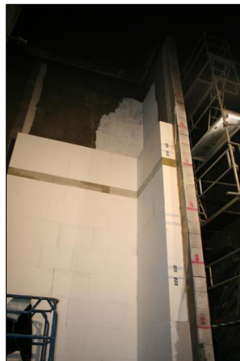
b) 300 mm EPS-Dämmung und ein Brandriegel
