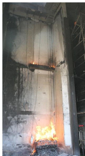
b: Blick auf Prüfkonstruktion nach 27 Prüfminuten
