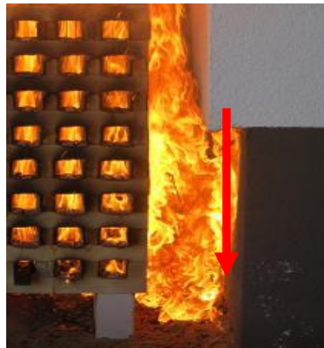
Abbildung 6: Austritt und Entzündung der EPS-Schmelze in der 10. Prüfminute
