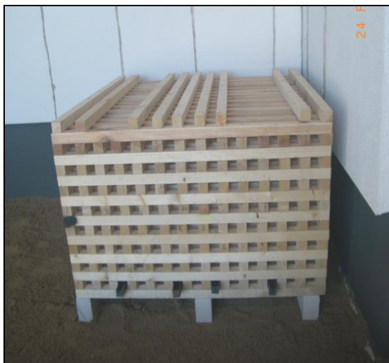
Abbildung 3: Aufbau 200 kg Holzkrippe
