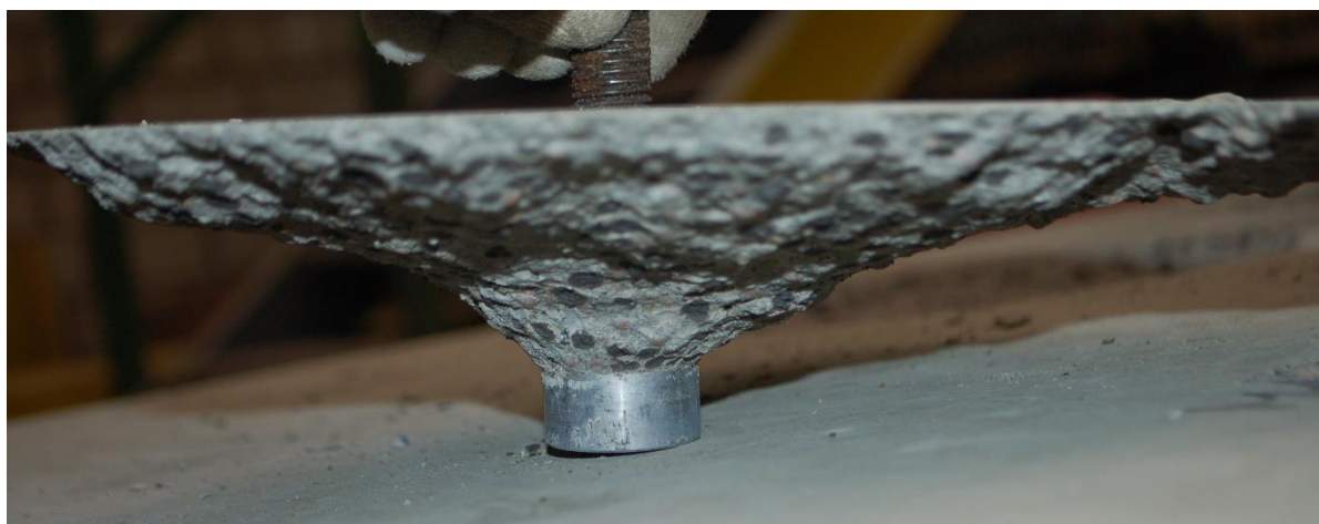
Abbildung 9 Ausbruchkegel im festeren Leichtbeton LC 40/44 – d16x50 – 1
