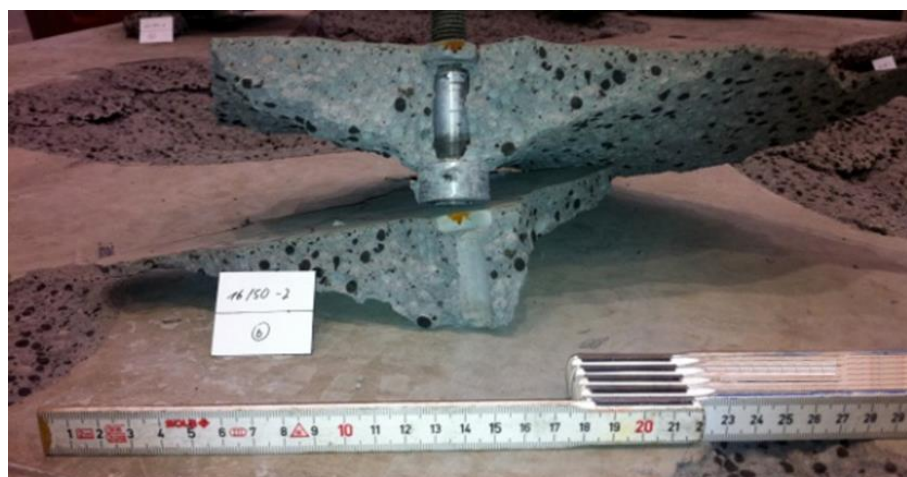
Abbildung 12 Fehlender Kompressionsbereich im A 3 Test – d16x50 – 2
