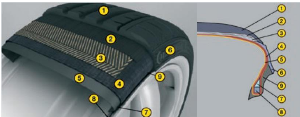
Abbildung 1: Aufbau eines PKW-Reifens [22]
