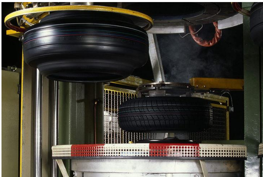
Abbildung 2: Backen eines Reifenrohlings [55]
