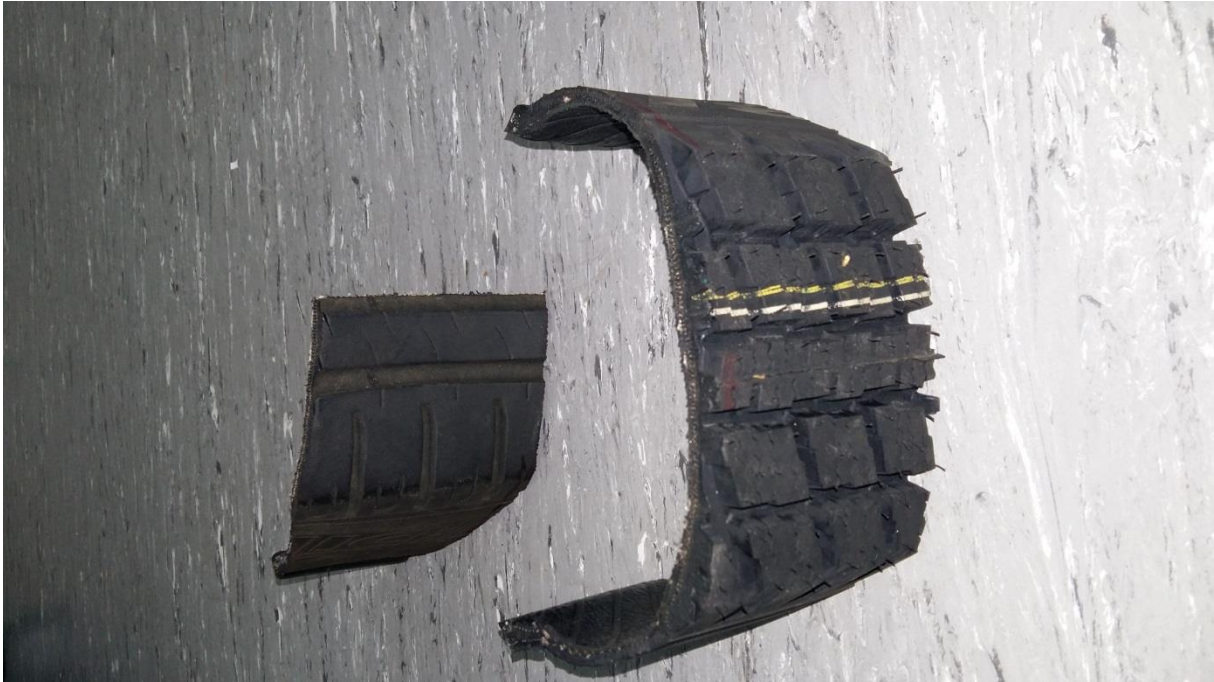
Abbildung 14 Vergleich von Alt- (l.) und Neureifenprobe (r.)
