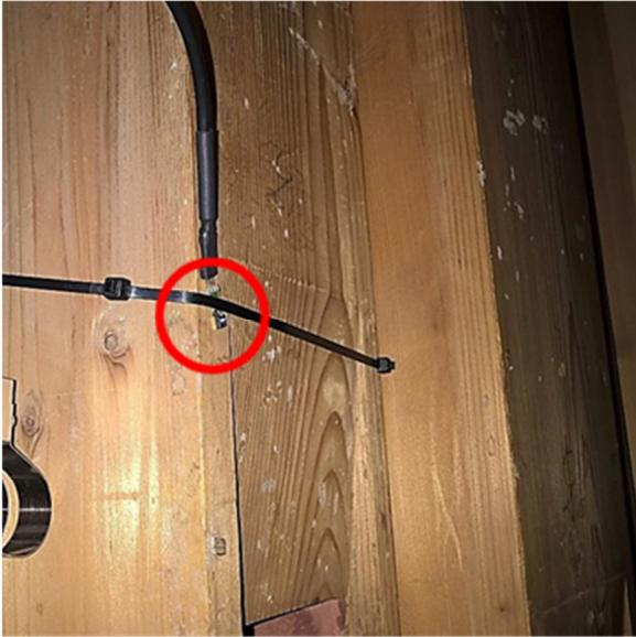
Abb. 11 Nahfeldklimasensor zur Erfassung von Klimadaten an Oberflächen
