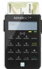
**Abbildung 45:** RFID-Lesegerät ReinerSCT Standard für nPA [79]
