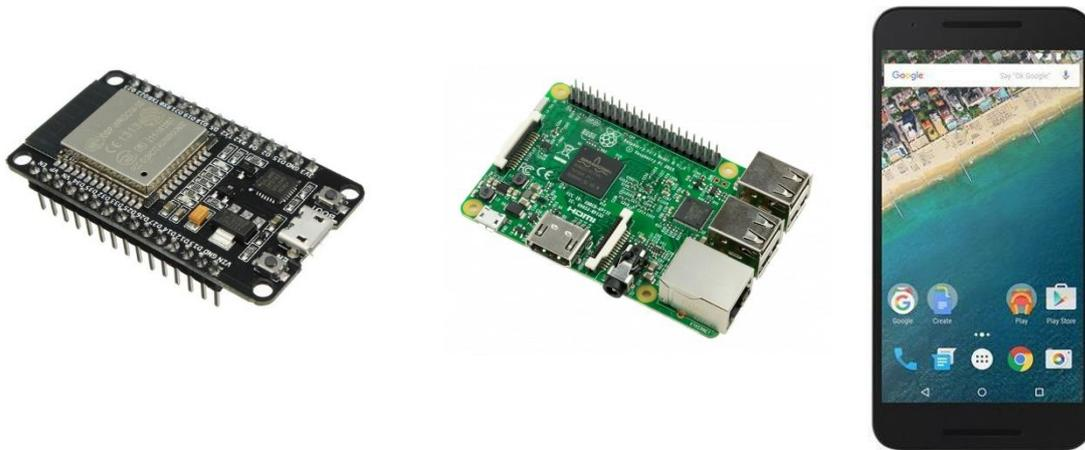
**Abbildung 44:** In den Demonstrationsszenarien verwendete Geräte: ESP32, Raspberry Pi, Android Smartphone
