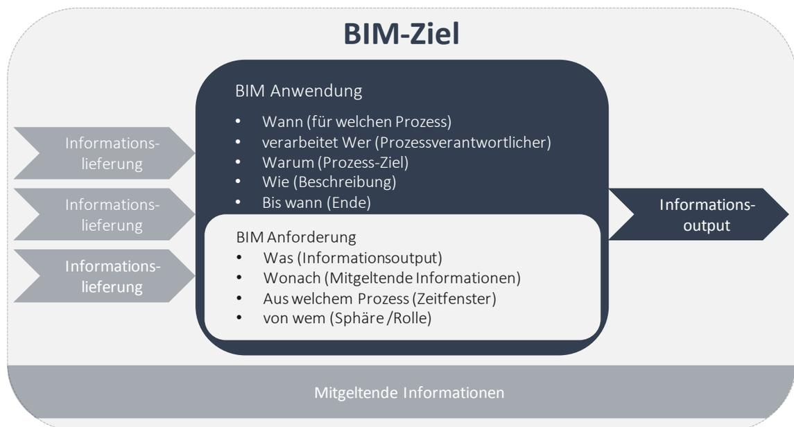
Abbildung 8: BIM-Prozessinhalt – BIM-Ziel, -Anwendung und –Anforderung
