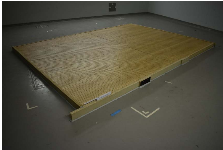
Bild 41: Messaufbau der Prallwand HARO Protect Classic Sperrholz im Hallraum
