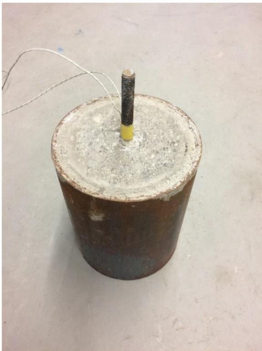
Abbildung 7-4: Versuchskörper für „fire test“ nach [5] an Befestigung im Leichtbetonstein
