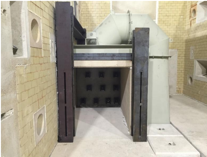
Abbildung 6-2: Versuchsaufbau (ohne Lasteinleitung)
