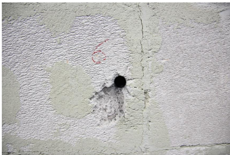
Abbildung 7-3: gemischtes Versagen, Brand 14-6 M16-100-3kN-Porenbeton, Versagen nach 43 min
