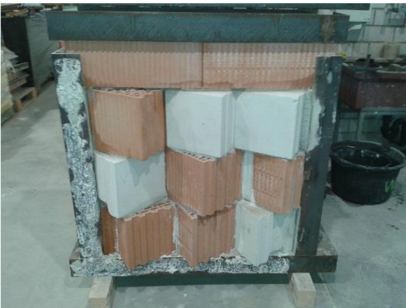
Abbildung 6-7: Versuchswand für Schrägzugversuch
