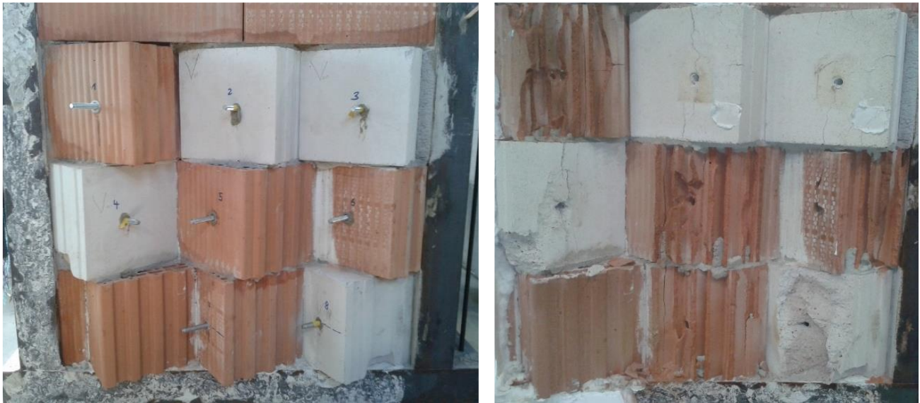
Abbildung 7-27: links: Versuchswand vor Versuchsbeginn; rechts: Versuchswand nach Versuchsende
