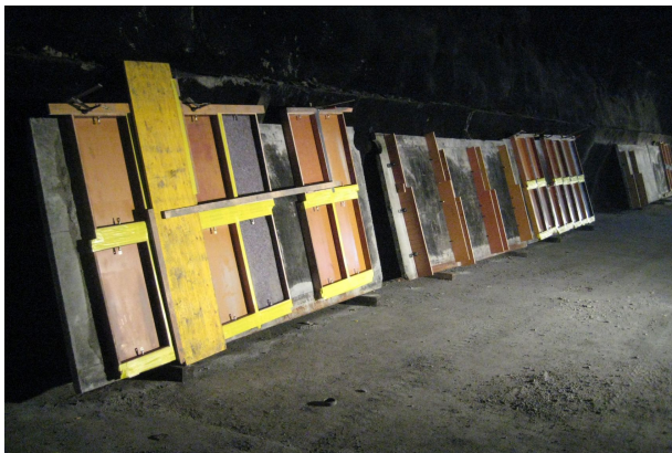
(a) Anordnung der Schalungen für Verbundplatten, Schwindplatten und der monolithischen Platten
