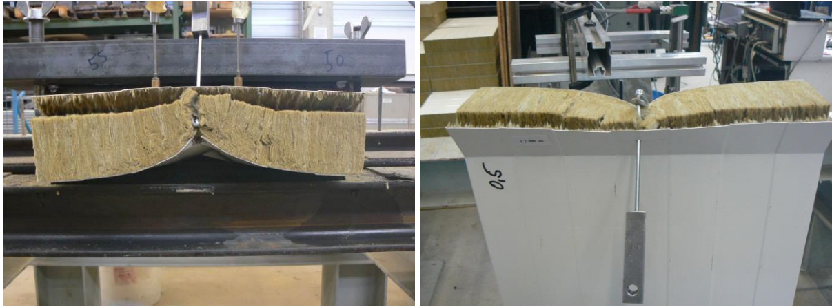
Bild 7.17: Ablösung des unbelasteten Deckblechs bei großen Verformungen
