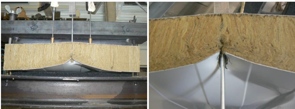
Bild 7.16: Durchknöpfen am Elementrand
