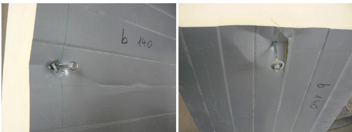
Bild 7.74: Kerbenbildung (links), Rissbildung während zyklischer Belastung (rechts), e = 40 mm
