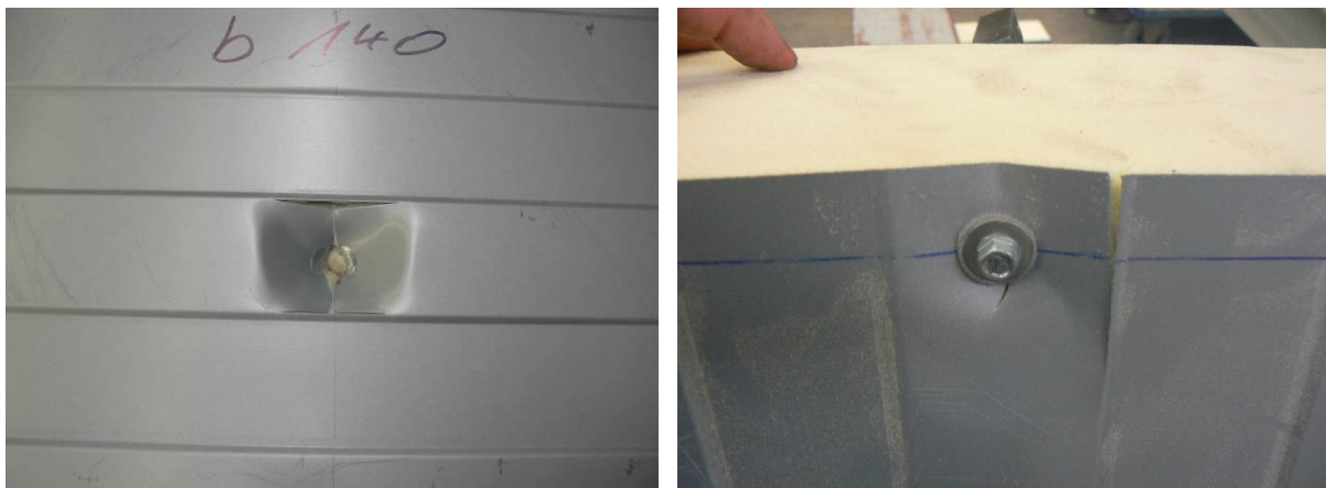
Bild 8.5: Versagen am Mittel- und Endaufleger nach dem Auszugversuch
