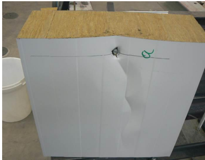
Bild 7.37: Versagen des Elements bei einem Randabstand von 40 mm
