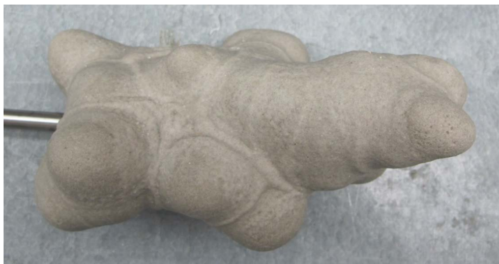
Bild 44: Probekörper, der bei der Injektion von Harz A mit der kurzen Mischkammer im November 2015 entstand.
